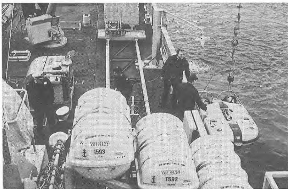
Personel på LAXEN demonstrerer undervandsdrone, der bl.a. er i stand til at finde udlagte miner på havbunden. Undervandsdronen er udstyret med TV-kamera, som videresender optagelserne til moderskibet.
