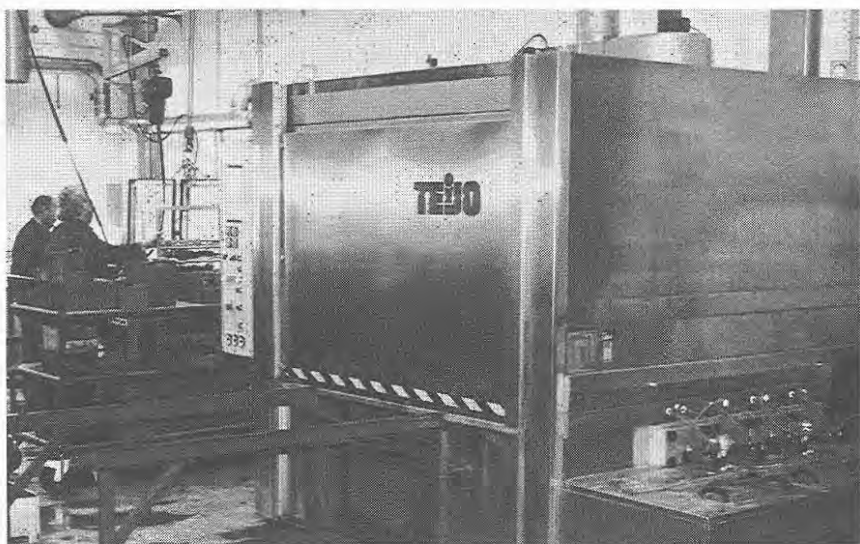
Som første led i renseriprocessen bruges en fuldautomatisk vaskemaskine, som kan vaske dele på 2 tons i en proces på flere programmer og til sidst konservere delene.
