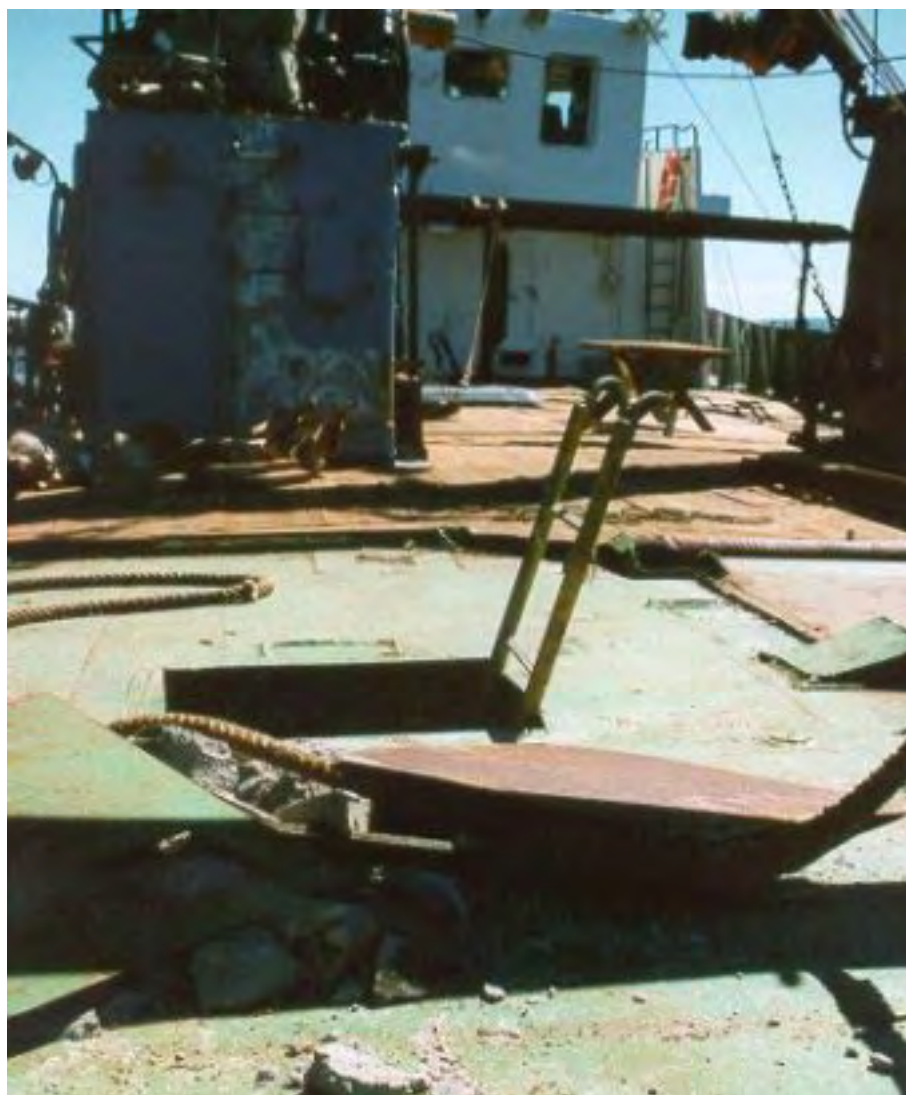
Der blev fundet 12 tons hash i et rum, der normalt blev anvendt til fiskenet. Adgangsvejen - en luge i dækket - var først dækket med en jernplade, derefter med ca. 20 cm beton, og øverst var der påsvejset en jernplade.
