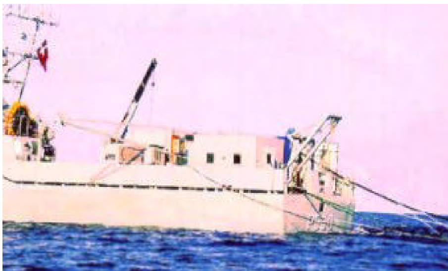
Til opmåling af havbundens øverste lag slæber FLYVEFISKEN luftkanon, Sidescan sonar, X-STAR sonar samt et 400 m langt hydrofonkabel.
