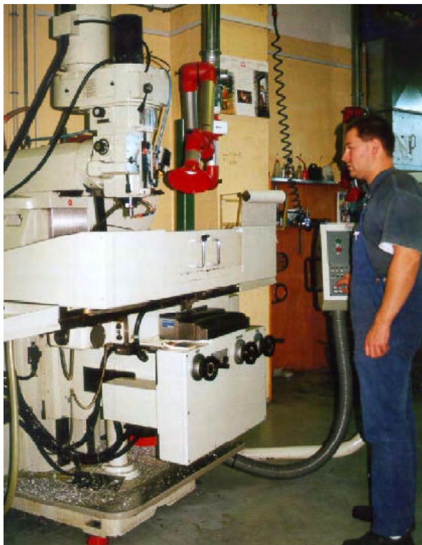
I Værkstedesvedligeholdelseelementet benyttes CNC-fræsemaskinen til nyfremstilling.
