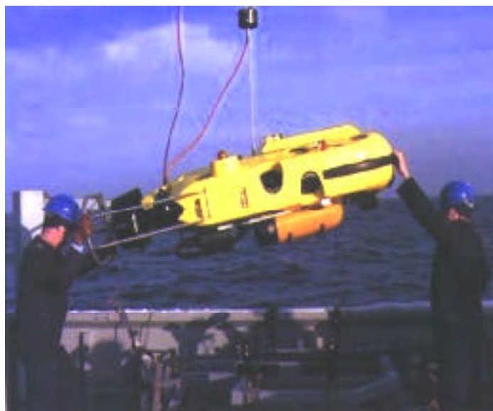
SUTEC undervandsdrone med DAMDIC mineuskadeliggørelsesladning.
