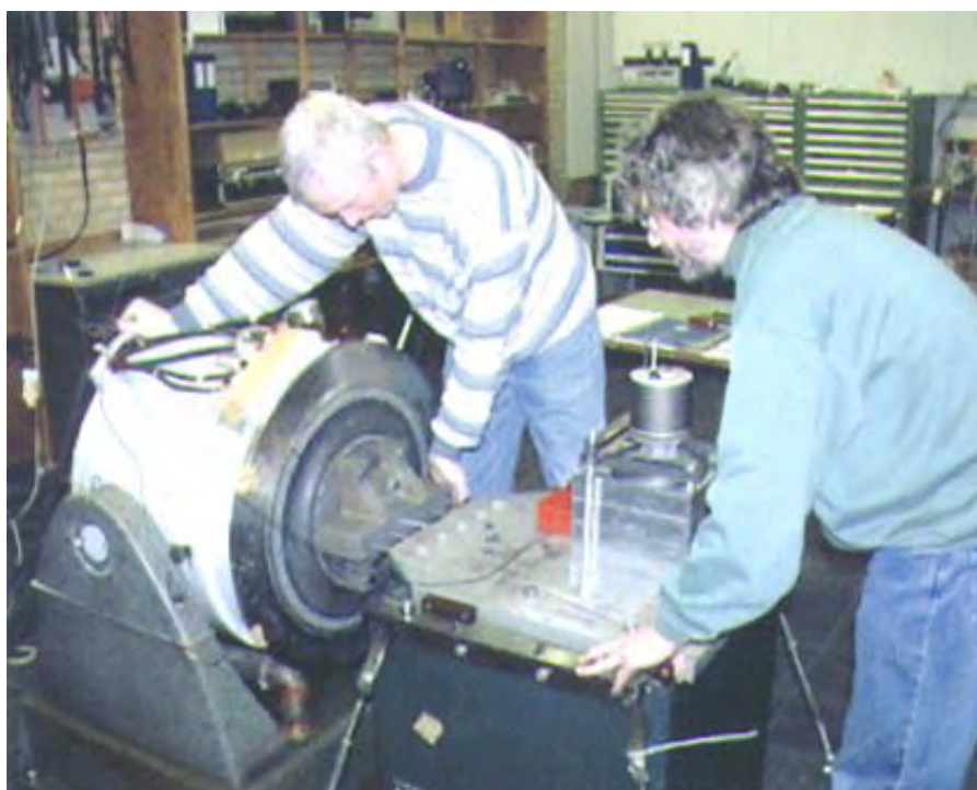
Der bliver skiftet retning på shakeren til vibrationsafprøvning. Fra venstre elektronikmekaniker Jan Larsen, Hærens Materielkommando, og elektronikmekaniker Tage Vegenveldt, Minekomponentværkstedet.
