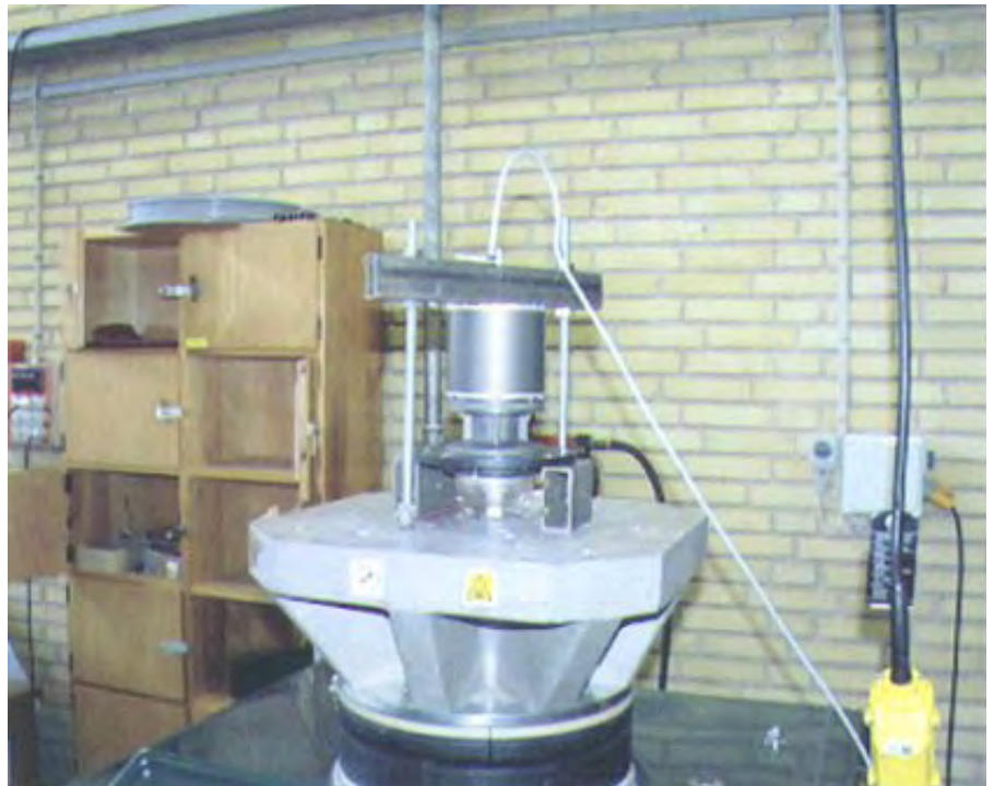
Her udsættes det dansk udviklede Clock Delay MK 12-E for chocktests i 3 retninger.
