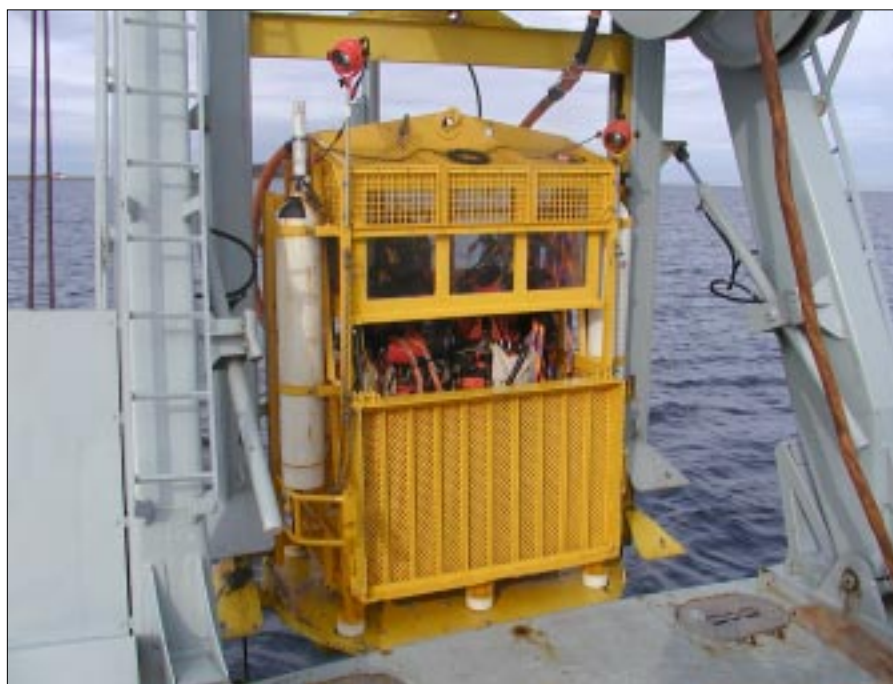
Et to tons tungt spil med styresystem sikrer transport af klokke mellem overflade og havbund.
