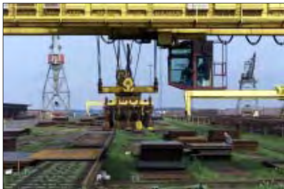
Der passerer fra 10-12.000 tons stål om måneden. Plader og profiler rustbeskyttes, før de ruller ind i skibsbyggeriet.
