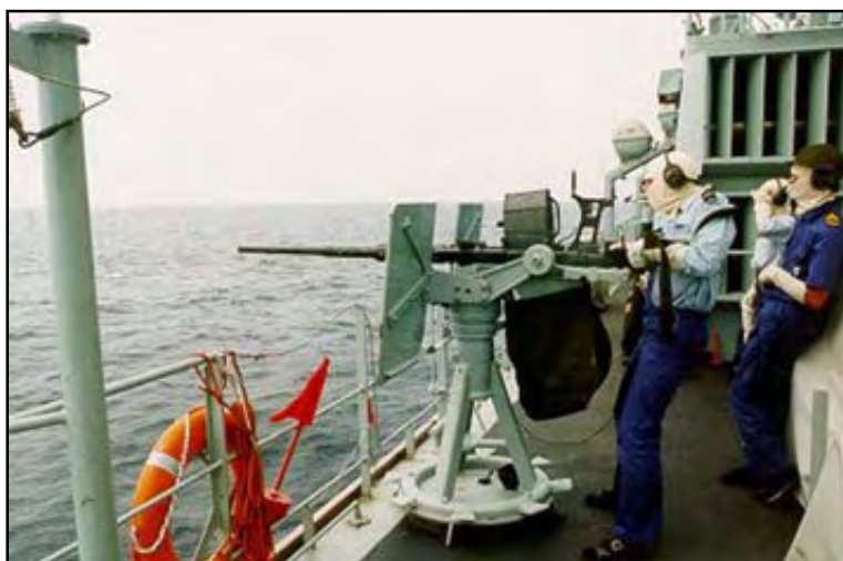
På handlebanen skydes også med Oerlikon 20 mm kanon. Kanonen kan skyde 600 skud i min. og har en rækkevidde på 1500 m.
