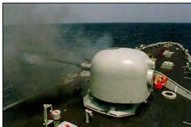
Der skydes med OTO Melara 76 mm kanon. Kanonen kan skyde 85 skud i min. og har en rækkevidde på 16 km mod sømål og 12 km mod luftmål.
