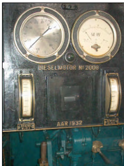
Motor No. 2000 var for sin tid verdens største og samtidig et udtryk for B&W's status med det store antal producerede antal motorer i 1932.
