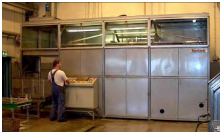
Maskinen kører fuldautomatisk og benytter sig af tre kar, hver på ca. 800 liter.
