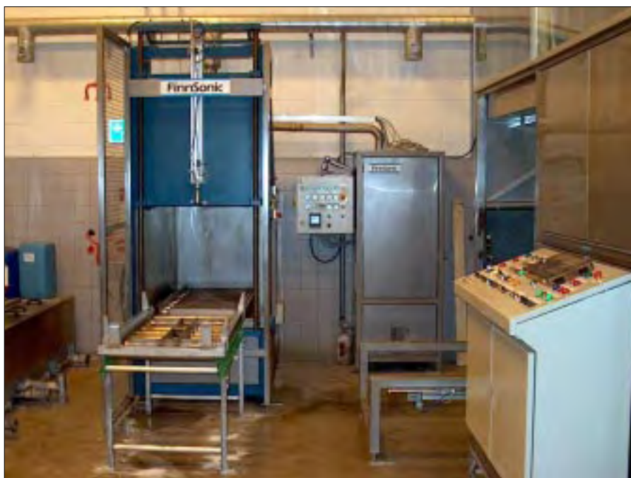
Når det vaskede emne kommer ud af ultralydsmaskinen, er det vådt og tørres i denne vakuumtøringsovn,
