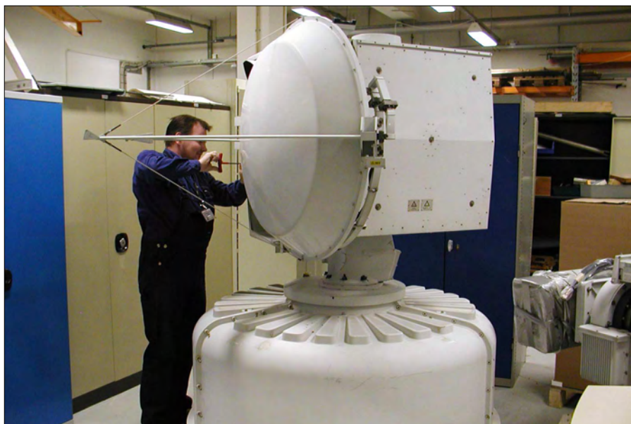
Mekaniker Jan Thode er i færd med at samle et Flexfire radarsigte.
