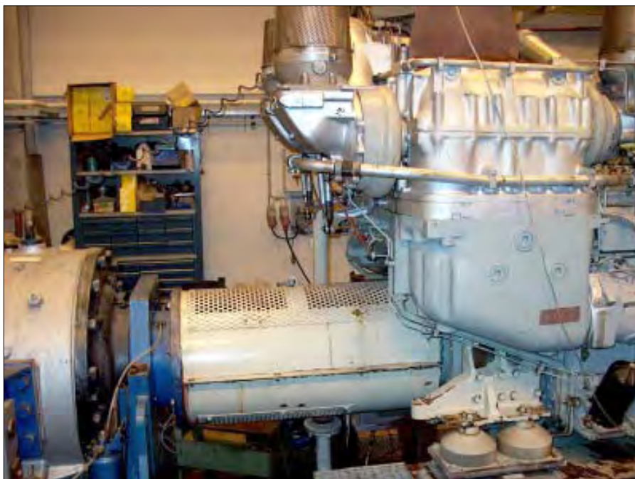
Effekt overførelse fra motor til vandbremse 2040 kw ved 1940 omdr/min.
