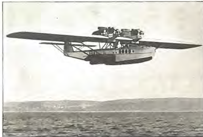
Dornier Superwal med fire 500 HK. Motorer.
