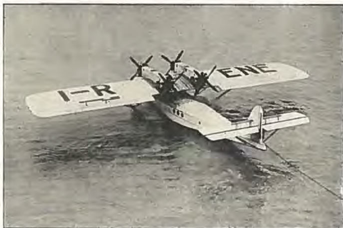
Dornier Superwal med 4 Jupiter-Motorer paa ialt 2000 H. K.
