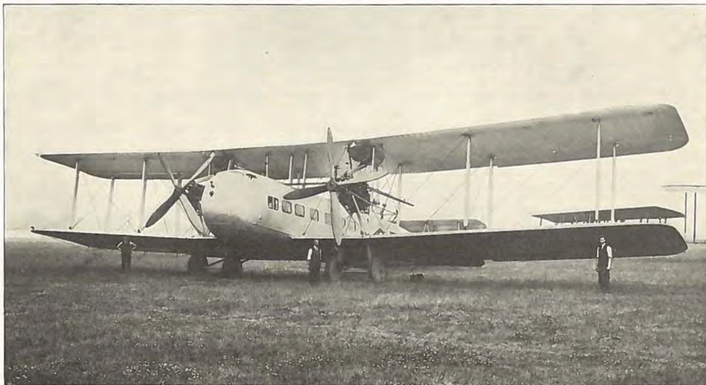
Vickers „VANGUARD“, forsynet med to 650 HK Rolls Royce „Condor“ Motorer. Foruden Fører og Navigator har Maskinen Plads til 23 Passagerer, og anvendes bl. a. som Troppetransportmaskine ved de engelske Luftstyrker i Irak.
