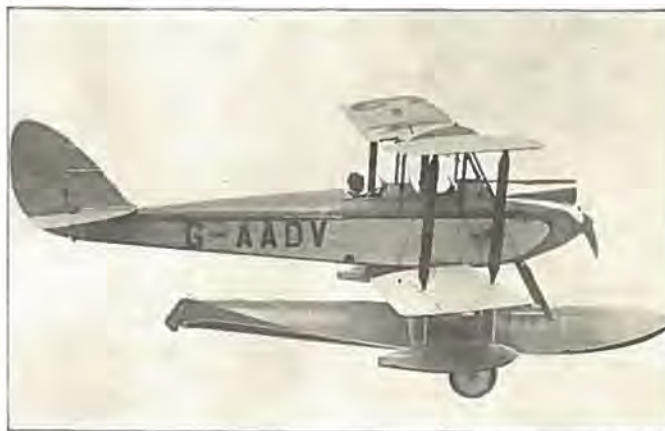
Den kendte Moth-Sportsflyvemaskine kan ogsaa leveres som Amfibie-maskine, d. v. s. med Understel til Landing baade paa Vandet og paa Landjorden.
