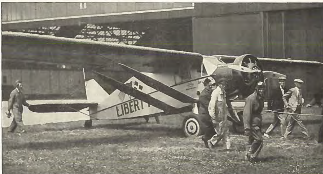
Bellanca-Monoplanet. Bærepplanernes Spændvidde er 14,7 m. Kroppens Længde 8,72 m. Motor 300 HK. Wright Whirlwind.
