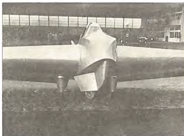
Understellet består af 3 Hjul, hvoraf det forreste er drejeligt.
