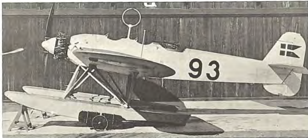
H. M. II-Type, bygget paa O. V. i 1929 efter Licens fra Heinkel Flugzeugwerke. (400 H. K. Armstrong Siddeley Motor.)
