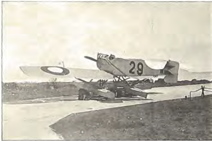
Ponton-Søluftfartøj af H. M. I-Typen (Brandenburg Monoplan), bygget paa Orlogsværftet 1921.
