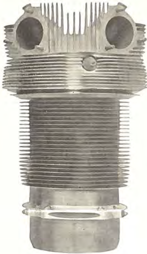
Den nye Cylinder, der viser det øgede Ribbeareal.
