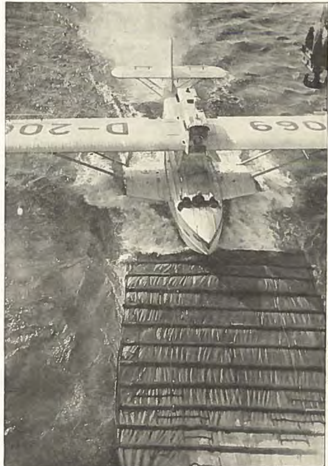
Dampere „Westfalen“s Slæbesejl, hvorpaa Flyvebaaden løber op, inden den bliver taget ombord. Slæbesejlet dæmper til en vis Grad Bølgebevægelsen, og derved lettes Optagningen betydeligt.
