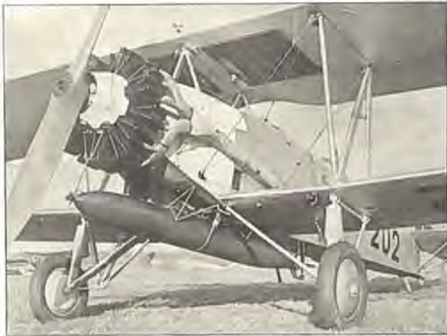
Torpedoen er ophængt under Fuselagen.
