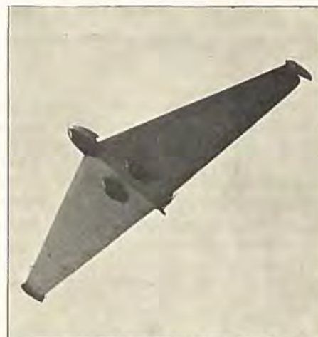
Den tyske, haleløse, trekantede Flyvemaskine, der er konstrueret af Lippisch. Den kaldes populært „Den flyvende Trekant“
