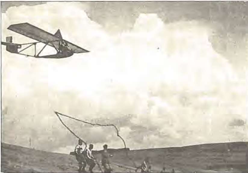
Ovenstaaende Billede viser en typisk Start med Gummitov. Paa Billedet til højre ses en af Vordingborggruppens Medlemmer i Luften med deres nybyggede Skoleplan.
