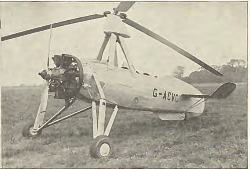
Typen C 30 har en 140 H.K. Siddeley „Genet Major“ Motor.
