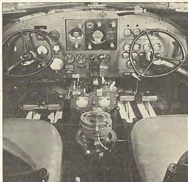
Førerrummet i K.L.M.s Douglas. Kassen med Sperry's Kontrolanordning ses øverst i Billedet.
