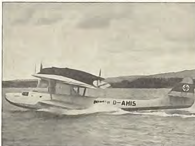
Ny Dornier Flyvebaad til Trafikken over Sydatlanten. Den er udstyret med to Junkers Dieselmotorer.
