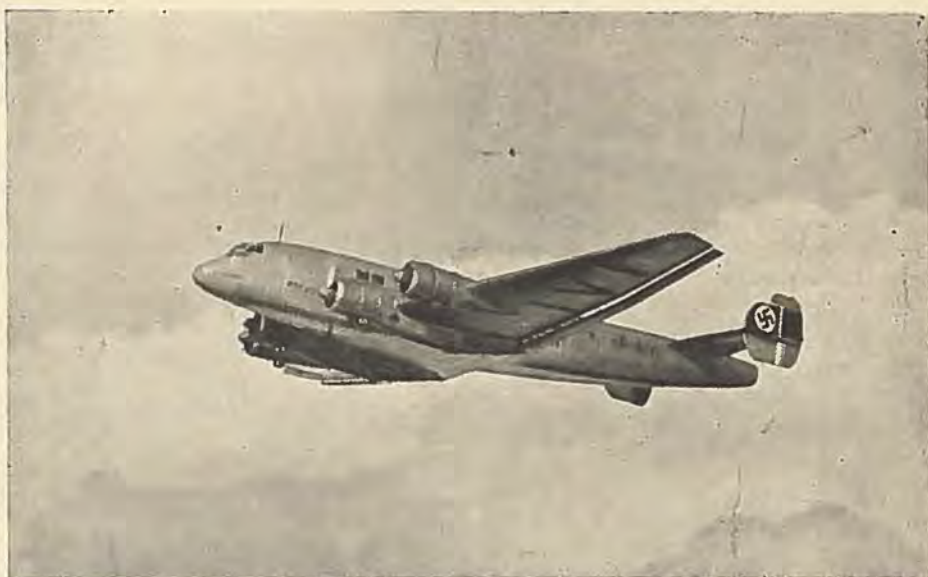
Junkers »Ju 90«, der gik op i 7242 m Højde med 10.000 kg Nyttelast.
