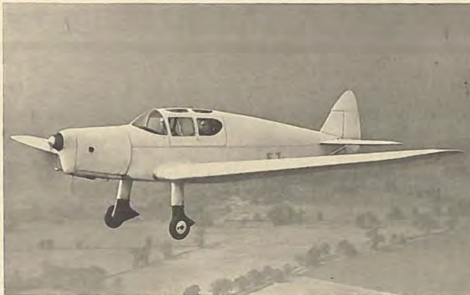
Moth Minor. Saavel den lukkede som den aabne Maskine har sammenfoldelige Vinger.
