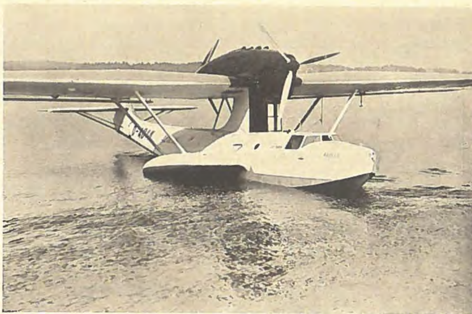
Dornier Do 18, der er udstyret med 2 Junkers Jumo 205 Dieselmotorer.
