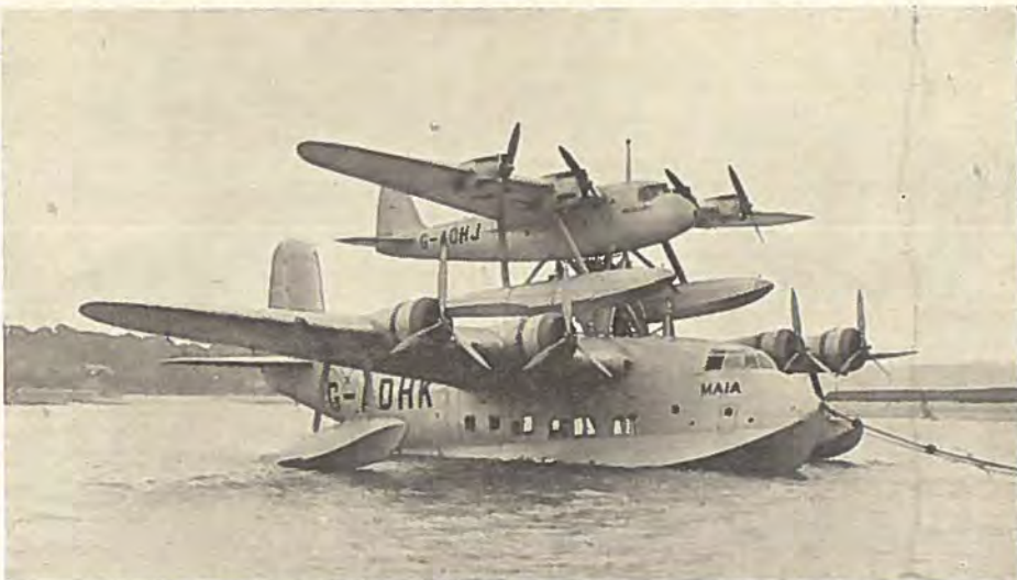
Den øverste Maskine er »Mercury«, der af »Maia« løftes op i 2000 Meters Højde for derefter at frigøres.
