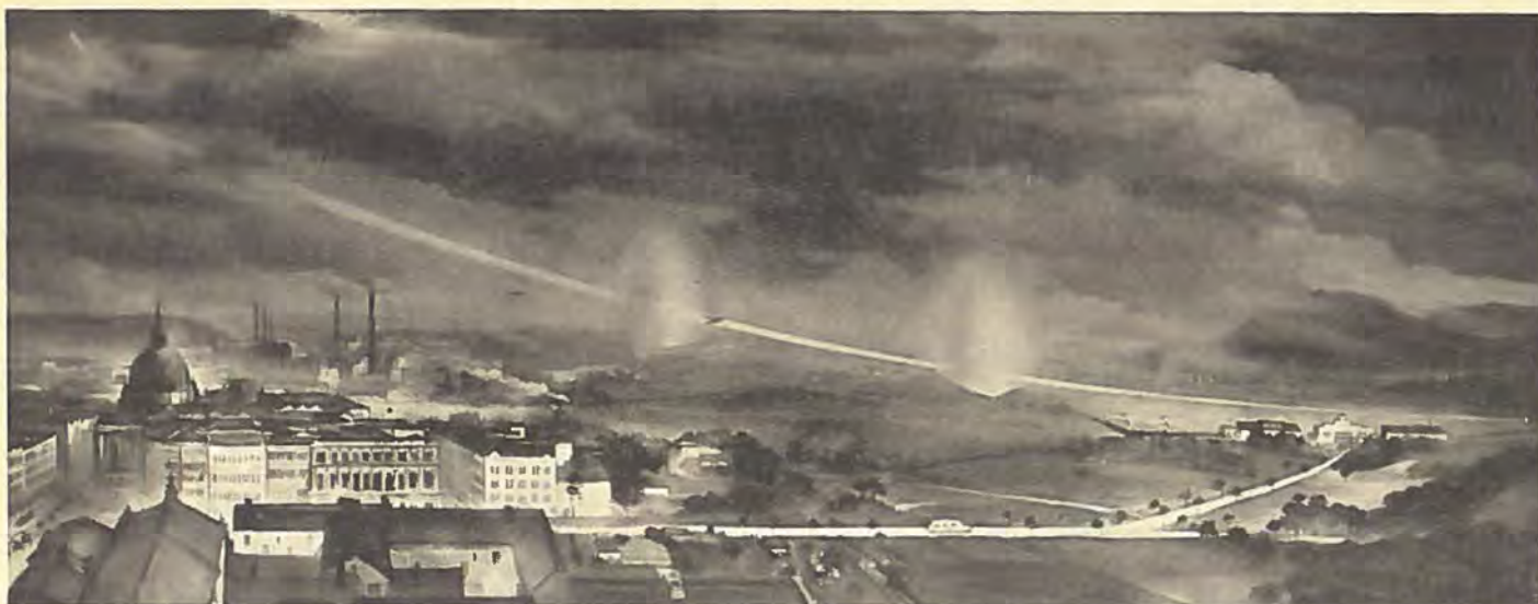
Billedet illustrerer Telefunkens Baakelandings-System. Den lange lyse Stribe angiver Baakesenderens Ledetone. Forsignalet (længst tilvenstre) og Hovedsignalet underretter Flyveren om Afstanden fra Lufthavnen.
