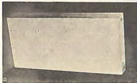
1) Bjælke af Koldlim-Krydsfinér limet under Tryk med Koldlim.
