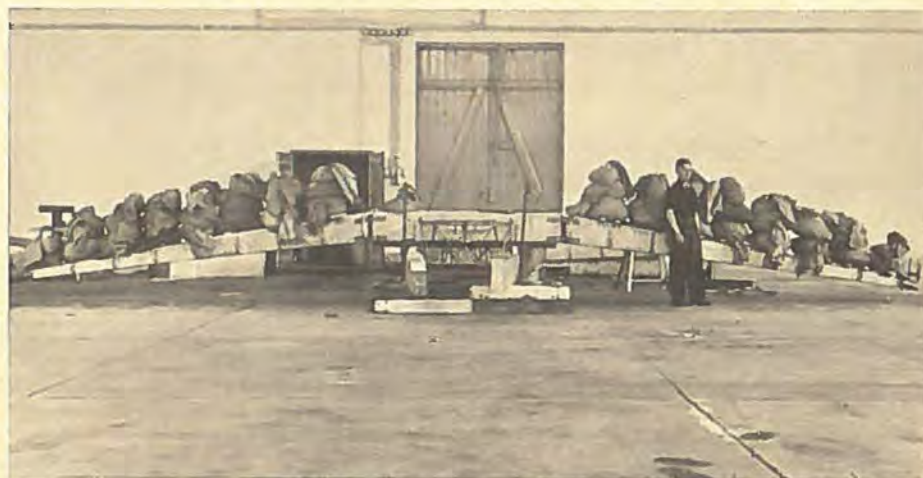
K Z II Bæreplan under Belastningsprøve.
