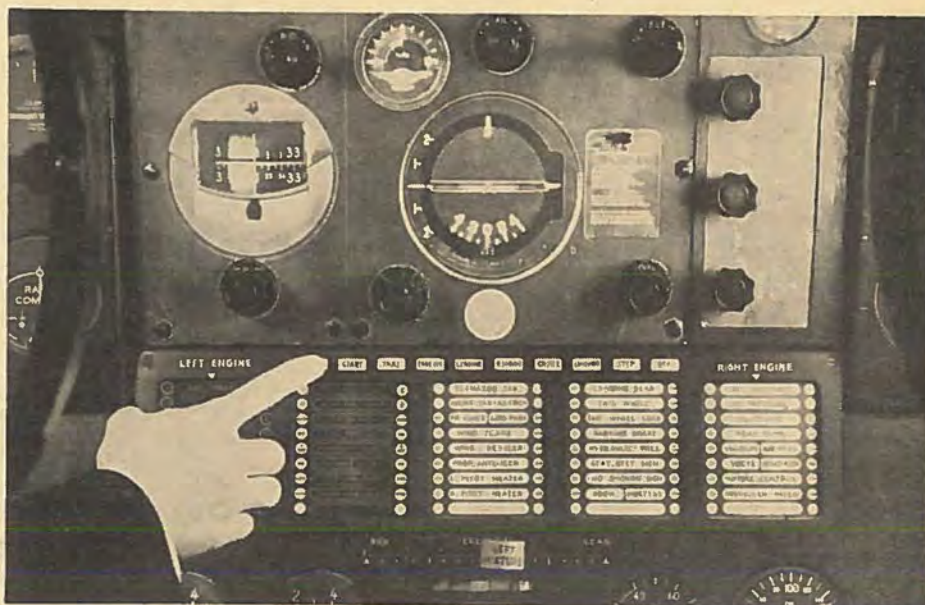
»Sladre-Instrumentbrædtet«, hvis System af lysende Tavler viser, hvilke Instrumenter og Haandtag Flyveren skal betjene ved Start, Landing o. s. v.
