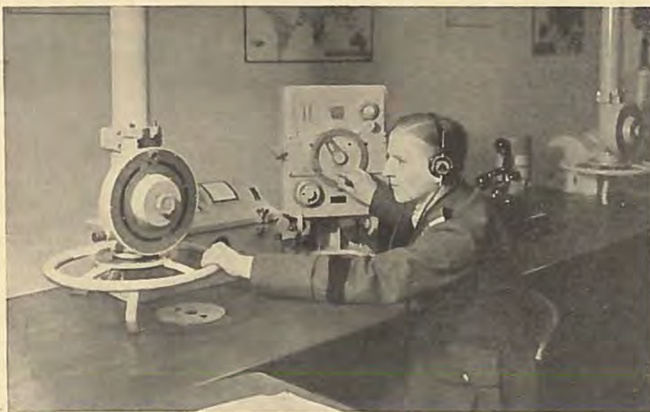
En Telefonken-Pejler i Virksomhed paa en Lufthavns Radiostation.
