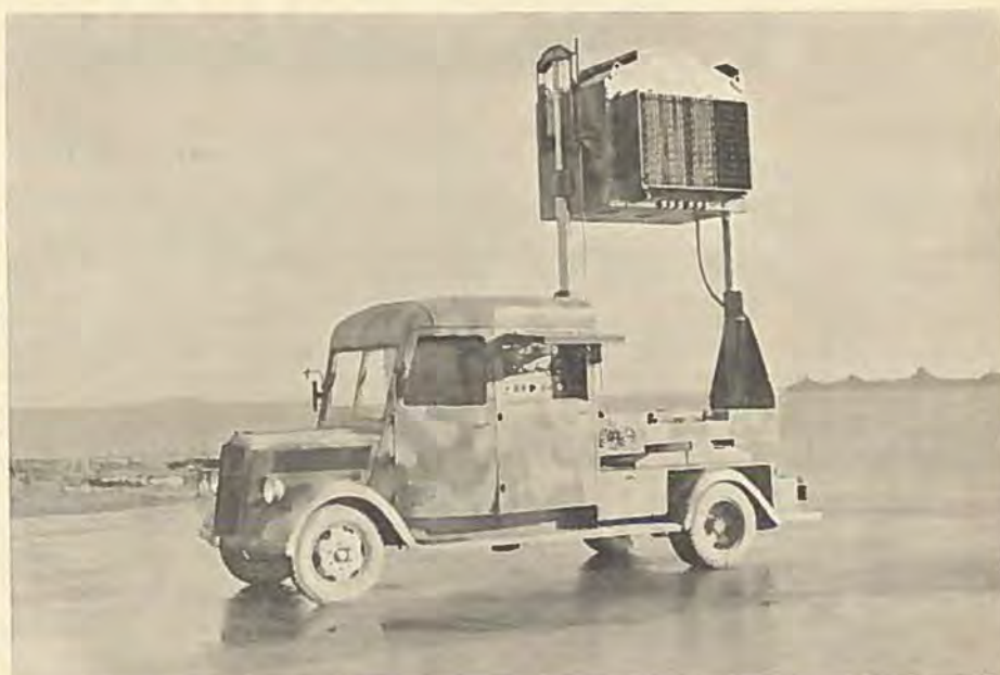
Marinens Flyvevæsens mobile Natlandingsanlæg. Lyskasteren kan hæves ad elektrisk Vej indtil 4 m over Landingsarealet.
