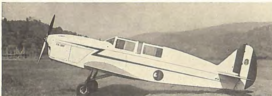
F. N. 305. En-Motors Jagerlype, lavvinget Monoplan, den fremstilles enten som eensædet åben Maskine eller to-sædet lukket. Motoren er en Alfa Romeo 115-I, seks-cylindret luftkølet paa 200 H.K. Maskinens Netlovægt er 700 kg og der kan transporteres en Nyttelast paa 280 kg. Maximalhastigheden er 310 km/T.
