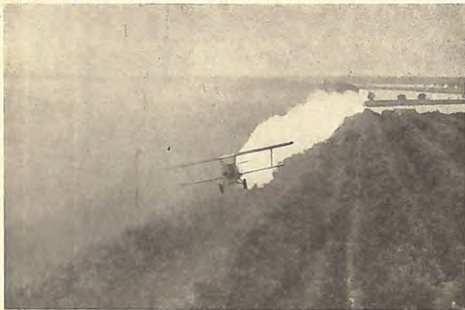
Flyvemaskinen udlægger Sprøjtlevædske over Frugttræerne.
