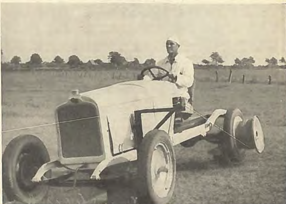
Motorspil med Wiretromle paa Baghjulet.
