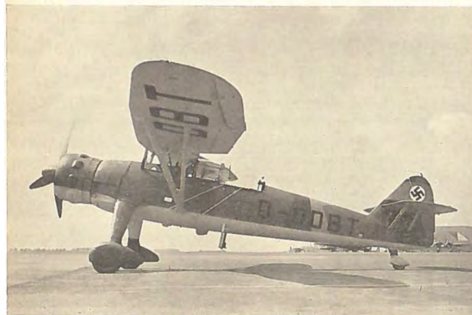
HENSCHEL HS 126. Tosædet Maskine til Nærrekognoscering og Samarbejde med Hæren. Een 880 HK BMW Stjernemotor. 1 fast og 1 à 2 bevægelige Mg. Kan medføre 10 Bomber à 10 kg. Største Hastighed 370 km/T.
