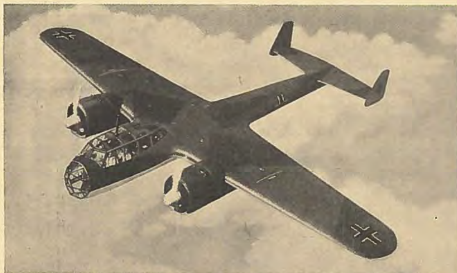
DORNIER DO 215. Mellemtung Bombemaskine. Besætning 4 Mand. 1 bevægeligt Mg. i Næsen, 1 Mg. ovenpaa Kroppen til Skydning bagud og 1 Mg. under Kroppen. To Motorer, enten BMW Stjernemotor eller Daimler Benz vandkølede Motorer. Lastevne 2181 kg; største Rækkevidde 2970 km; største Hastighed over 500 km/T.
