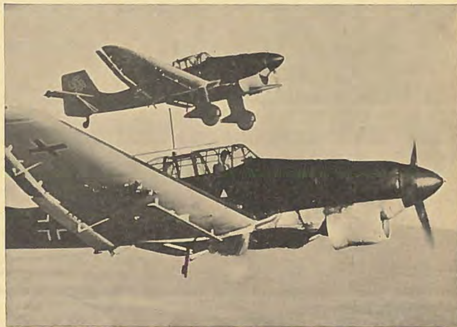
En Junkers Ju 87, der under en Fejlmanøvre har faaet begge Understelshjul revet af; alligevel lykkedes det at flyve Maskinen hjem.
