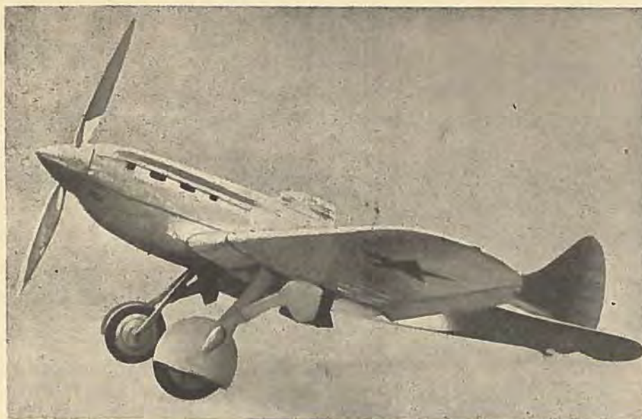
Den russiske Jager Z. K. B-19, et lavvinget Metal-Monoplan.
