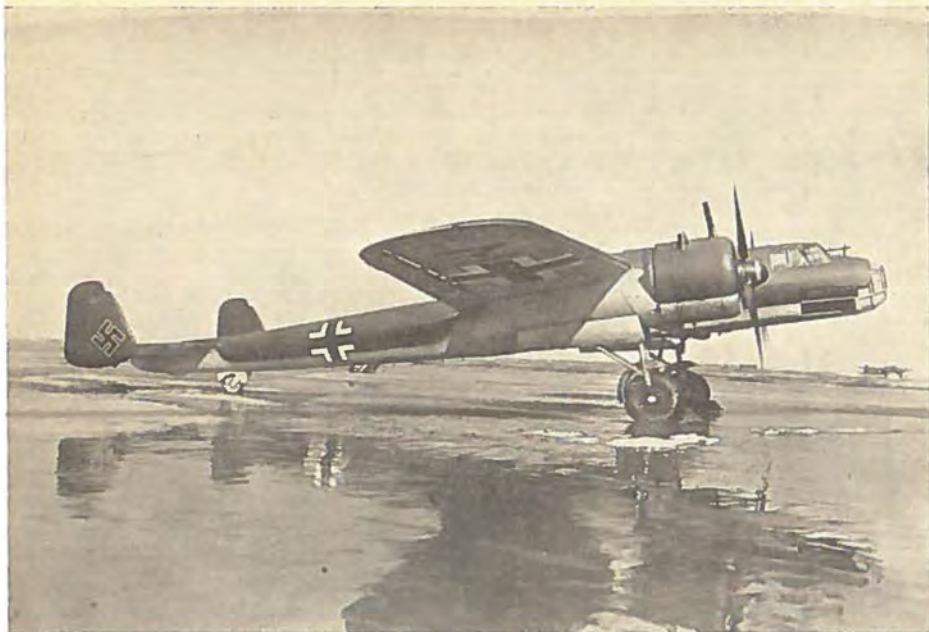
DORNIER DO 17. Mellemtung Bombemaskine og Fjernopklaringsmaskine. Besætning 3 Mand. 3 Maskingeværer. To Motorer (Stjernemotorer eller vandkølede Motorer). Bombelast 1000 kg. Rækkevidde 2500 km. Hastighed 400—490 km/T.
