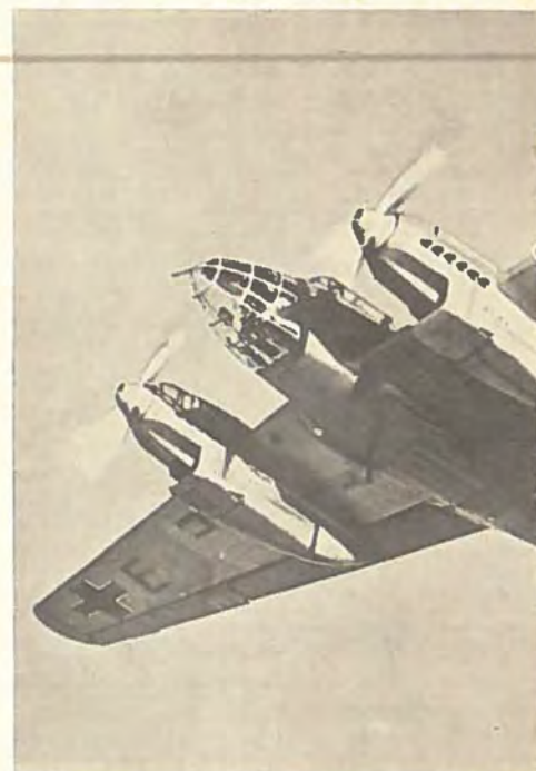
MESSERSCHMIDT »JAGUAR«. Bomber i ning 4 Mand. Flere lette og tunge Mg. (i pen). 2 vandkølede Motorer paa ialt ca. offentlig
