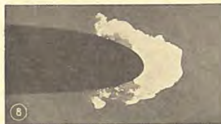
Optagelser af Isdannelsen omkring Forkanten af et Bærepil. Forsøget er udført i en Vindkanal, hvor Luftstrømmen kan gøres fugtighedsholdig og afkøles stærkt.
