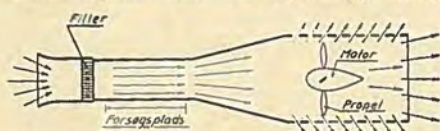
Vindkanal med lukket Forsøgsplads og uden Tilbageføring. I Almindelighed har Kanalerne med lukket Forsøgsplads ogsaa Tilbageføring.
