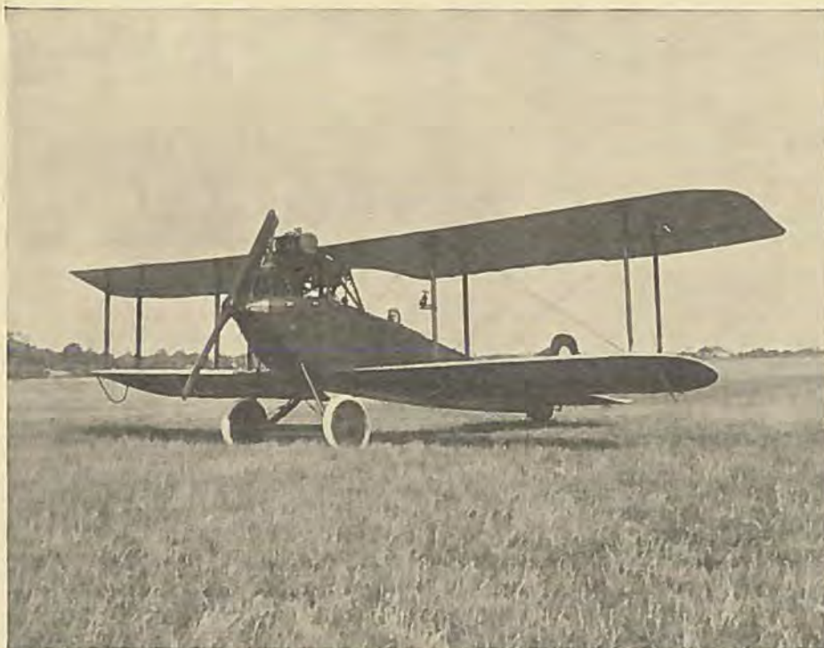
Ældre Flyvemaskine af Biplantypen med Støtter og Barduner mellem Bærepplanerne. Maksimal Hastighed ca. 120 km/T.
