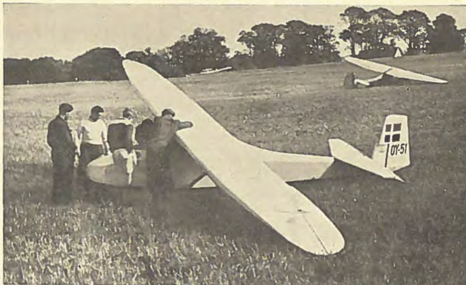
En »Grunau Baby 2B«, det bedste Overgangsplan, der hidtil er set. Ved sine Bremsklapper kan det lande paa en meget lille Plads. I Baggrunden Fugls Bussard.
