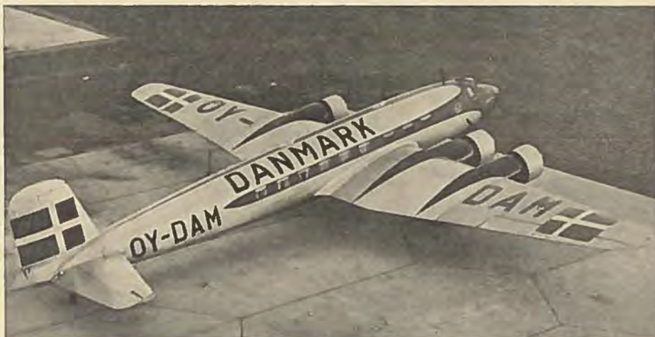
Moderne Trafikflyvemaskine. 4-motoret, fritbærende Monoplan. Maksimal Hastigheden ligger ved disse Typer paa ca. 400 km/T.
