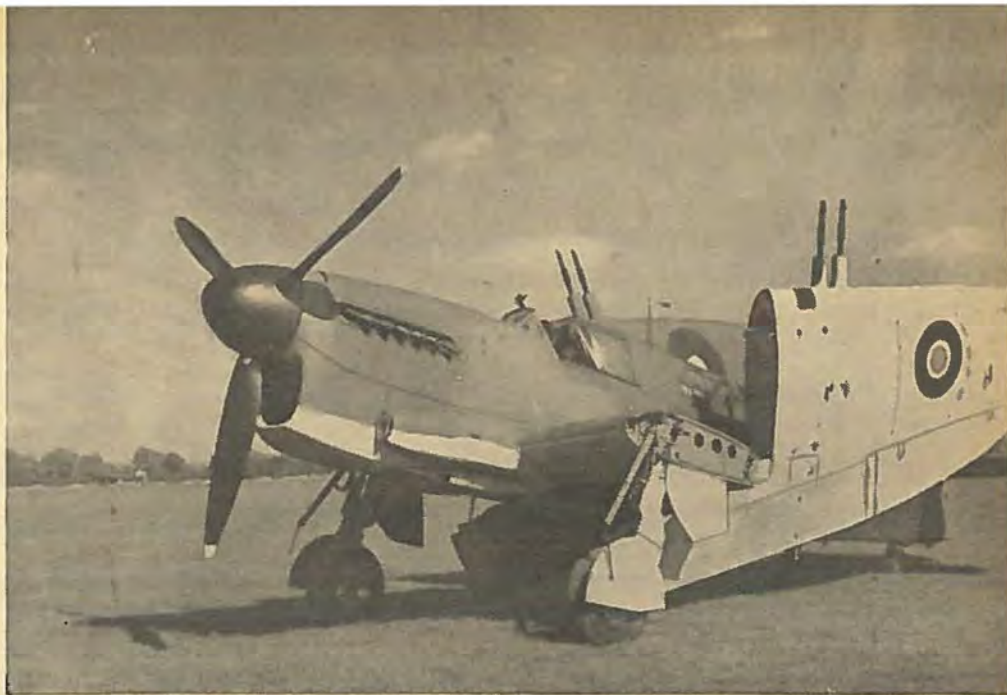
Fairey »Firefly« paa Jorden med sammenklappede Planer.
