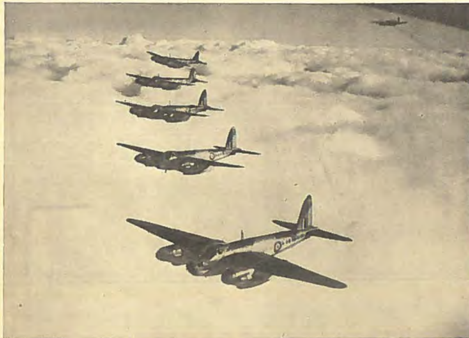
En Formation af Mosquito-Maskiner. Bevæbningen bestaar af 4 20 mm Kanoner og 4 Maskingeværer.
