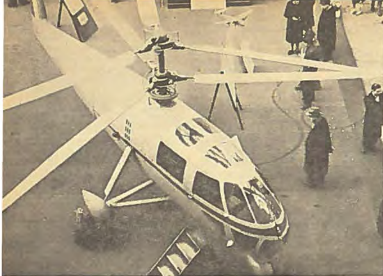
Breguet 11 E Helikopter med co-aksiale modsatrotierende Rotorer. Kropformen er mere elegant, end man er vant til paa Helikoptere.
