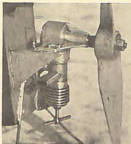
3,5 cm³ norsk Dieselmotor, Konstruktion: Jan David Andersen.
