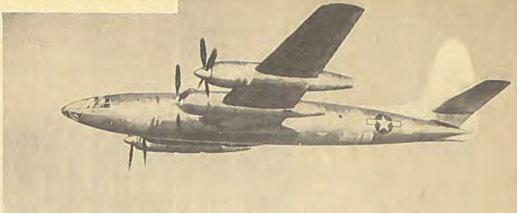
Rainbow har en ualmindelig elegant Form, der har bragt Modstanden betydeligt ned. Vindskærmproblemet er løst paa den Maade, at den forreste Del ved Start og Landing trækkes ind, saa Piloten faar en normal Vindskærms bedre Udsyn.
