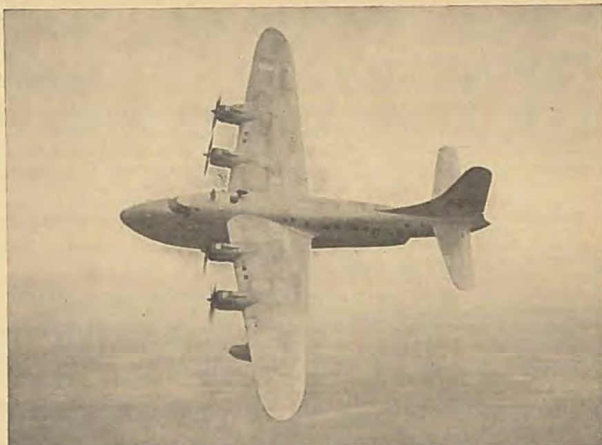
Short Solent, der bliver bygget til British Overseas Airways Corp., er Verdens hurtigste civile Flyvebaad. Maximalfart 442 km/T, Rejsefart med 56 %, Motorydelse 336 km/T. Den er udstyret med Bristol Hercules ventilløse Motorer.
