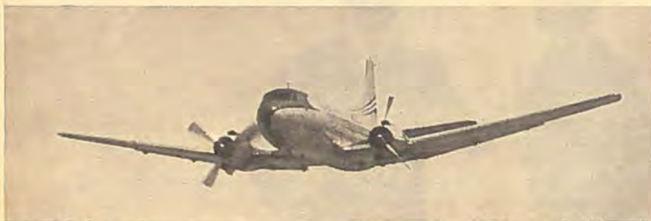
Martin 2-0-2 under den af ICAO foreskrevne Startprøve paa een Motor. Propellen paa den anden Motor er kaststillet.
