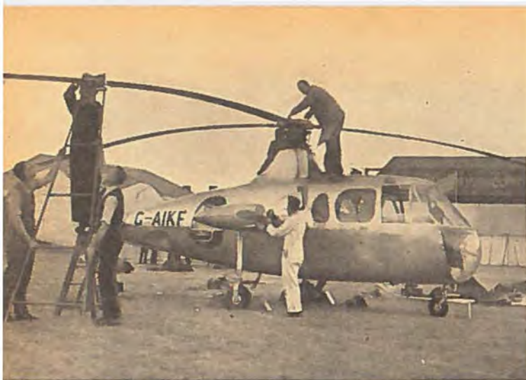
Society of British Aircraft Constructors afholdt i September sit årlige Stævne for 10.000 indbudte flyvesagkyndige fra 50 Lande. En Del af de 60 udstillede Typer demonstreredes ogsaa i Luften. Til venstre ses Fairley Gyrodyne Helikopteren til 5 Personer. Den motordrevne Propel paa højre Side modvirker Rotationstendensen. Til højre ses Fairleys flyvende Bombe, Stoooge, paa sin Startbane. Den radiostyres ved Apparatet til højre.
