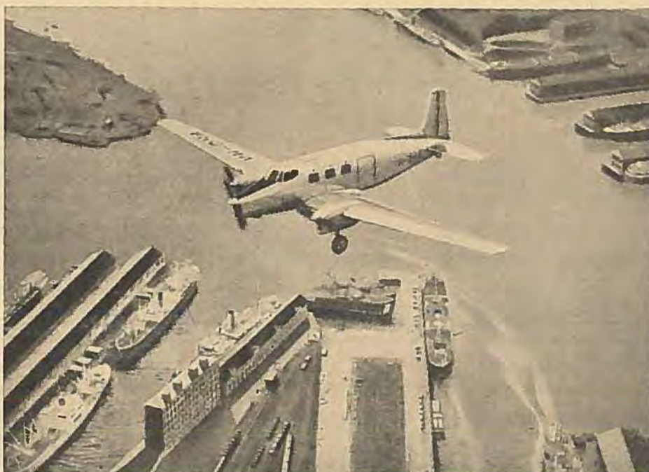
De Havillands afdeling i Australien har fremstillet en DH Drovér, der på mange måder minder om Dove, men er lidt mindre og lettere. Den har tre 145 hk motorer og fast understel og er specielt bygget for australske forhold. Nyttelasten er 1000 kg, største rejsehastighed 220 km/t og rækkevidden 800 km.
