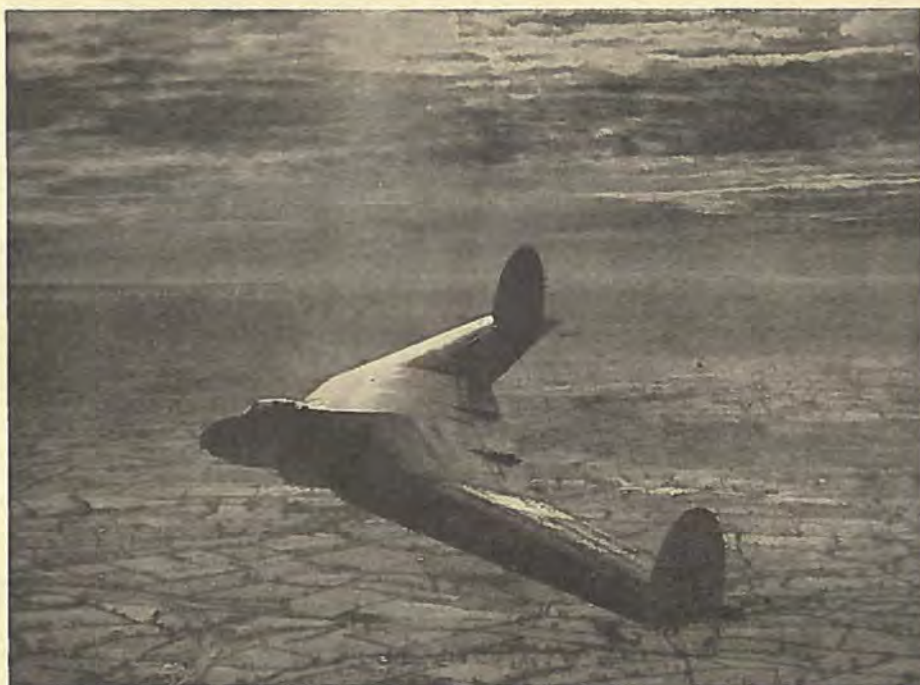
Den meget interessante haleløse Armstrong Whitworth AW 52, som er udstyret med 2 Rolls-Royce Nene Reaktorer, er nu godt i Gang med Prøveflyvningerne. Efter Glideplanet AW 52 G er den det næste Trin paa Vejen til en større Type med 6 Reaktorer. Englænderne gaar forsigtigt og metodisk til Værks overfor Fremtidens Flyvemaskiner.
