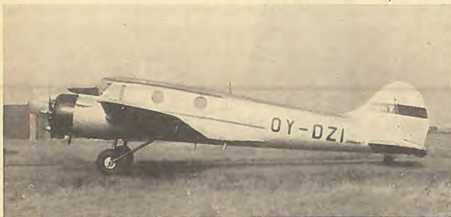
Avro Anson V er en kanadisk Version af den berømte Typs. Dens Krop er en »bagt« Trækonstruktion. Motorerne er 450 HK Pratt & Whitney Wasp Junior. Med en Topfart over 300 km/T er det Zonens hurtigste Maskine.
