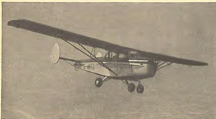
En moderne engelsk Privatflyvemaskine er den fire-sædte Christea Super Ace med en ny Styreanordning, hvorved alle tre Ror berøres hver for sig med samme Rat. Med en 145 HK Gipsy Motor har den en højeste Rejsefart paa 185 km/T. Fuldvægten er 1065 kg.
