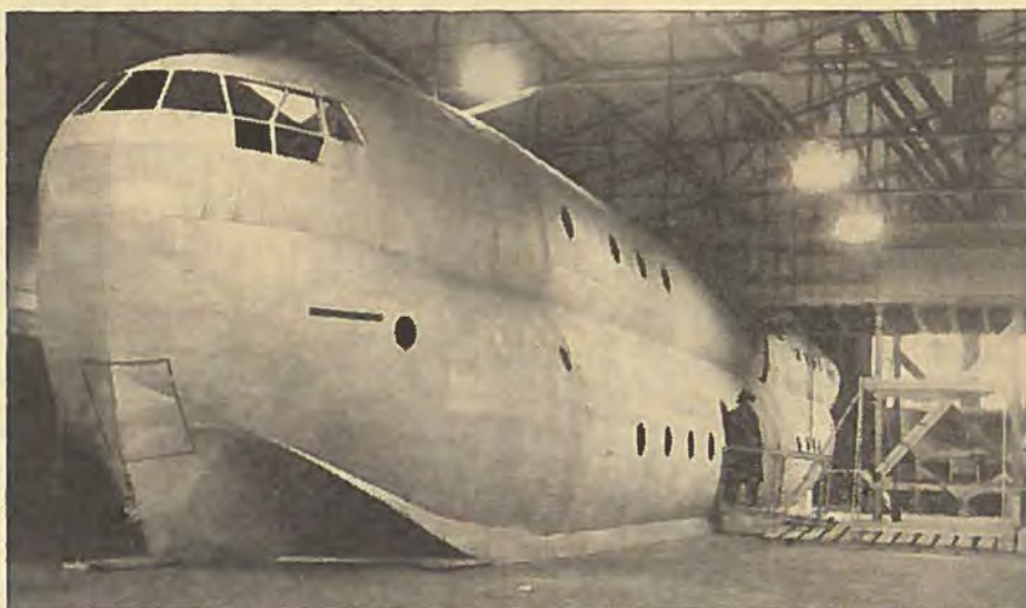
Selv om man er godt i Gang med Kroppene til SR/45, forestiller dette Billede ikke en »rigtig« Flyvebaad, men er kun en Model, en saakaldt »mock-up«, der især tjener til at arrangere de indre Installationer, hvis kolossale Omfang ikke kan overses paa en Tegnestue.
