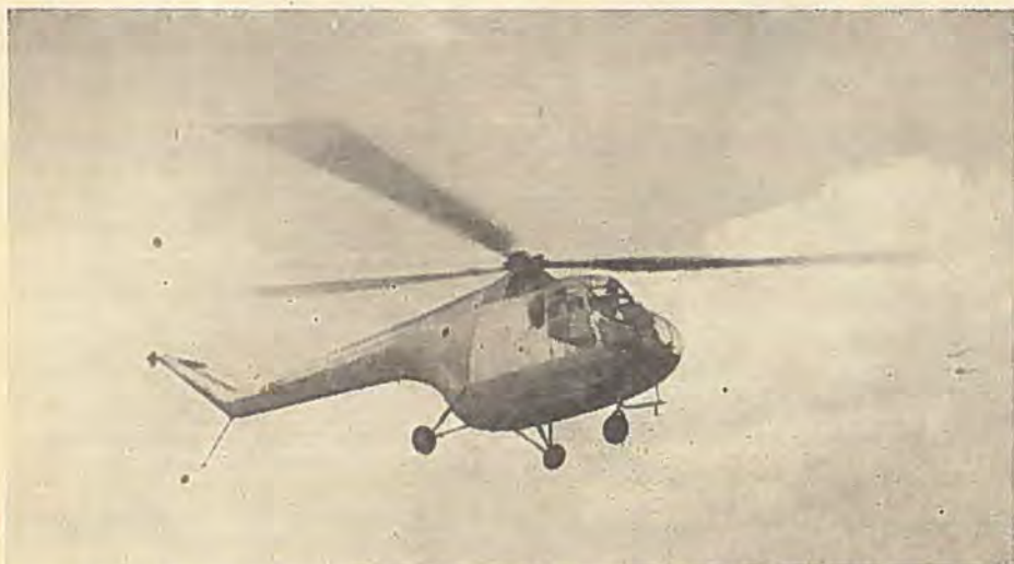
Bristol 171 er en konventionel Helikopter med Hovedrotor og stabiliserende Halerotor, men har interessante Enkeltheder.
