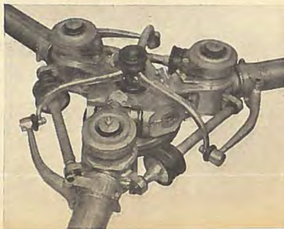
Hovedrotorens indviklede Nav er en omhyggeligt udformet Mekanisme.
