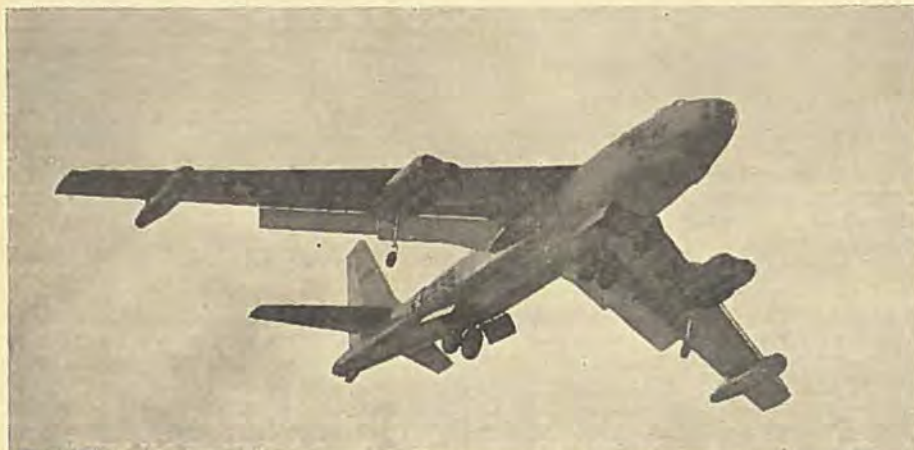
Den mærkelige Boeing Stratojet med 6 I-35 Reaktorer. Spændvidde 35 m, Længde 33 m, Fuldvægt 56 t. I Starten anvendes 18 Raketter, der hver i 3 Sek. yder 450 kg Trykkraft. Mundingerne skimtes over Agterhjulet.
