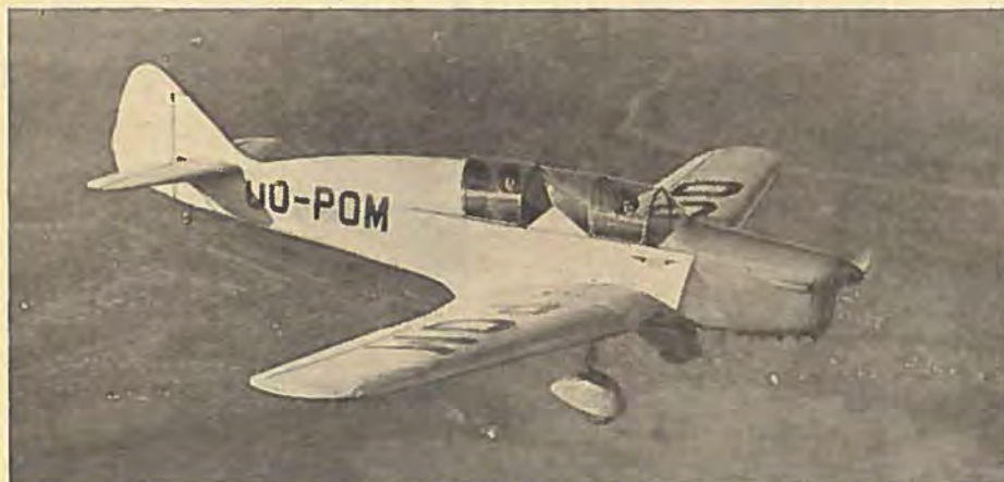
Fairey Træneren i Luften. Man ser tydeligt »Hakket« i Overbygningen — strømningsteknisk ugunstigt, men praktisk for Udsynet fra bageste Sæde.
