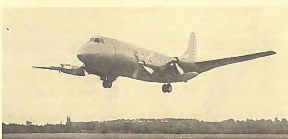
Vickers har ogsaa bygget Verdens første Trafikflyvemaskine med Propelturbiner (4 Rolls-Royce Dart).
