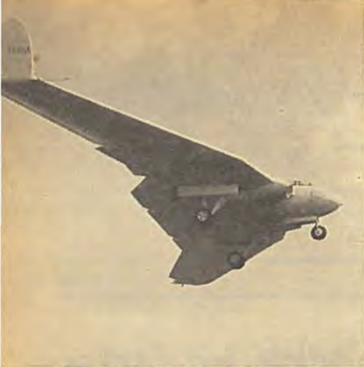
Armstrong Whitworth AW 52 ved at lande. Der findes to eksemplarer af denne forsøgstype, en med Derwent og en med Nene reaktorer.
