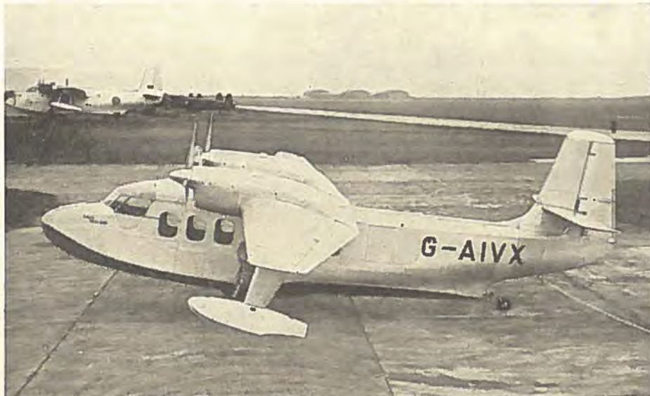
Det to-motors Amfibium Short Sealand, der ogsaa kan leveres som ren Flyvebaad. Med to Gipsy Queen Motorer er højeste Marchfart 280 km/T.
