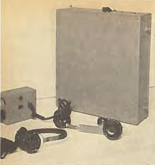
VHF-Telefonianlæg af typen »Walco 4« omfattede apparatkasse, manøvrebox, mikrofon og hovedtelefon.
