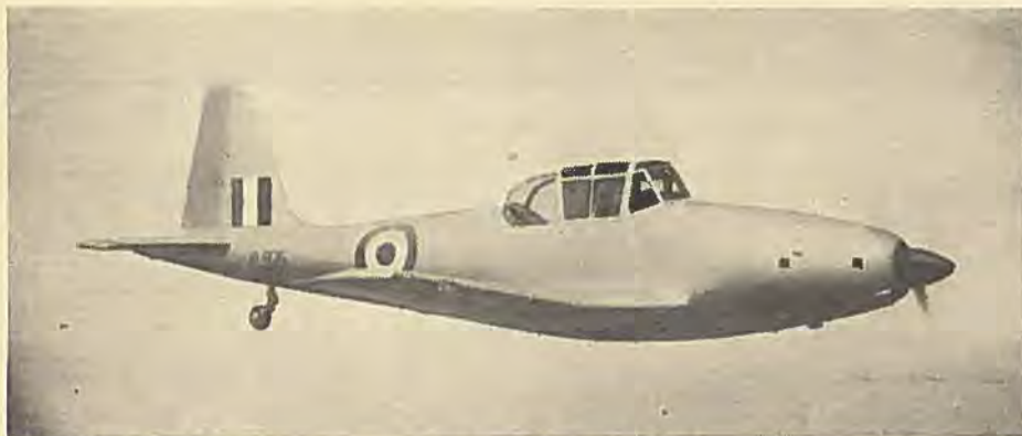
Boulton Paul Balliol T1 Træneren er en af de nyeste engelske videregående Uddannelsesflyvemaskiner, som man maaske vil gaa over til at skole paa fra Begyndelsen. Med en Armstrong Siddeley Mamba Propelturbine flyver den næsten 500 km/T. Den oprindelige Prototype var udstyret med Bristol Mercury, men den vil blive produceret med Rolls-Royce Merlin 35 vædskekslet Motor ligesom Avro Athena, der er bygget efter samme Specifikation.
