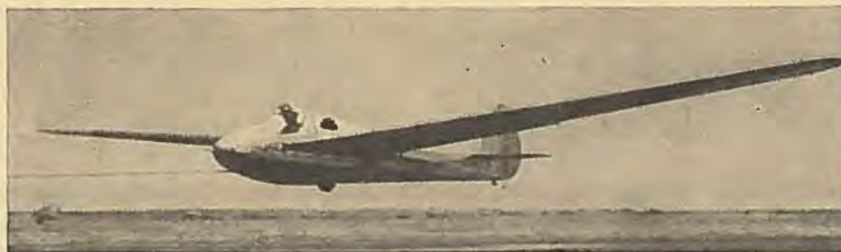
Richard Comey vandt de internationale Konkurrencer i Texas i 1947 med denne helmetalbyggede Schweizer I-21, der var udstyret med Vandballast i Planforkanten. Comey fløj Liberator under Krigen og er nu Generalsekretær i den amerikanske Svæveflyveorganisation.
