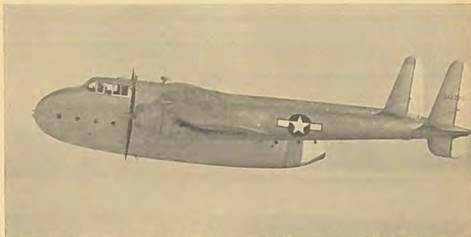
Fairchild C-82 Packet er specielt konstrueret som Transportflyvemaskine. Med to 2100 HK Pratt & Whitney Motorer og en Fuldvægt paa 22 Tons kan den bære 8 Tons over 800 km eller 6,2 Tons over 2400 km med en Rejsefart paa 350 km/T.
