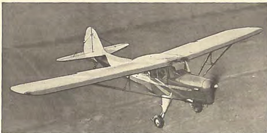
Auster Avis er en 4-sædet Videreudvikling af de tidligere kendte Austertyper. Tomvægt 672 kg, Fuldvægt 1157 kg, højeste Rejsehastighed 182 km/T med en 145 HK Gipsy Motor.
