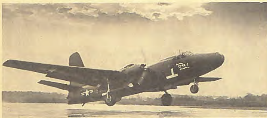
To Pratt & Whitney Wasp Major på hver 3000 hk samt to Allison J-33 reaktorer på hver 1814 kg trykkræft bringer hurtigt den 36 tons P4M-1 Martin Mercator i luften. 19 bygges til U.S. Navy.
