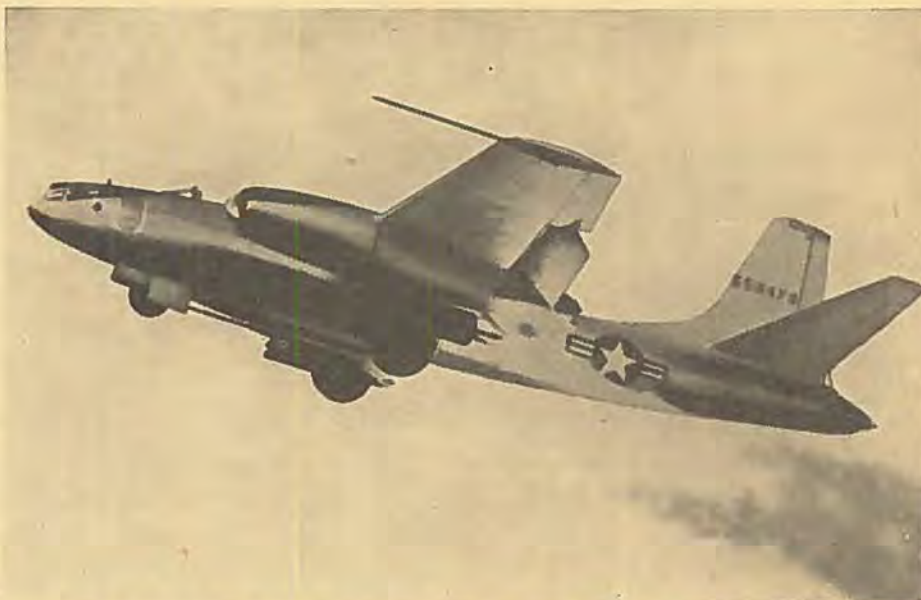
North American B-45 under start med JATO-aggregater, der forsøger de 4 reaktorer 9000 kg trykkraft med 3800 kg.
