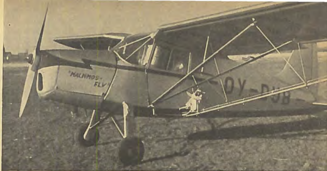
Malmosfly's KZ III med sprøjteanlæg. Man ser beholderen i kabinen og sprøjterørerne under planet samt den luftdrevne pumpeanordning.
