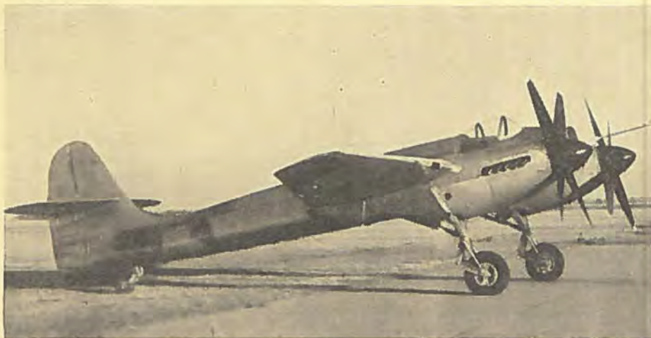
I.Ae. 30 Nancu har to Rolls-Royce Merlin motorer på 1800 hk og minder en del om de Havilland Hornet.
