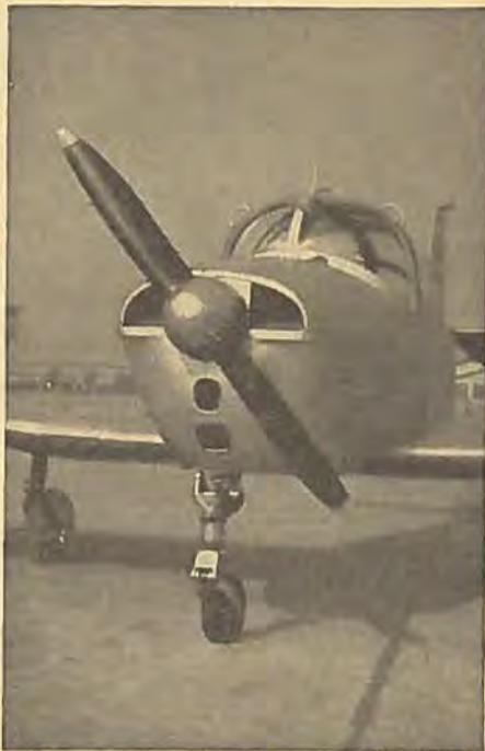
På Pariser-udstillingen vises Fokker S 12, som er den kendte S 11 Instructor, udstyret med næsehjulunderstel, således at man med en S 12 let kan omskole en flyver, der er vant til S 11.
