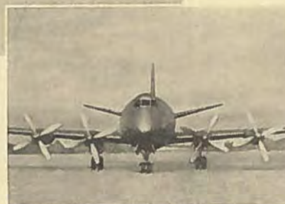
Frontbillede af maskinen. Man ser tvillinghjulene og det højtliggende haleplan, der bevirker, at luftfartøjets stabilitet ikke påvirkes af ændringer i motorkraften eller ved betjening af flaps og understel.
