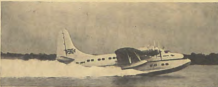
Short Solent er den nyeste i den lange række af vellykkede flyvebåde, der begyndte med Short Empire. Den medfører 36 passagerer i meget rummelige kabiner og bruges på sydafrikaruten samt i Australien. Med 4 Bristol Hercules motorer på hver 2000 hk rejser den med ca. 390 km/t.
