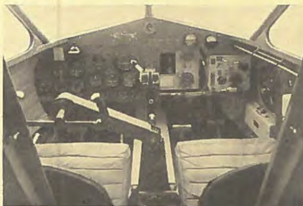
Førersædet i den første KZ IV. Man ser det svingbare rat og de dobbelte pedaler. I midten gas-, højdegas og trimhåndtag, til venstre skimtes flaphåndtaget. Til venstre flyve- og motorinstrumenter, til højre radioudstyret.
