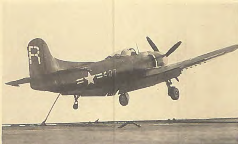
Den 10_tons tunge jager, Martin Mauler, lander på hangarskibets dæk og bremses op af bremsewirerne på dækket.
