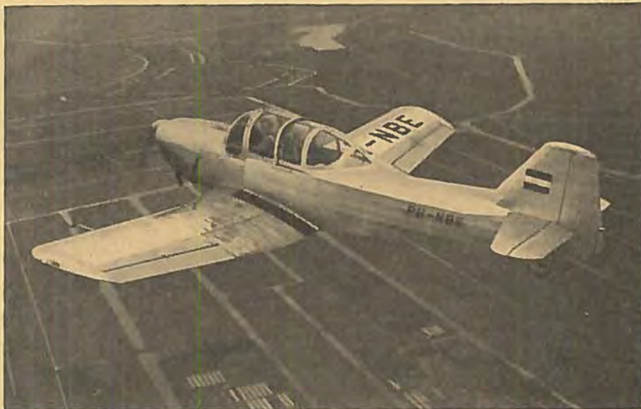
Fokker S-11.2 Instructor er den anden version af denne moderne hollandske træner, der har fuldt nat-, instrumentflyvnings- og radioludstyr. En senere version får næsehjul.
