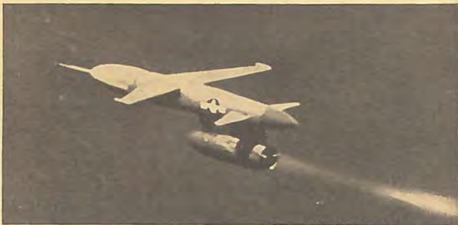
Martins Gorgon IV i fuld fart. Kanalreaktoren er et meget enkelt fremdrivningsmiddel uden bevægelige dele. Da den ingen statisk trykkraft udøver, må man først bibringe den hastighed.
