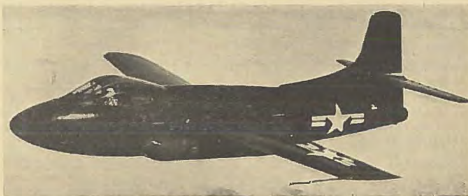
Douglas XF3D-1 Skyknight er en to-sædet jager beregnet til at operere fra hangarskibe. Også den har to 1410 kg 24 C reaktorer.
