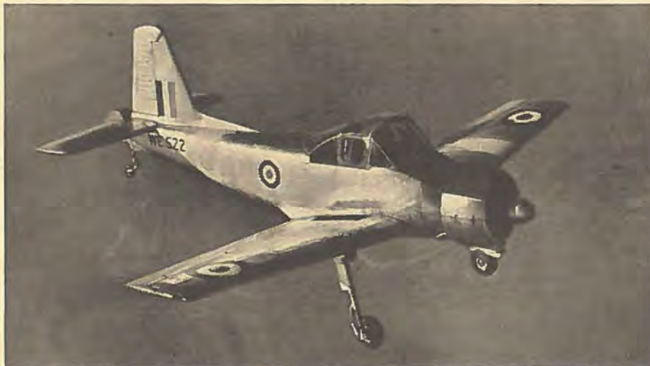
Percival P.56. Understel og halehjul er endnu ikke monteret med skærme på dette billede.
