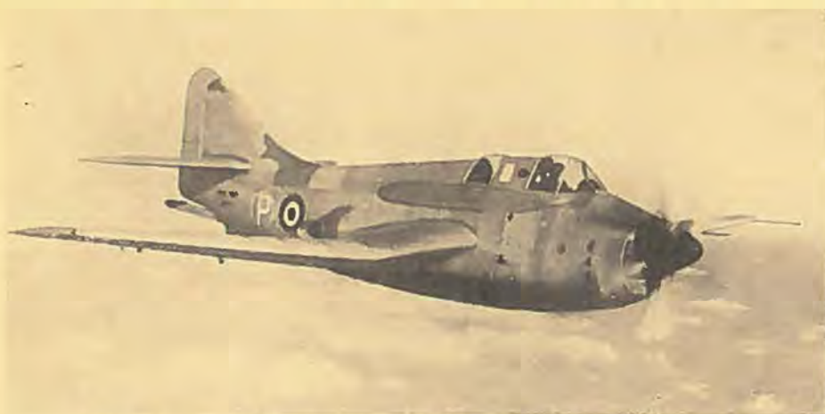
Fairey 17 er en ny flåde-flyvemaskine til bekæmpning af u-både. Motoren er en Armstrong Siddeley Double Mamba propelturbine.
