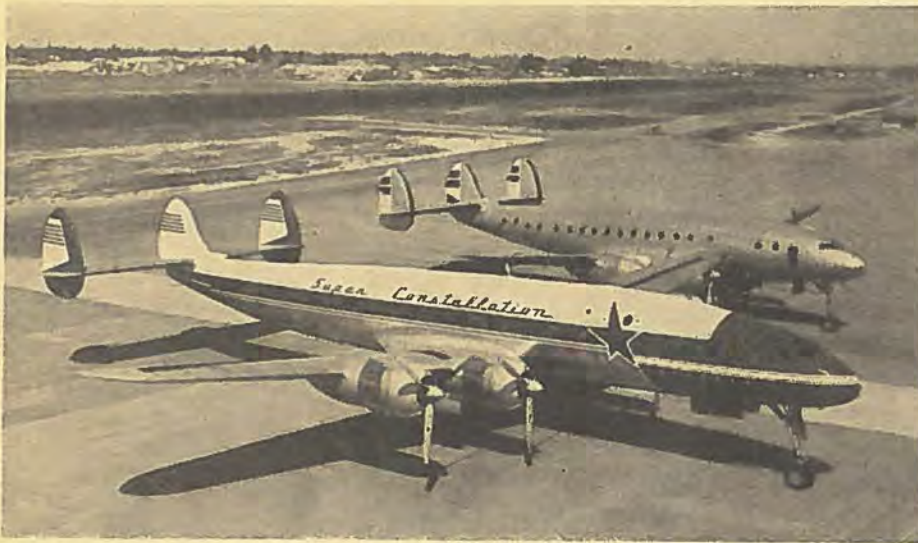
Lockheeds nyeste: Super Constellation ved siden af en normal »Connie«, der er 5,61 m kortere. Den nye type er udstyret med stempelmotorer, men vil i senere versioner kunne leveres med propelturbiner.
