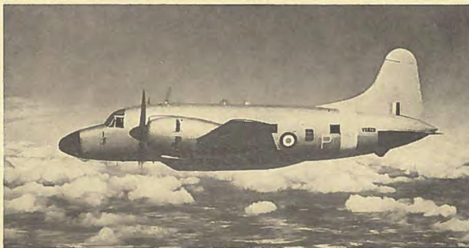
Vickers 648 Varsity er som S 13 på foregående side en træningsmaskine for besætninger, men den er af noget større format. Den er udviklet af Viking og Valetta, men har næsehjul og et »badekar« under kroppen til bombekasteren.
