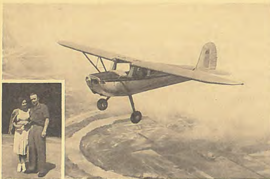
Cessna 120 er en to-sædet privatflyvemaskine bygget i helmetal med 85 hk Continentalmotor og frit stålunderstel. — Indsat Adolf Gehriger og frue.
