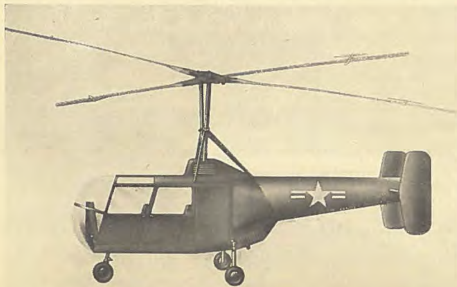
Kaman HOK-1 er en ny firesædet militær helikopter med rotoratorer i »flødepisker«-arrangement.
