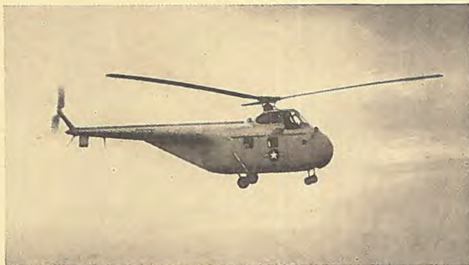
Sikorsky S-55 er beregnet til 10 passagerer. En 600 hk Pratt & Whitney Wasp er indbygget på skrå i næsen med akslen ført op til rotoren.
