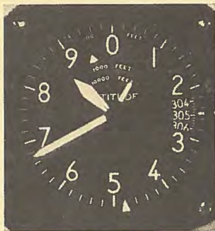
Modern trevisers højdemåler med tre visere. Den er inddelt i fod, og i ruden til højre ses barometerstanden i tommer.
