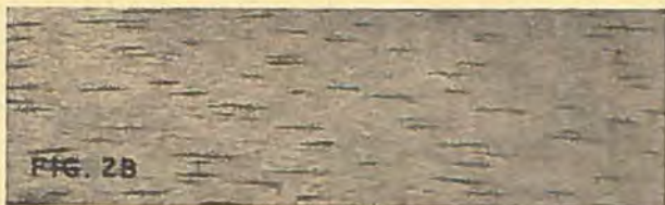
2 A viser »flat-sawn« balsa. De mørke striber er karrene. 2 B viser omtrent »flat-sawn« med korte karstykker, mindre stærkt end 2 A.
