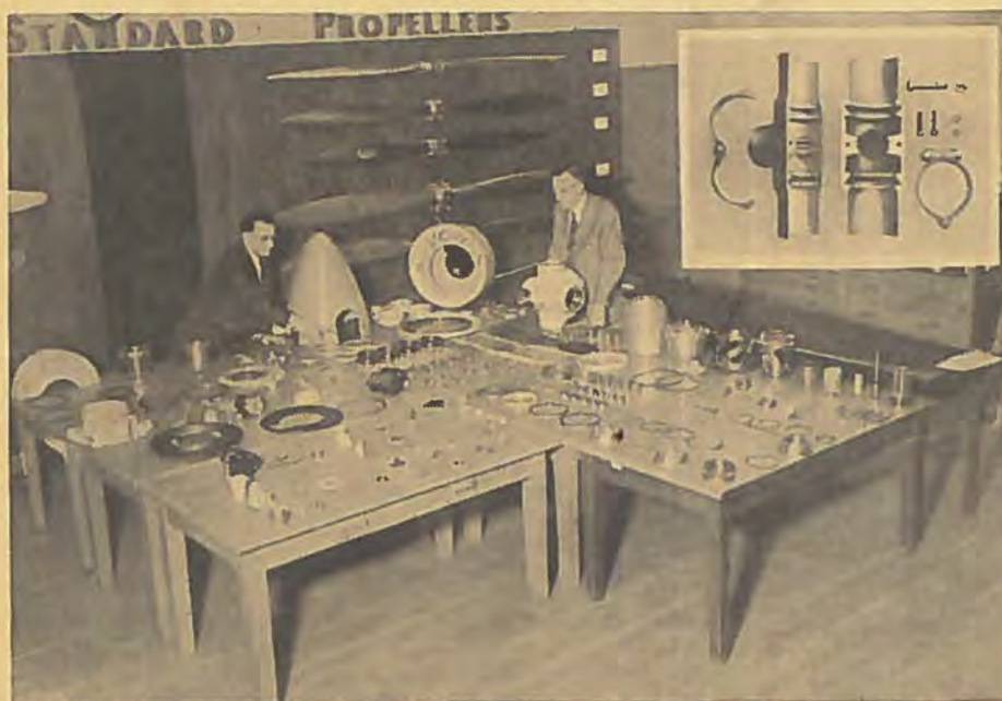
De over 1400 dele i en moderne propel sammenlignet med en af de første stilbare propeller for 25 år siden.
