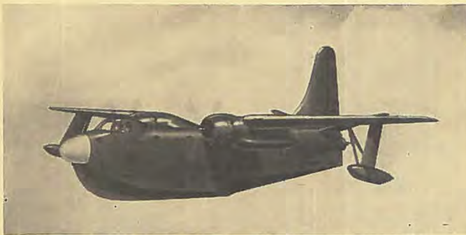
Martin P5M-1 udmærker sig ved »mågevinge« og en kropunderside næsten uden »trink«. Der er stort radarudstyr, bl. a. i næsen på flyvebåden.
