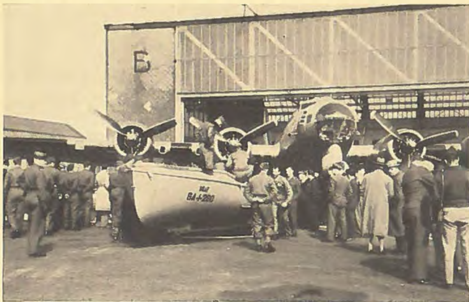
Redningsbåden foran den Boeing SB-17G, der medfører den. Under næsen på »fæstningen« ses radarinstallationen, hvormed man søger efter de nødstedte.
