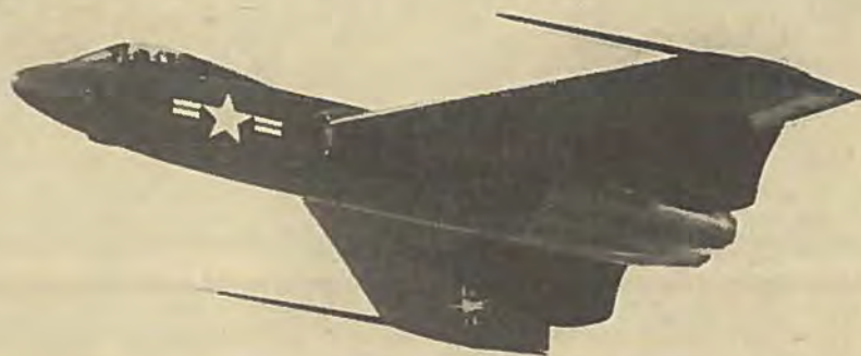
Chance Vought F7U-1 er den første haleløse jager, der er i produktion. To Westinghouse 24 C reaktorer er dens drivkraft.
