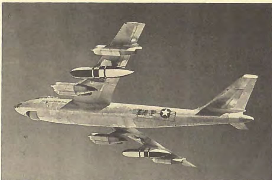
Et billede af Boeing B-47B med udvendige tanke, der skal være de største på nogen flyvemaskine. Den sort-hvide maling skal lette observationen ved faldprøverne.
