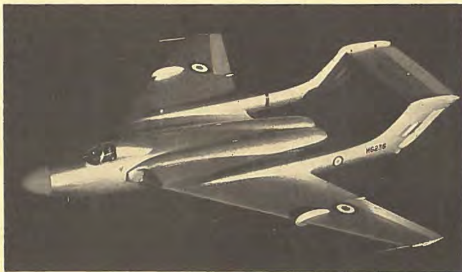
Den tosædede radarudstyrede de Havilland 110 til brug i dårligt vejr og om natten. Den er udstyret med to Rolls-Royce Avon reaktionsmotorer.
