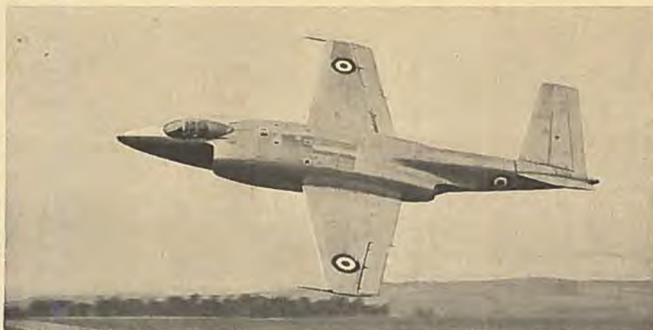
Vickers Supermarine 508 er en ny jetjager, konstrueret til brug på hangarskibe. Den er udstyret med to Rolls-Royce Avon motorer. Bemærk v-halen,
