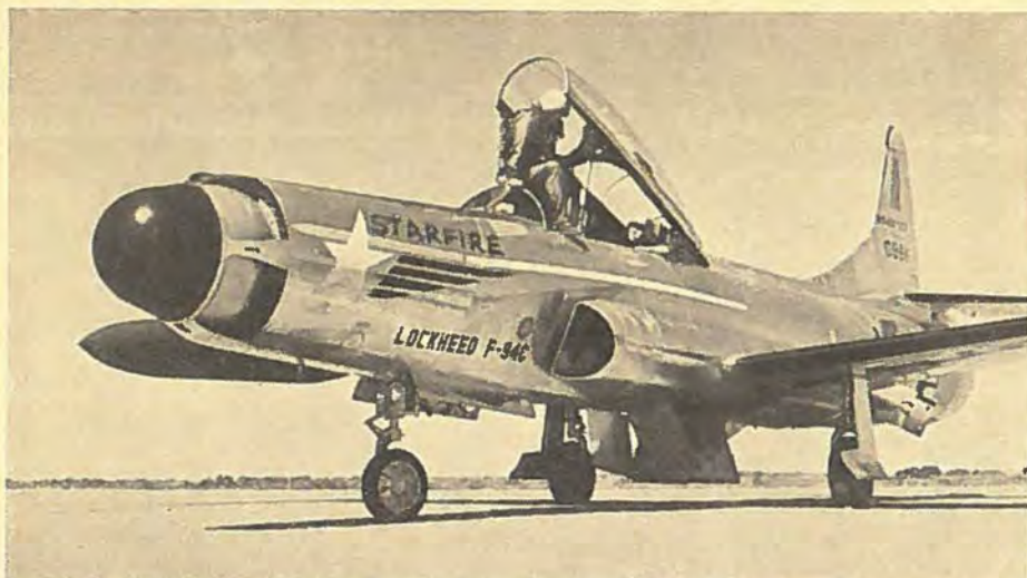
Lockheed F-94, der flere gange har været afbildet i FLYV, indsættes nu i forsvaret af USA i denne version F-94C Starfire. Bag radarskærmen i næsen sidder bevæbningen, 24 raketter. Normalt dækkes munderne af lemmene, der her ses åbne.
