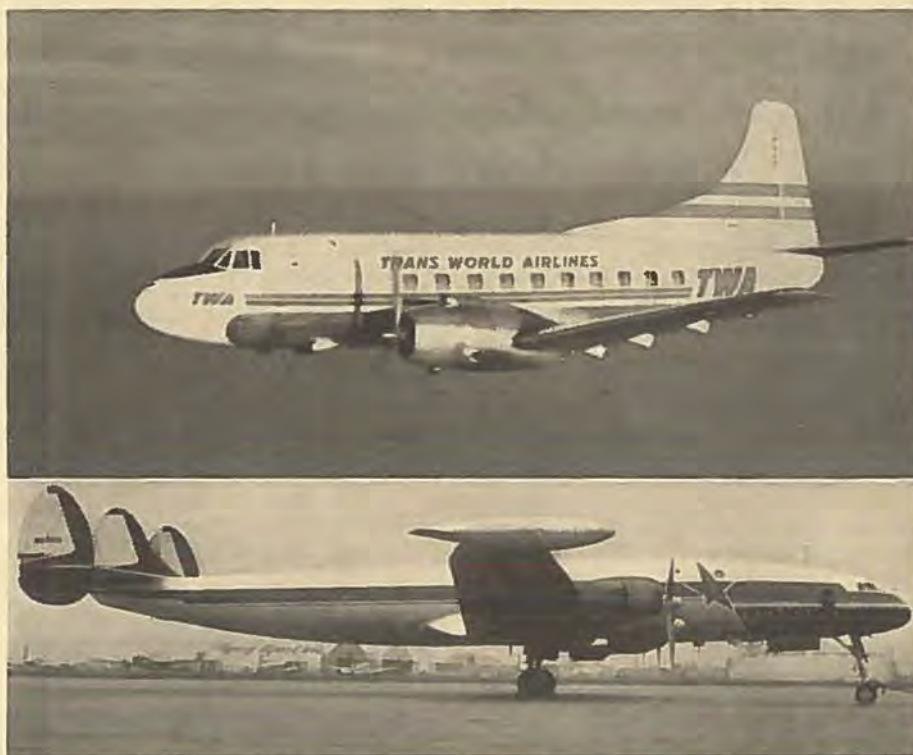
Øverst Martin 4-0-4, der er en forlængt og moderniseret udgave af 2-0-2, bl. a. udstyret med trykkabine, som er en selvfølge i moderne trafikmaskiner. Nederst prototypen af Lockheed Super Constellation forsynet med brændstoftanke i plantipperne — det bliver nødvendigt på versioner med turbinemotorer.
