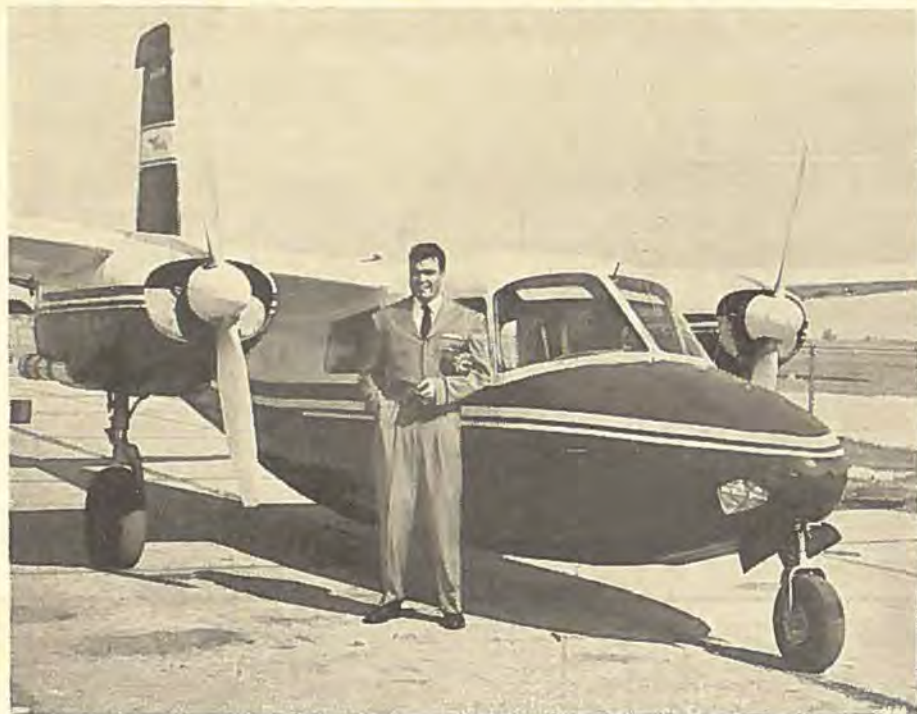
Aero Commander er en forholdsvis ny flyvemaskine til forretningsbrug o. lign., som nu er i produktion i USA. Den er udstyret med to 260 hk Lycoming-motorer og har en rejsefart på 317 km/t. Der er plads til 6-7 personer. Prototypen fløj sidste år fra Oklahoma til Washington med fuld last på en motor. Venstre propel var afmonteret.
