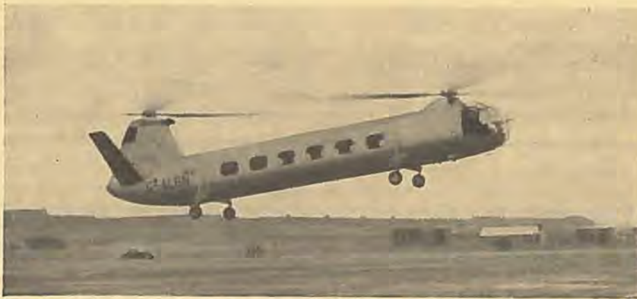
Den store Bristol-helikopter type 173 (FLYV nr. 5/1951 side 98) har nu været i luften. Forinden den fik sin luftdåb, blev den prøvet ca. 35 timer på jorden. Den er i første række beregnet at skulle medføre 13 passagerer, men kan også indrettes som fragtluftfartøj. Den kan laste 1.134 kg. Den har to træbladede rotoratorer og er udstyret med to Alvis Leonides L.E.25 H-M.V. stjernemotorer hver på 550 hk.
