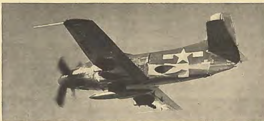
Køn er Douglas A2D-1 ikke, men formodentlig effektiv. Det er en flådetype, udstyret med en Allison T-40 turbinemotor med koaksiale modsatløbende propeller.
