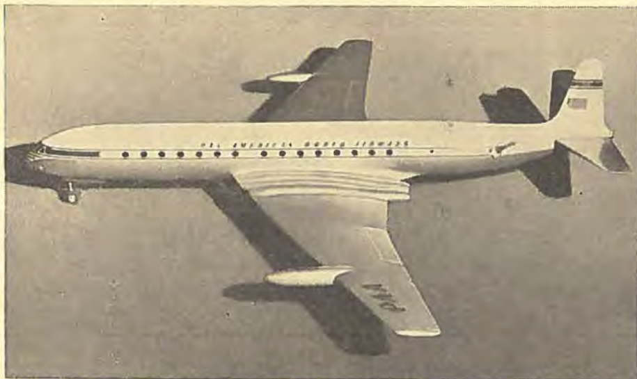
Model af de Havilland Comet 3. Kroppen på den nye udgave er 5,5 m længere end på de første. Noget nyt er de store udvendige brændstoftanke.
