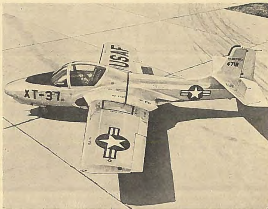
Medens der allerede er fremkommet flere europæiske jet-trænere, hvor man sidder ved siden af hinanden, er denne Cessna XT-37 den første fra den anden side Atlanten. Den har to J-69 Continental jetmotorer d. v. s. licensbyggede Turbomeca Marboré.
