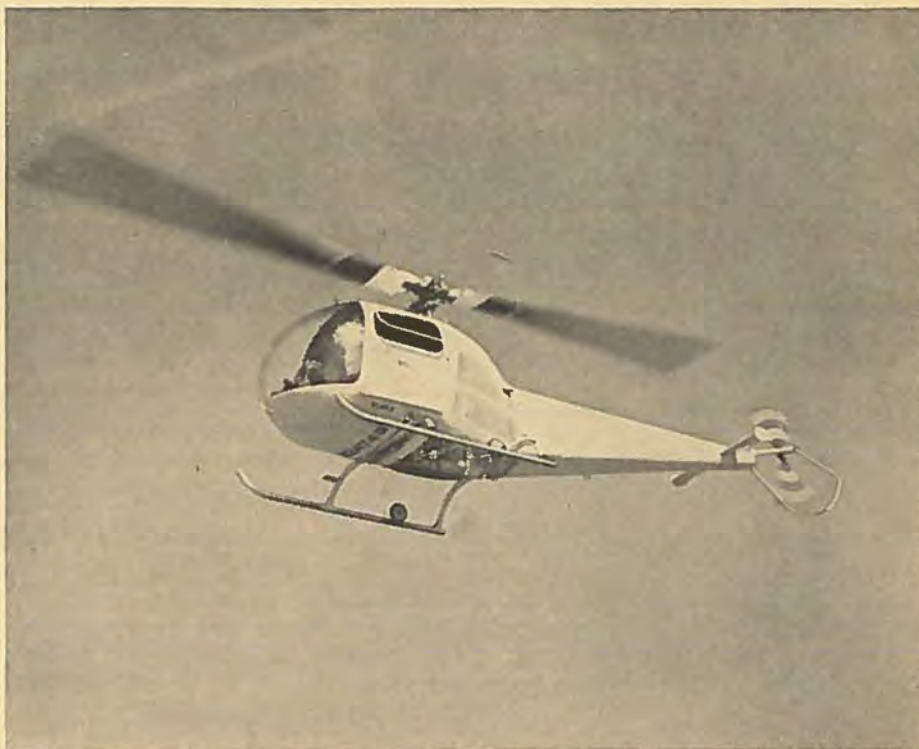
Der kommer stadig nye versioner af Bell 47, den helikopter, der hidtil er bygget i størst antal. Denne hedder Bell 47 G-1 og er udstyret med 260 hk motor. Den oprindelige Bell 47 havde kun 175 hk.
