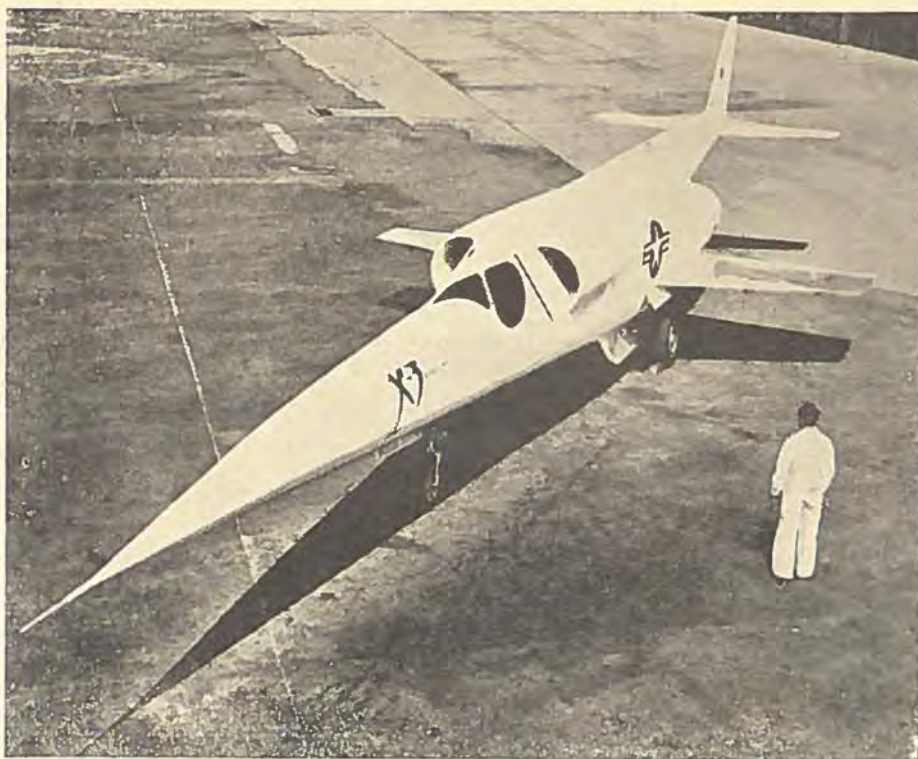
I konstruktionen af Douglas X-3 forsøgsmaskinen er der bl. a. anvendt Titanium af hensyn til gnidningsvarmen.
