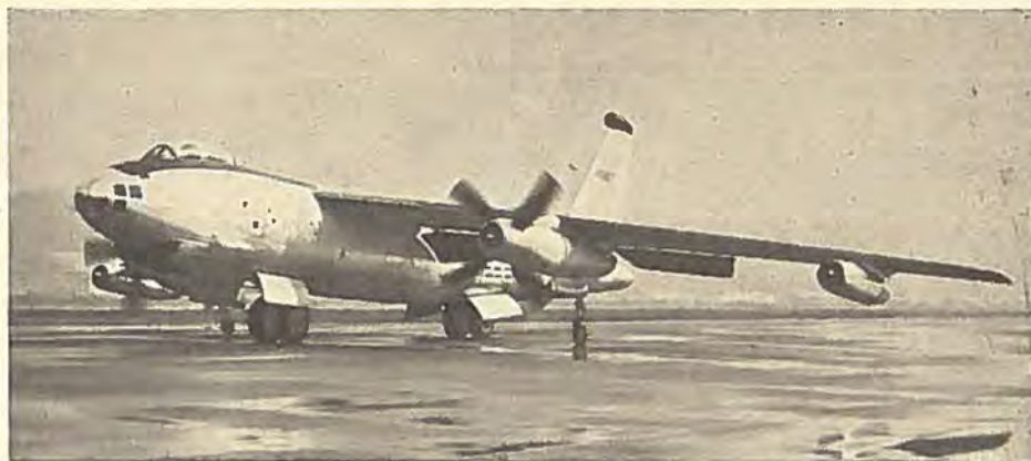
Boeing Stratojet som flyvende prøvestand: Billedet viser en Boeing XB-47D, forsynet med to Curtiss-Wright T49 turbinemotorer i stedet for de 4 inderste reaktionsmotorer. Installation er foretaget for at få afprøvet turbinemotorerne i luften.
