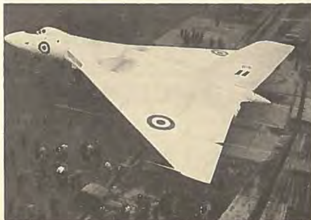
Avro Vulcan på jorden. Prototypen havde først Rolls-Royce Avon motorer, men fik senere kraftigere Armstrong Siddeley Sapphire motorer. Produktionsudgaven udstyres med den endnu kraftigere Bristol Olympus.
