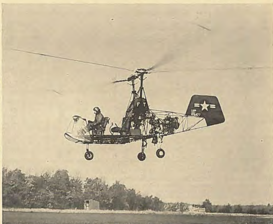
Turbinmotoren bliver efterhånden anvendt i flere og flere helikoptertyper. De første forsøg blev gjort med ovenstående Kaman K-225 med Boeing 502-2 turbomotor for godt tre år siden.
