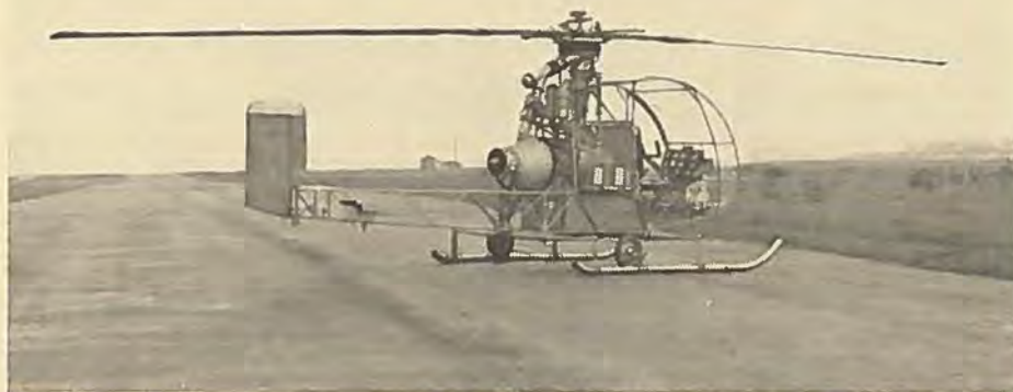
SNCASO 1221 Djinn, som vi omtalte i nr. 3 side 46, er sikkert den første turbinedrevne helikopter, der er i produktion. Selv om den er enkel og relativ billig, koster den dog en del i drift; men til mange opgaver lønner det sig dog.
