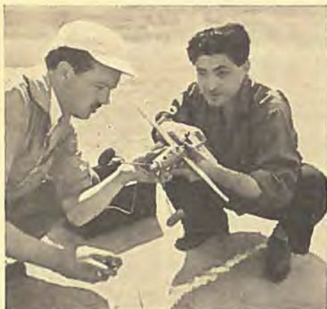
Til venstre en usædvanlig jugoslavisk model med meget smalt plan og enbladet propel. Til højre italieneren Cappi med en moderne kunstflyvemodell med 3.5 ccm Tigre diesel.
