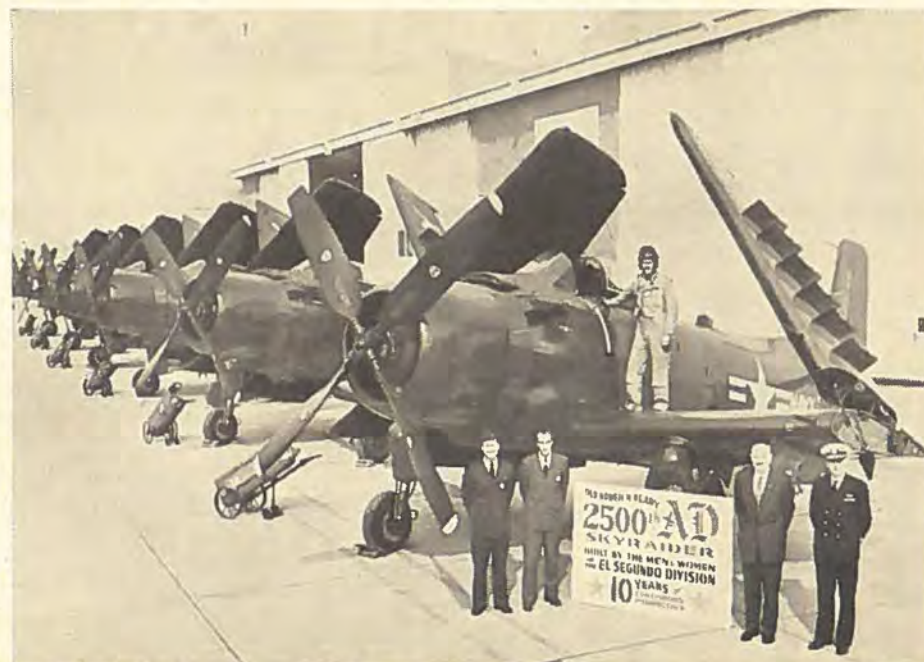
Douglas AD Skyraider har nu været i uafbrudt produktion i 10 år i en lang række versioner og er bygget i 2500 eksemplarer. Den anvendes fra hangarskibe til en lang række opgaver. Maximumfarten for AD-4 med en 2700 hk motor er 585 km/t.
