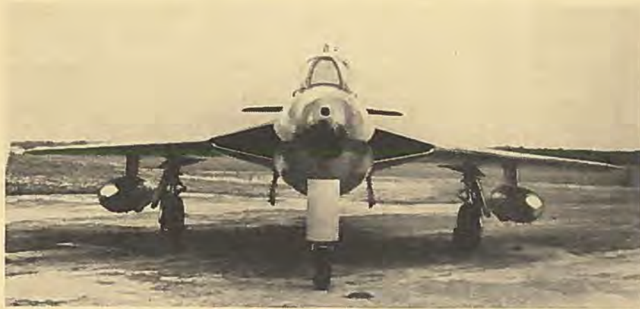
Hawker Hunter udstyres nu også med ekstratanke under planerne, hvorved typens aktionsradius øges betydeligt.
