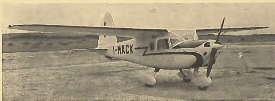
Macchi MB-308G er en velformet privatflyvemaskine til tre personer og med en 90 hk motor.
