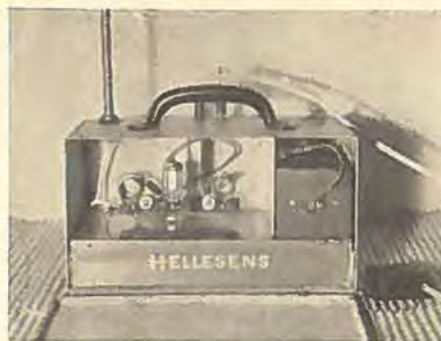
Senderen åben. Metalkassen er 16 cm høj og bærer foroven en ca. 250 cm høj antenne (messingrør).
