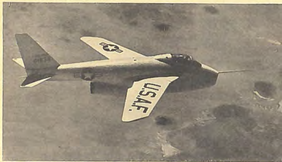
Bell X-5 er en forsøgsflyvemaskine til at eksperimentere med forskellig pilform på planerne under flyvningen og ved forskellige hastigheder. Motoren er anbragt lavt, antagelig a. h. t. pilforms-mekanismen.
