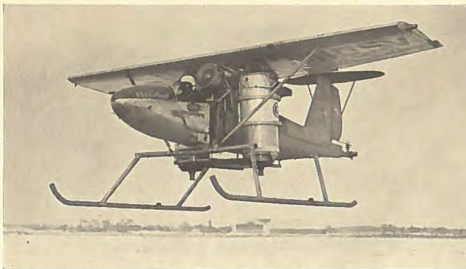
Her er et billede af Bell VTOL, som vi omtalte i Typenyt i sidste nummer. Den er flikket sammen af dele af forskellige luftfartøjer og udstyret med to Fairchild J 44 jetmotorer på siderne. Ved hjælp af disse kan den starte og lande lodret, og den styres da med komprimeret luft fra en Turboméca Palouste motor under planet. De to Fairchild-motorer kan drejes 90 grader og derpå bruges til fremdrift.
