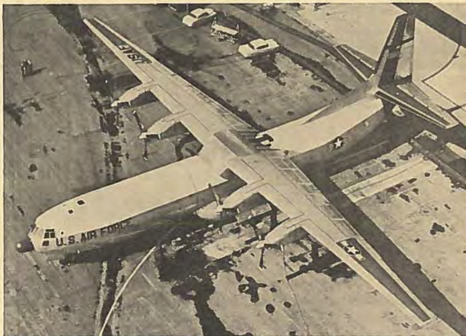
Første billede af Douglas C-133A, USA's nyeste transportmaskine. Den er forsynet med fire Pratt & Whitney T-34 turbinemotorer, er 54,75 m i spændvidde, 45,6 m lang og har en fuldvægt på 115,7 tons. Til troppetransport kan den medføre 200 mand
