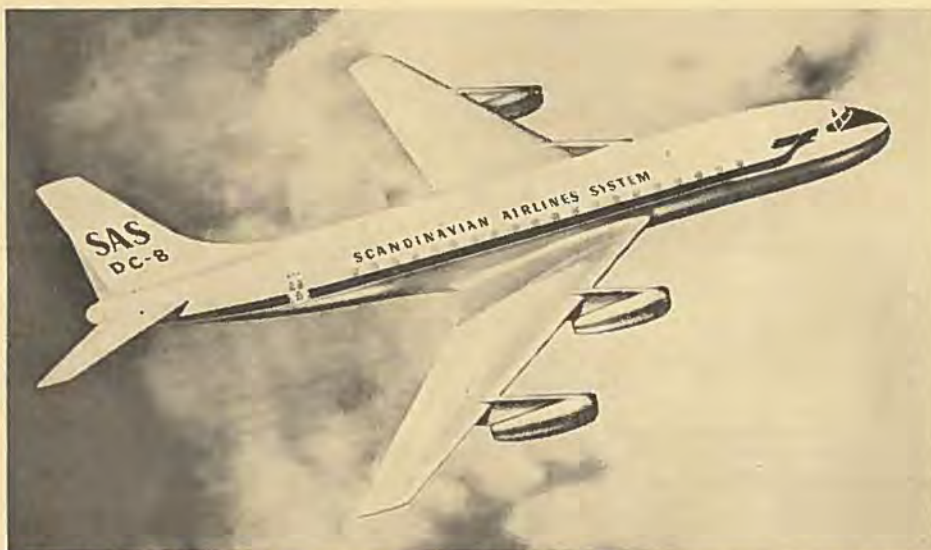
Sådan vil SAS's Douglas DC-8 komme til at se ud. Mange DC-8 og Boeing 707 forsynes med J-57, senere måske med J-75, og bl.a. for de skandinaviske maskiner er Rolls-Royce Conway en tredje mulighed.
