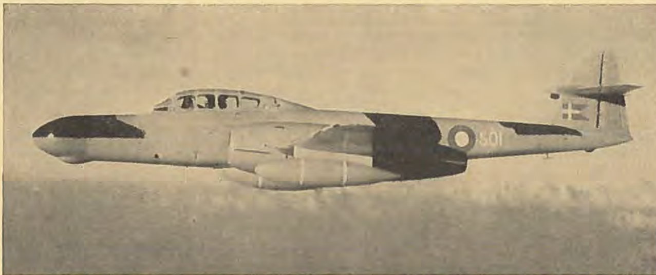
En af de Armstrong Whitworth Meteor NF 11, som eskadrille 723 er udstyret med. Den lange næse rummer radarudstyret.
