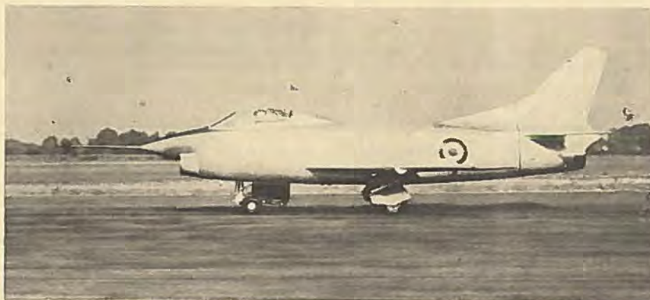
Den 9. august foretog denne Fiat G. 91 sin første flyvning i Turin. Det var denne konstruktion, der vandt en NATO-konkurrence om en letvægts-jager og blev bestilt i 30 eksemplarer til afprøvning. Den er forsynet med en Bristol Orpheus motor.
