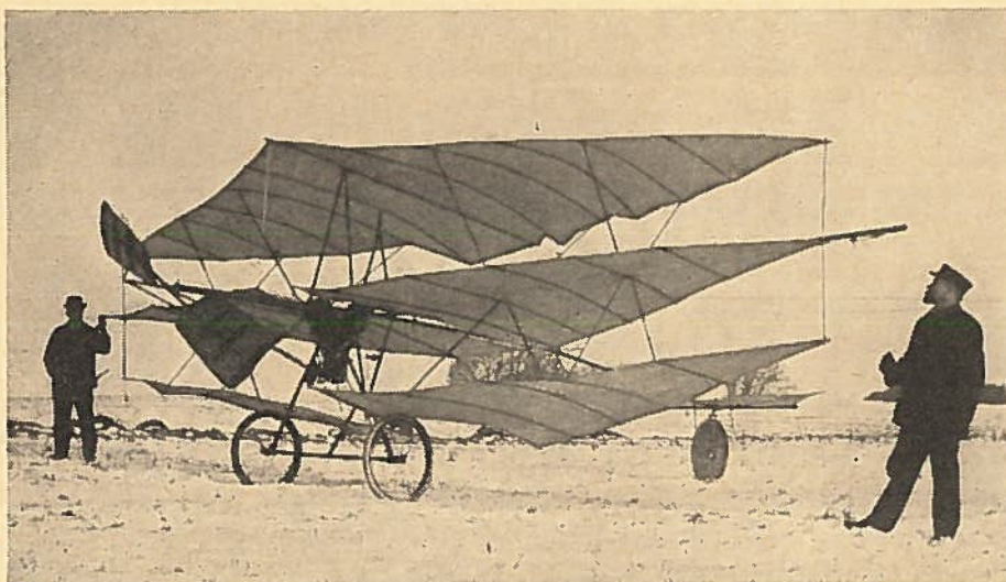
Der næst brugte han samme stel, men lavede nu et triplan. Tilsyneladende brugte han først sin anden trecylindrede motor.
