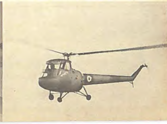
Til højre Saro Skeeter Mk 6, der også kan leveres med ekstra raketmotor, hvis tank ses i midten og udstødsåbningen til venstre.
