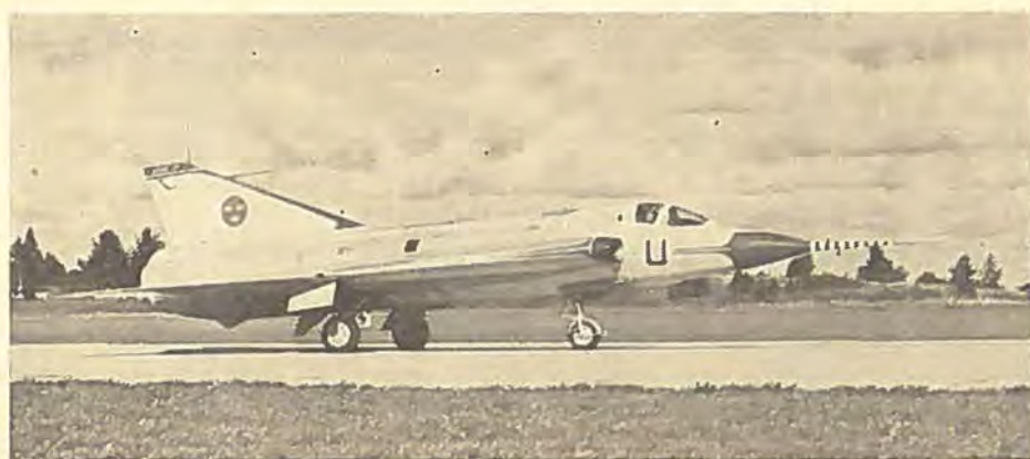
Som omtalt i sidste nummer har Saab J-35 Draken nu været i luften. Den skal afløse J-29 og ventes med sin Rolls-Royce Avon motor med efterbrænder at kunne flyve 1½ gange lydens hastighed. Planet har dobbelt deltaform.
