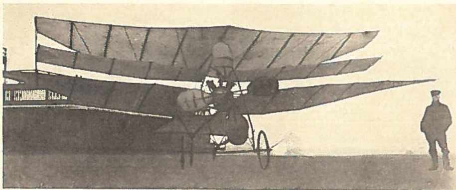
Her er de yderste plantipper skåret af de to planer, og den 5-cylindrede motor driver en firebladet propel som på 1908-biplanet.
