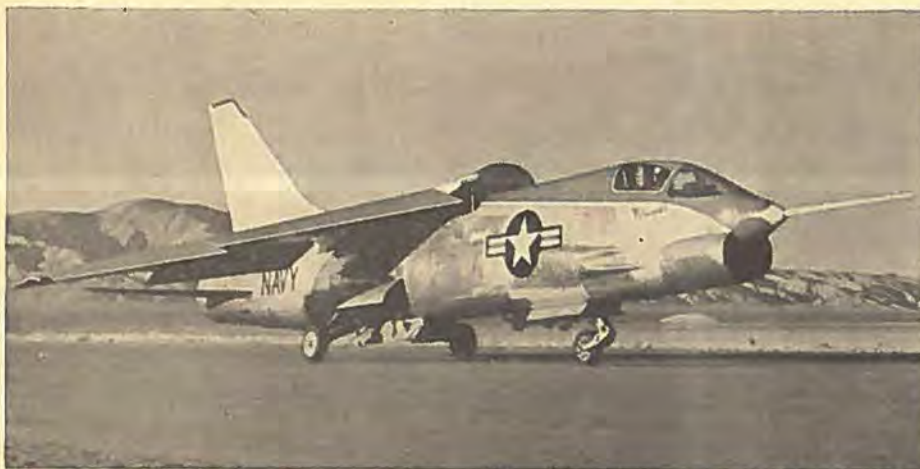
Chance Vought Crusader med planet i stor indstillingvinkel. Typen var iøvrigt beskrevet i nr 5 side 129.
