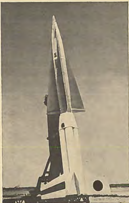
Nike Hercules er en forbedring af den nu anvendte Nike. Det er en flertårnsrakete med en rækkevidde på 65 km.
