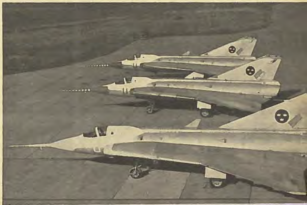
Tre SAAB J.35 prototyper på række. Draken udstyres med svenskbyggede Rolls-Royce Avon motor. Maximumfarten er ca. 1600 km/t.
