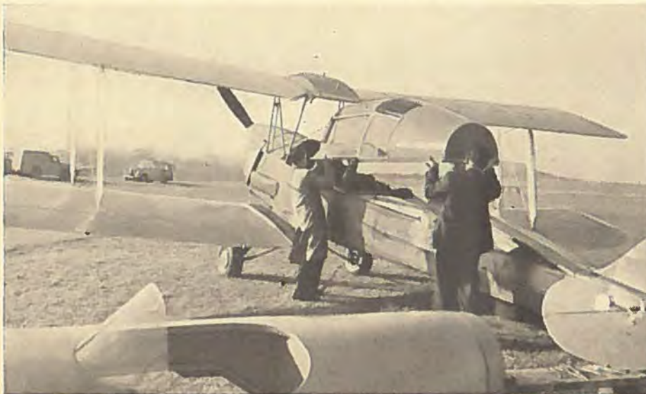
Thruxton Jackaroo — en ombygget Tiger Moth — kan hurtigt ændres fra ensædet landbrugsmaskine til firesædet privatmaskine.
