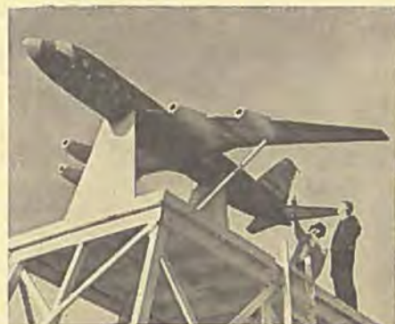
Convair bruger denne model med 5 m spændvidde til forsøg med antennesystemet på den nye Convair 440. Toppen af halefinnen anvendes som antenne. Herren til højre er Convairs elektroniske chefingeniør, W. S. Ivans, fuldt restitueret efter sit havari ved VM i svæveflyvning Ifjor.
