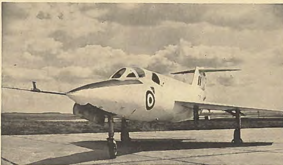
Saunders-Roe SR-53, der er forsynet både med raket- og jetmotor og betragtes som en overgangstype mellem bemandede og ubemandede jagere.
