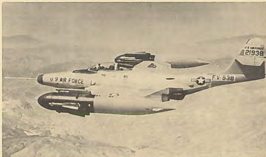
En Northrop F-89H Scorpion bevæbnet med tre Hughes Falcon på hver tiptank. De kan affyres enkeltvis eller i salver.
