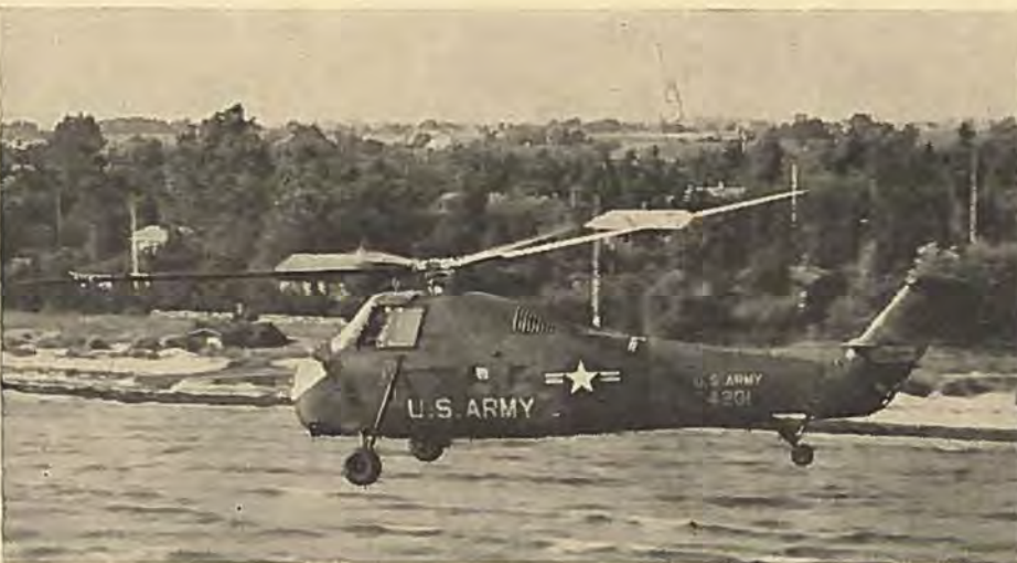
En af den amerikanske hær Sikorsky H-34 helikoptere under lavflyvning langs de danske kyster. Billedet giver ikke rigtigt indtryk af størrelsen, men der er kabine til 12 for neden og førerrum på første sal.
