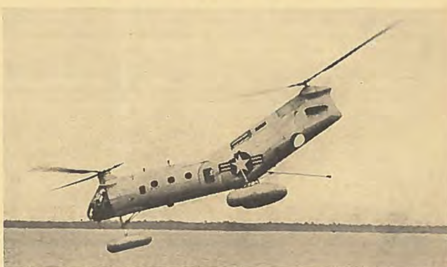
Foruden Bristol i England bygger Vertol i USA store helikoptere med to motorer, men foreløbig kun en motor. En H-21 kan slæbe skibe op til 3.000 tons.
