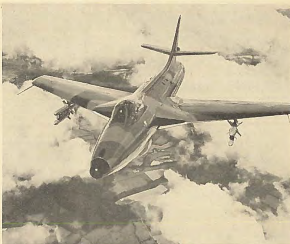
Hawker Hunter bevåbnet med to Fairey Fireflash fjernvåben under planerne.
