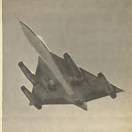
Hustler i luften lige efter starten. Der er næppe meget plads indvendig, så bombelasten ophænges i en beholder under kroppen. Farten anslås til Mach 1.7 eller 1.8.
