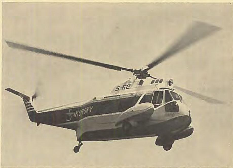
Amfibiehelikopteren Sikorsky S-62, der er udstyret med en General Electric T-58 turbinemotor.
