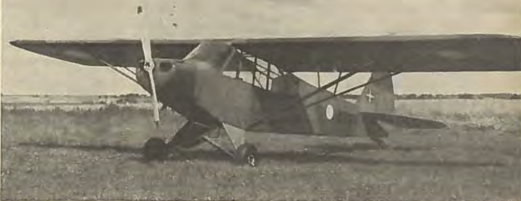
Hærens flyvemaskiner er af denne ganske enkle Piper L-18 Super Cub-type med 90 hk Continental-motor.
