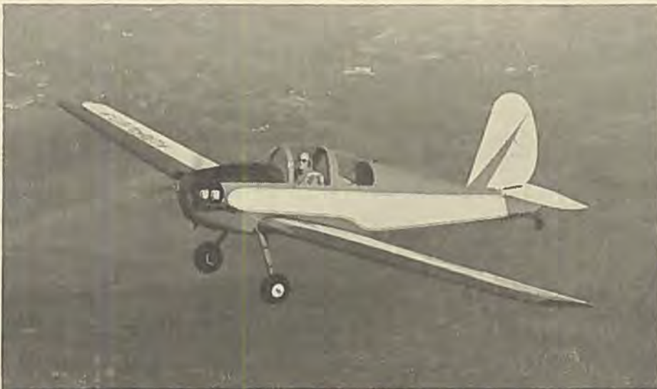
Den ensædede Schweizer 1-30, der vil blive udført som tosædet. Den anvender dele fra svæveplanet 1-26 og har på kun 65 hk fine præstationer.
