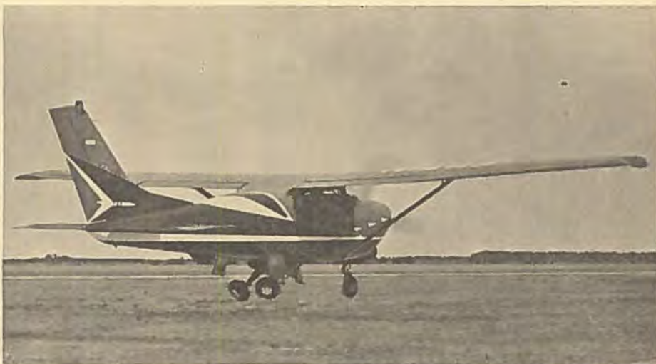
Nyeste Cessna-type er Cessna 210, der er udstyret med 260 hk Continental og rejser med op mod 300 km/t. Den er netop ved at trække understøttet ind på den særpregede måde, der fremgår af fotografiet.
