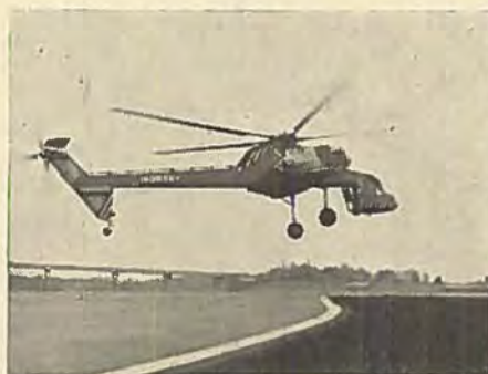
Sikorsky S-60 er beregnet som flyvende kran. Den har ingen kabine til lasten, der anbringes udenbords. Fra førerkabinen kan den styres både »forlæns« og »baglæns«, så piloten har udsigt til kranens arbejdsområde.
