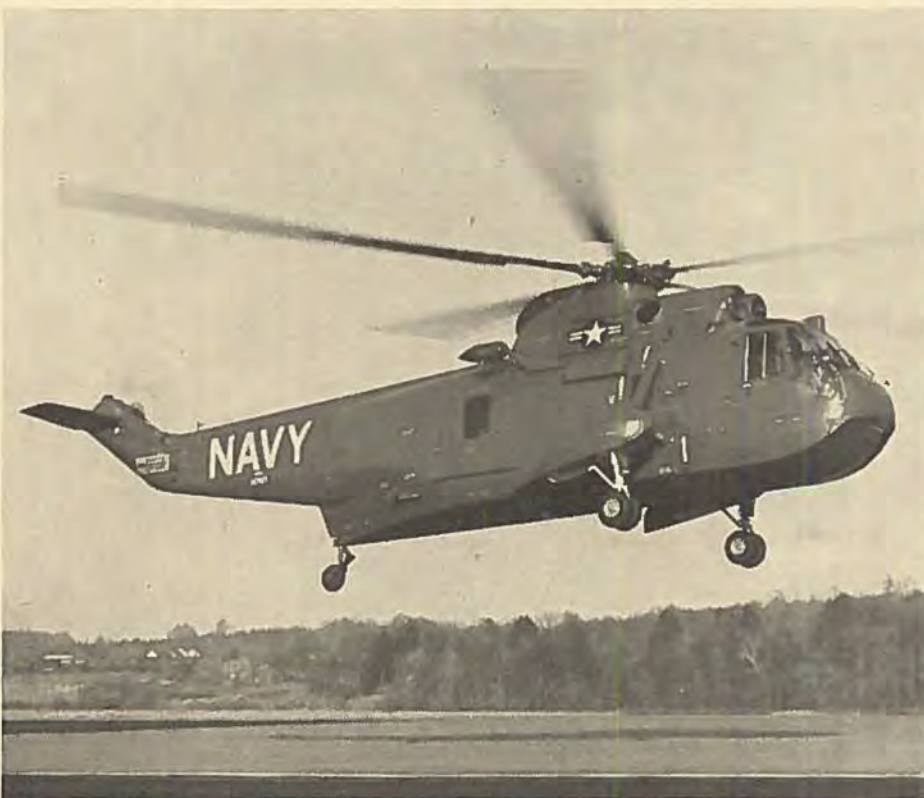
Sikorsky HSS-2 amfibiehelikopteren har to 1050 hk General Electric T-58 turbinemotorer foroven på kroppen. Det er en altvejrshelikopter beregnet til den amerikanske flåde.
