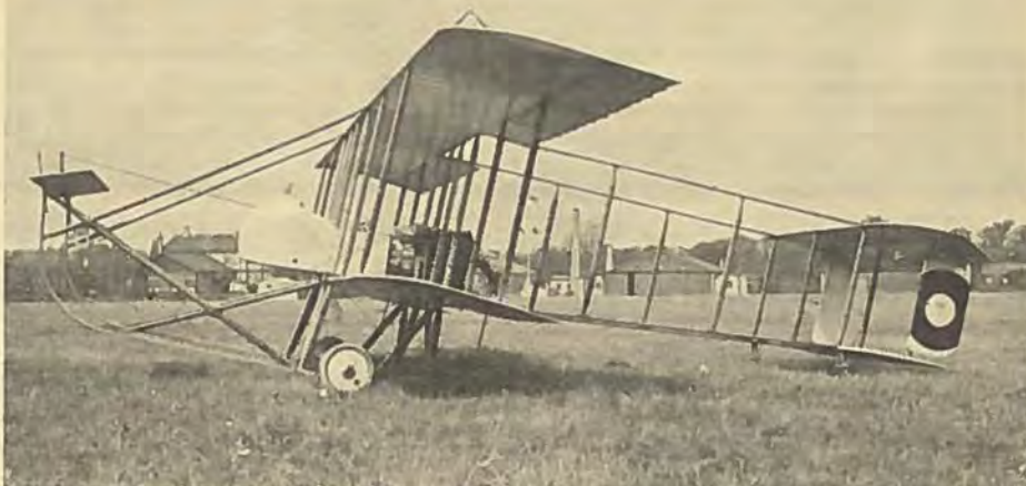
Maurice Farman-biplanet, hvormed Waage-Jensen satte længderekord med 205 km. Motoren var en 70 hk Renault og rejsefarten 90 km/t.
