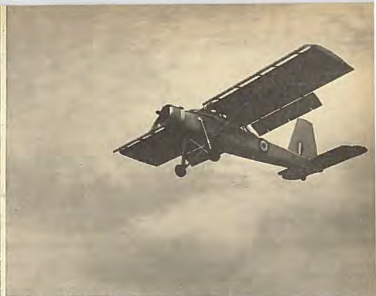
Til venstre et dejligt billede af den tomotorede Twin-Pioneer over Prestwick. Til højre ses den enmotorede Pioneer under langsomflyvning med slots og flaps ude.
