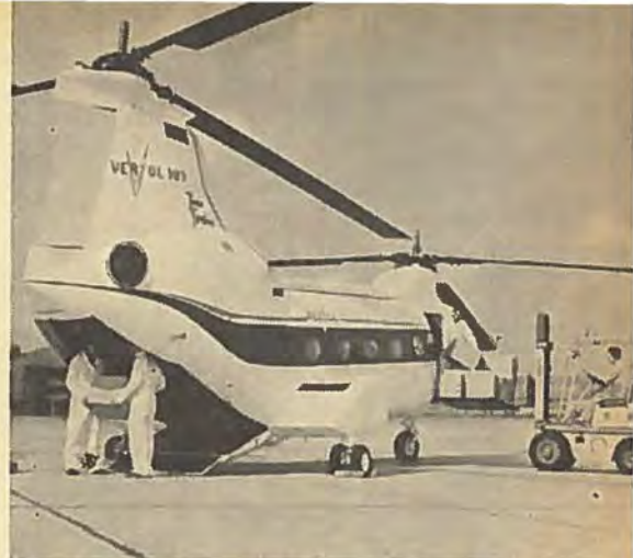
Vertol 107 med rampen i bagkroppen, hvorigennem køretøjer og andet gods kan indlades i helikopteren. Motorerne ligger øverst i bagkroppen.
