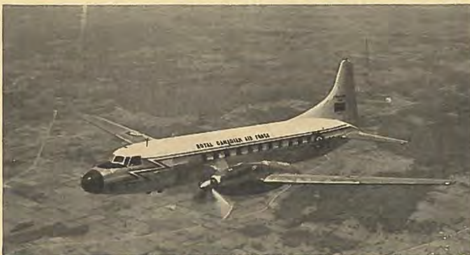
Canadair-Convair 540 er en udvikling af 440 Metropolitan, forsynet med Napier Eland turbomotorer, der medfører forøgede præstationer og komfort. Adskillige Convair ombygges til turbinemotorer. Når SAS nu forvæner sine passagerer til jetkomfort, kræver de nok også SAS's Metropolitan-flåde moderniseret!
