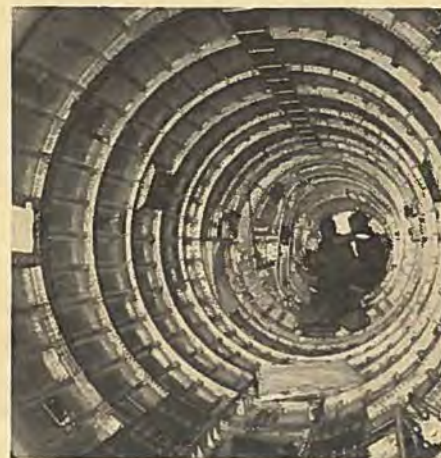
Hvad forestiller dette billede? — Kroppen til en flyvemaskine, vil de fleste mene. Det er imidlertid en af motorgondolerne til den af rustfrit stål byggede Bristol 188.
