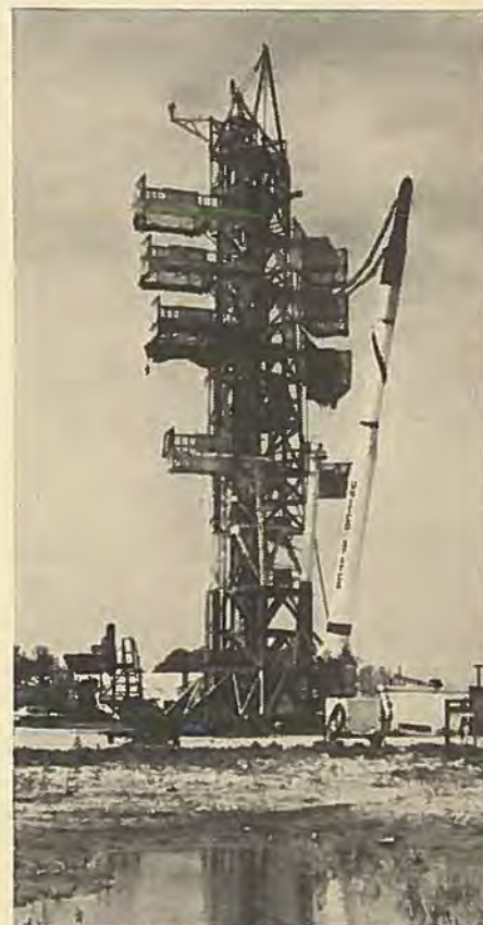
NASAs nye bæremissil til satellitter og rumsonder gøres klar til affyring på affyrsstationen Wallops Island i Virginia. Scout har 4 trin, alle med fast drivstof. Længden er 21,90 meter og startvægten ca. 16.400 kr. Når missilet tages i brug, skal det kunne bære 45 kg ind i et omløb 500 kilometer over jorden eller 22,5 kilo ud i en højde på 16.000 kilometer. USAF skal have en version af Scout. Den kommer dog til at bære navnet Journeyman.
