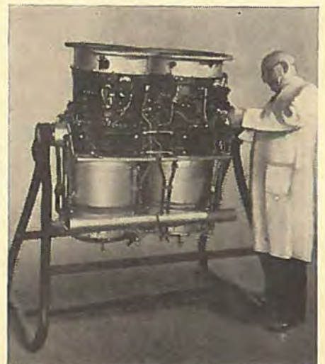
Rolls-Royce RB.108, den løftemotor der anvendes i Short SC.1 i fem eksemplarer.
