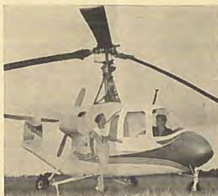
Her er til gengæld et gyroplan: Umbugh-18, forsynet med 180 hk Wyoming-motor, der driver den skubbende propel og kun før starten bruges til at speede rotoren op. Den sættes i produktion hos Fairchild og skal koste under 70.000 kr.
