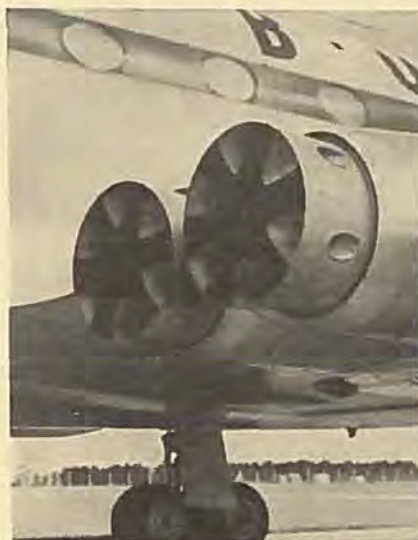
Lyddæmperne på jettfly har kostet hundreder af millioner kroner og er en fortsat økonomisk belastning ved deres vægt.
