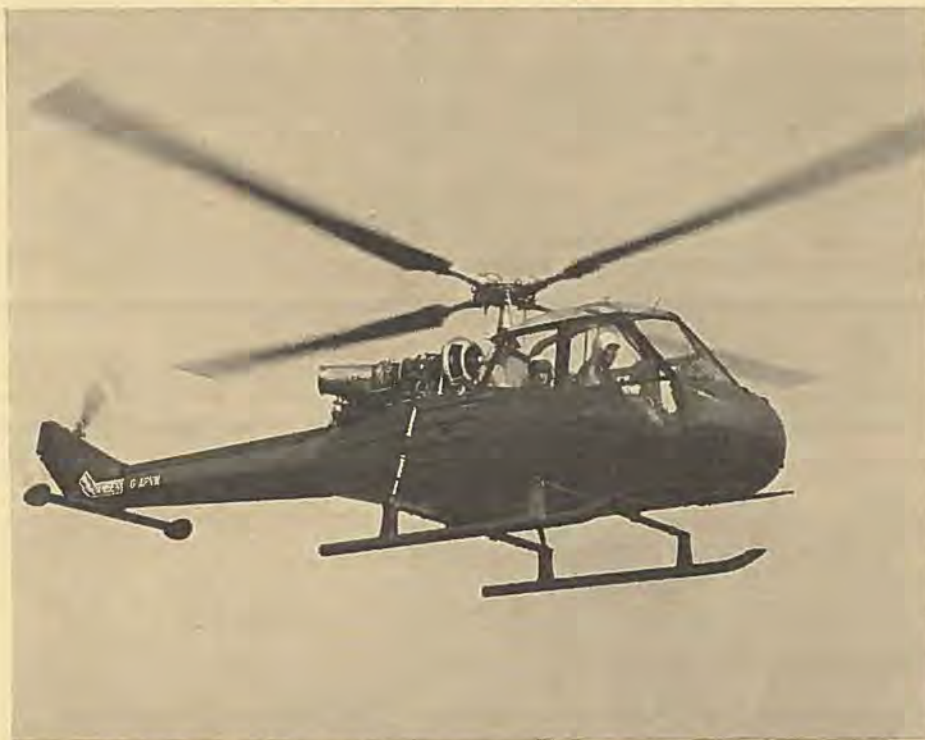
Turbinmotoren er godt på vej til at fortrænge stempelmotoren til helikopterbrug. Billedet viser Saunders-Roe Wasp, som den 3. maj foretog sin første flyvning, udrustet med den amerikanske 1000 hk motor, som de Havilland bygger under navnet Gnome.
