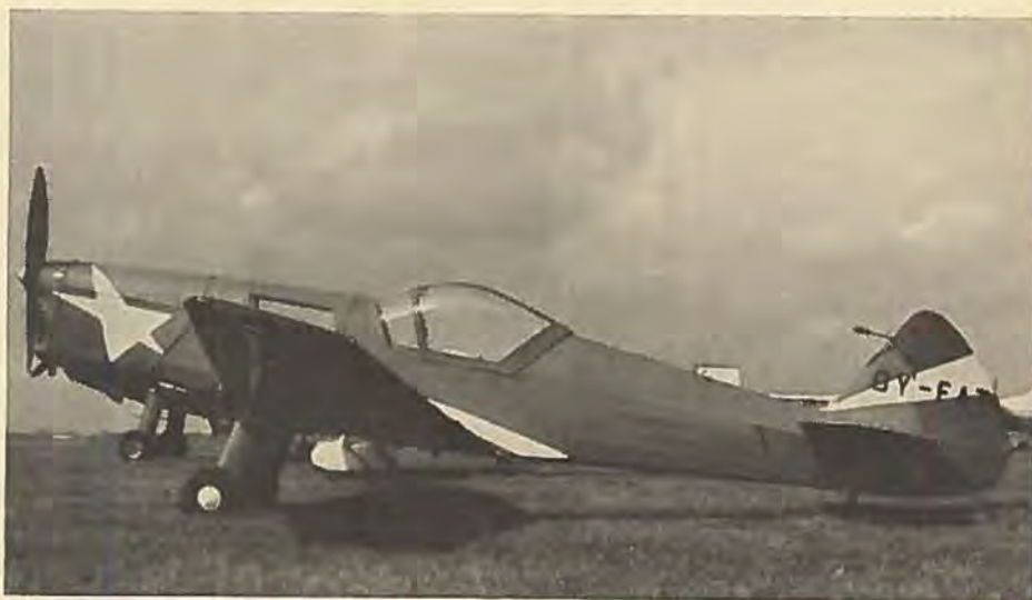
Flyvevåbnets gamle åbne KZ II Trænere anvendes civilt i forskellige lukkede udgaver. Den mest elegant er vist E. Thomsens og Bent Michelsens OY-FAT med en smuk boble over førersædet, mens forsædet kun har begrænset udsyn. Oversiden er »kunstflyvemalet« efter de bedste forbilleder.
