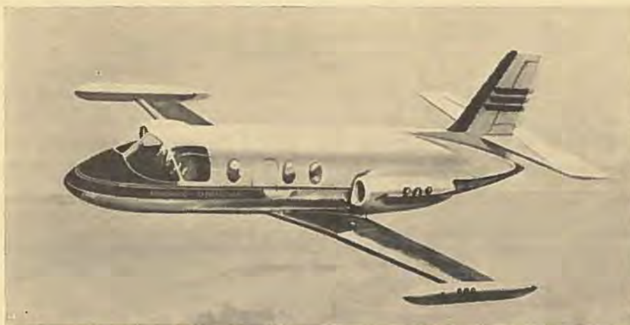
Douglas-Piaggio PD-808 følger den moderne form for flermotors jetfly, lavvinget og med motorerne anbragt på bagkroppen.
