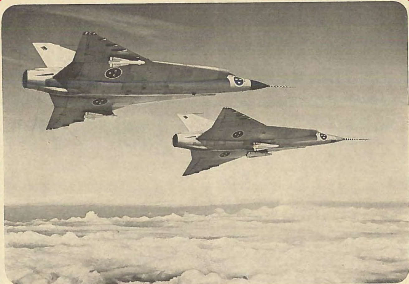
To Saab J 35F Draken med Falcon-missiler. Bemærk missilernes forskellige anbringelse på de to fly.
