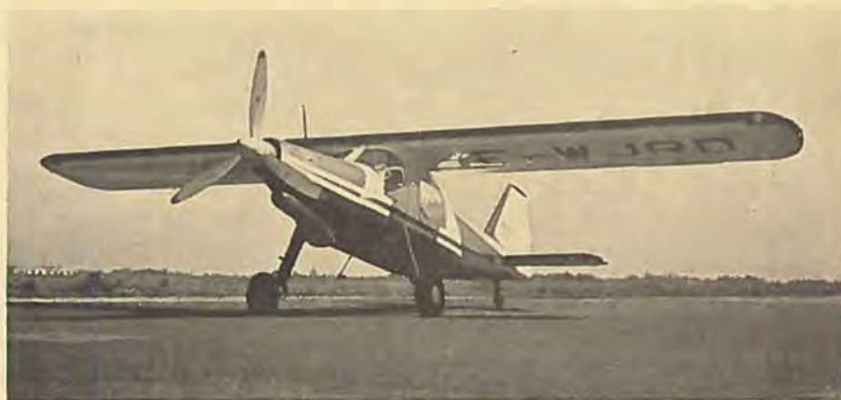
Dornier Do 27 med Astazou II turbinemotor er 85 cm længere end med den 270 hk Lycoming i standardudførelse.
