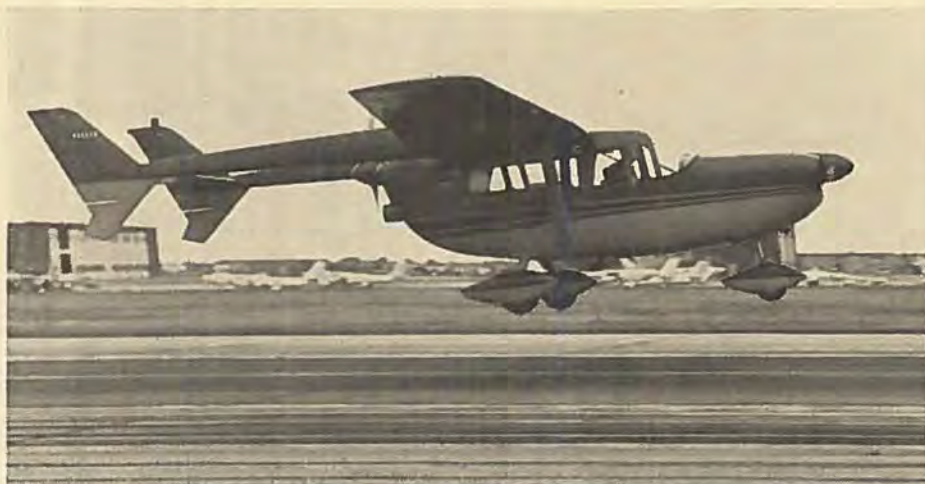
Cessna Skymaster er et uortodokst forretningsfly med to motorer, en i hver ende af kroppen, hvilken anbringelse ikke giver usymmetrisk træk ved flyvning på én motor. Den er firesædet og kan leveres næste år.
