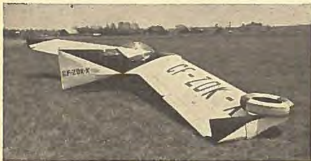
Den gamle Horsens-svæveflyver Peder Mortensen sender os fra Canada dette billede af det canadiske haløpse svævefly BKB-1. Det er kun 11,9 m i spændvidde, areal 14,2 m 2 , fuldvægt 259 kg, bedste glidetid 30 ved 87 km/t.
