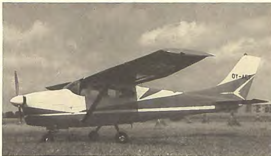
Den elegante Cessna 210. Bemærk det lave understel og de nedadbojede vingetipper.
