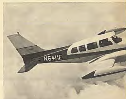
Cessna Skyknight er en videreudvikling af Cessna 310, beregnet til flyvning i større højder.
