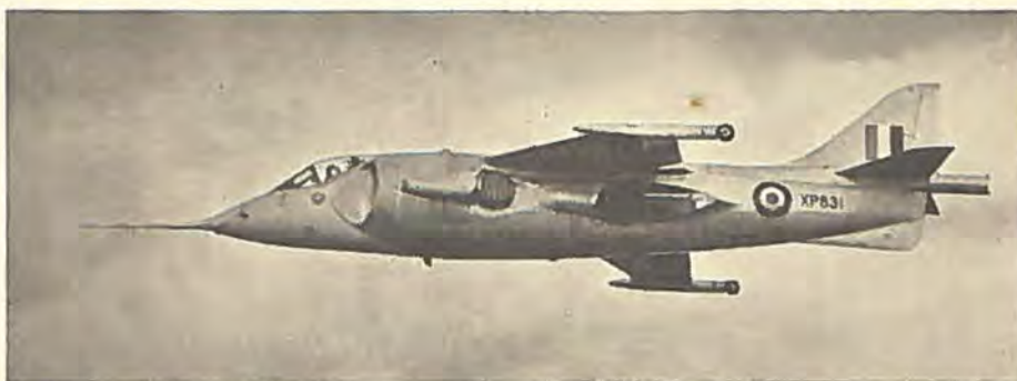
Den epokegørende engelske Hawker P.1127 er nu nået så vidt, at den ikke alene har foretaget lodret start og landing, men også flyvning på god gammeldags maner. Næste led i forsøgene bliver overgangen fra den ene tilstand til den anden.
