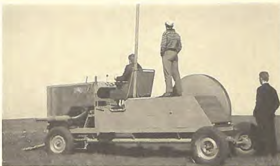
Hver svæveflyveklub mener, dens spil er Danmarks bedste, også Vestjysk, som i hvert fald har den største wiretromle. Motoren er en 150 hk dieselmotor.
