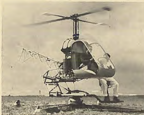
Heli-Trainer'en Bo-102, der også kan monteres på gummiponton for fri flyvning.
