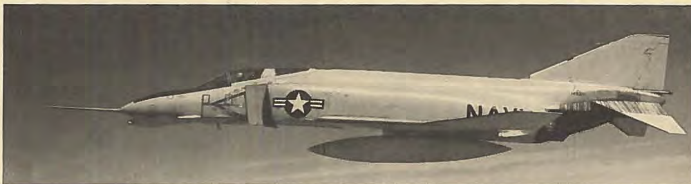
McDonnell F4H-1 Phantom II med to General Electric J-79-motorer, som ifjor satte verdensrekord på 100 km lukket bane med 2237 km/t og over 500 km lukket bane med 1958 km/t. Den er bevæbnet med Sparrow III og Sidewinder missiler.
