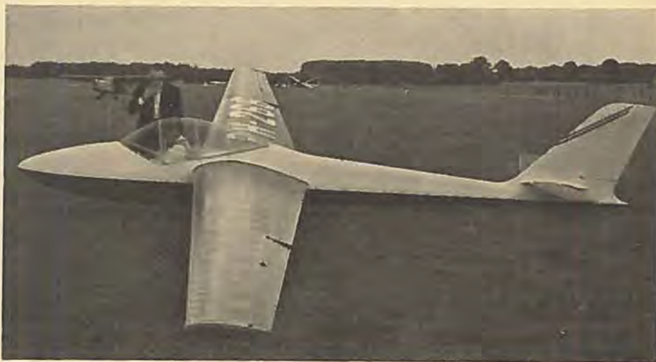
Også i Holland har man nu bygget et moderne svævefly i standardklassen, Sagitta, som er konstrueret af Piet Alsema og bygget på Teuge flyvepladsen. Mindste synkehastighed angives til 0,6 m/sek. og bedste glidehastighed til over 30. Tomvægt 216, fuldvægt 320 kg.
