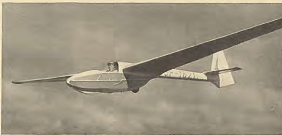
Med stålør fortil og et duralør bagtil har man lavet en robust krop, der med Mucha Standard'ens vinge giver et nyt moderne øvelsesfly.
