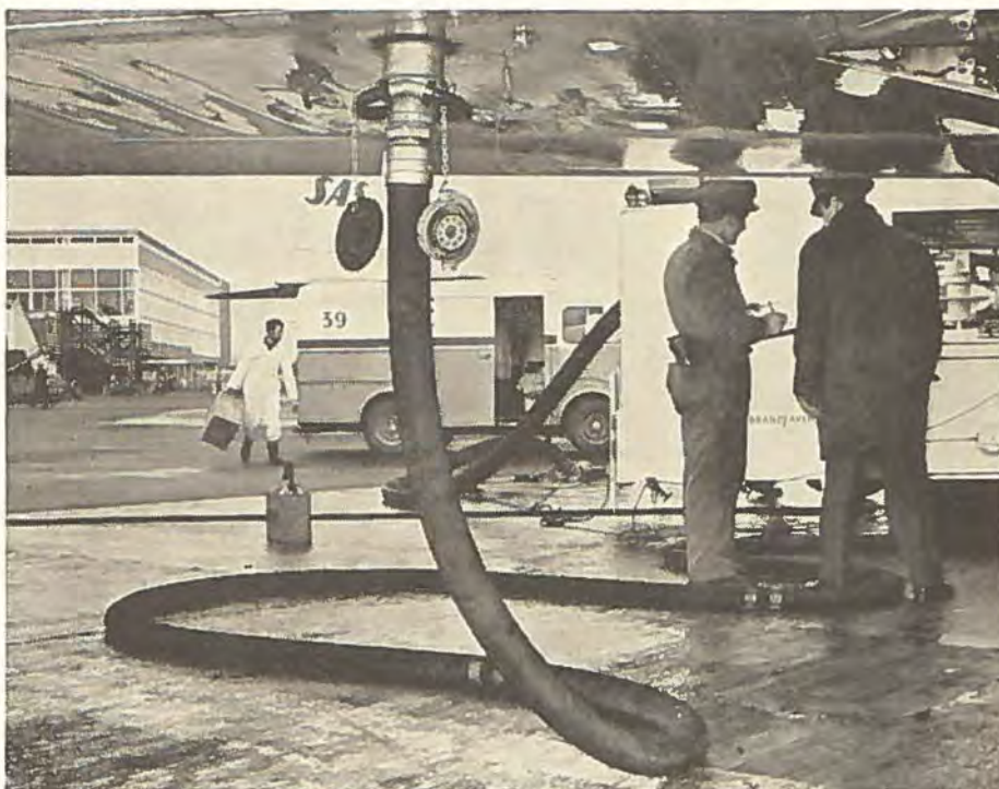
Der tankes fra hydrantanlægget i Kastrup. Moderne fly påfyldes nedefra, så man er fri for at klatre rundt på vingerne, og det er nogle voksne slanger, der anvendes.
