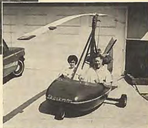
Skyscooter er et nyt amerikansk gyroplan, som kan hjemmehygges. Med en længde af kun tre meter og sammenfoldelige rotorblade kan den opbevares i enhver garage. Topfarten er 136 km/t, rejsefarten 104 km/t, og den kan flyve så langsomt som 40 km/t. Rækkevidde 400 km, tomvægt 125 kg.
