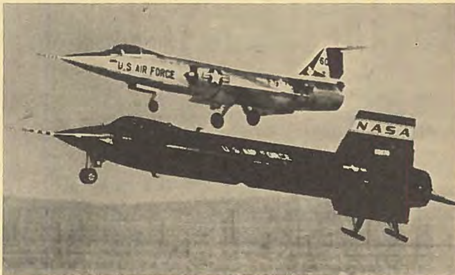
North American X-15 er kommet et godt stykke vej i sine indledende flyveprøver og ventes med stærkere motor efterhånden at nærme sig målet: Mach 7 og 160 km højde. Den glider her ind til landing, ledsaget af en F-104. Bemærk understellet.
