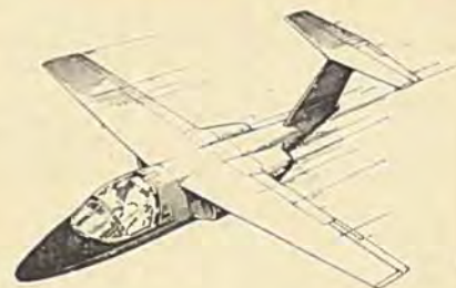
Tegning af Saab 105 jetflyet, der skal anvendes til civil og militær skoleflyvning og som forretnings- og transportfly til 5 personer.
