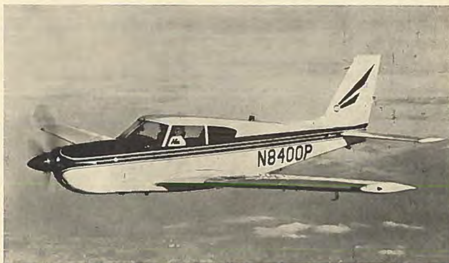
Piper Comanche 400 med 400 hk Lycomingmotor hævdes at være verdens hurtigste enmotors fly i produktion. Den rejser med op til 342 km/t, stiger med 1600 fod pr minut og har rækkevidde op til 2400 km. Pris 28.750 dollars eller ca 200.000 kr af fabrik.
