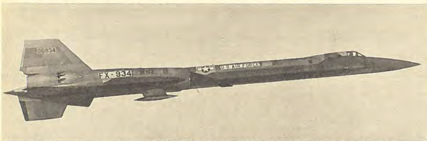
Verdens hurtigste jetfly, Lockheed A-11, som er bygget og sat i produktion i dybeste hemmelighed i USA, og som skal kunne flye med Mach 3.2. Vingeform og nærmere konstruktion har givet anledning til mangeartede gisninger. Der er i stor udstrækning anvendt titanium til bygningen.
