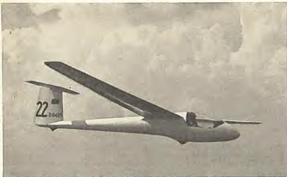
Phoebeus er udviklet af Phoenix, men bragt til at opfylde reglerne for standardklassen. Det er hovedsagelig bygget af kunststof og er sat i produktion i Tyskland.
