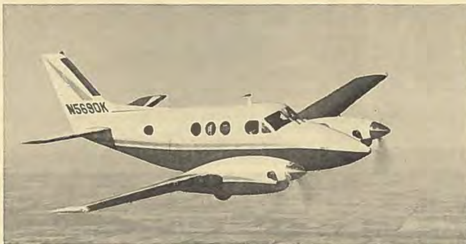
Beechcraft King Air, som vi omtalte i nr. 2, kom i luften den 20. januar, netop 27 år efter prototypen til Model 18, der endnu er i produktion. King Air flyver op til 458 km/t, rækkevidde over 2250 km. Der er ordrer for 12 mill. dollars, og de første fly leveres i efteråret.
