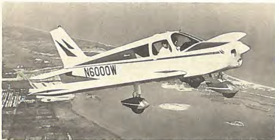
Piper Cherokee får ikke bare stærkere og stærkere motorer, men kommer nu også som tosseidet Cherokee 140 med 140 hk Lycoming motor, største rejsefart 210 km/t, rækkevidde op til 1250 km, mulighed for fuldt IFR-udstyr, pris ca. 8.500 dollars. Den erstatter Colt, der går ud af produktion i år, hvorefter Super Cub er eneste højvingede Piper i produktion.
