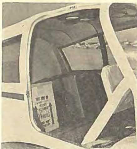
I stedet for bagsæderne i de øvrige Cherokees har 140'en en rummelig bagageplads til 45 kg bagage.
