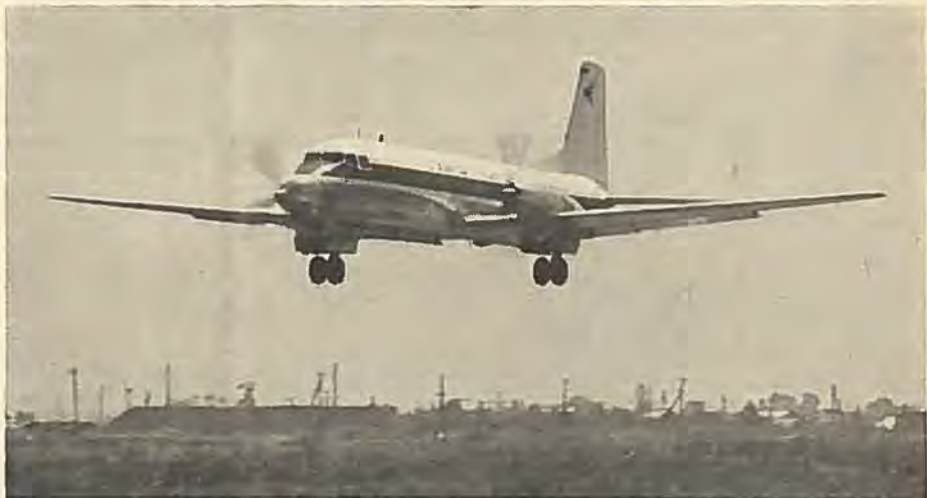
YS-11 kommer ind til landing. Dette japanske kortdistance-trafikfly er udstyret med to Rolls-Royce Dart Mr. 542 turbinemotorer.
