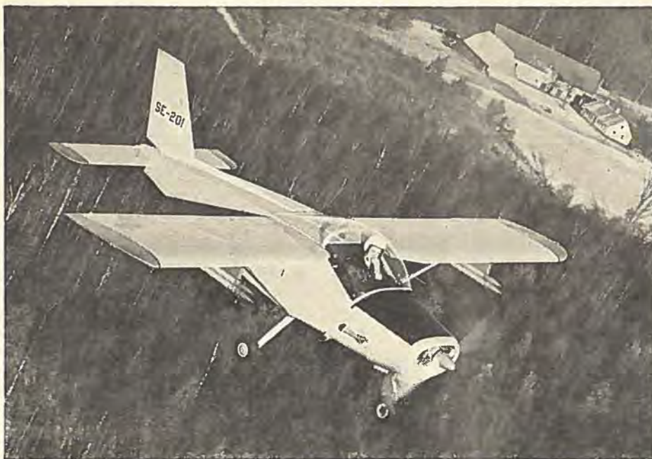
MFI Mill-Trainer (den burde have heddet Milljunior) er forsynet med nyt understel, der muliggør brug af meget ujævne marker. Under vingerne kan medføres raketter eller maskinkanoner, og i stedet for højre sæde kan monteres et kamera. Foruden til skoling kan flyet anvendes til angreb på jordmål og på helikoptere.
