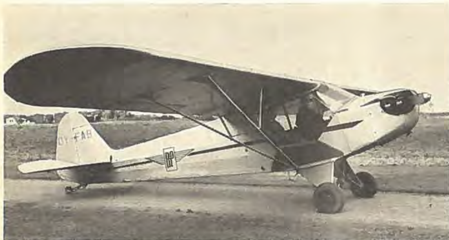
Bohnstedt-Petersen Flyveklubbens Piper Cub J 3 er forsynet med halehjul og hjulbremser, men svarer ellers nøje til de Cub'er, der blev samlet i Lundtofte for 25 år siden.
