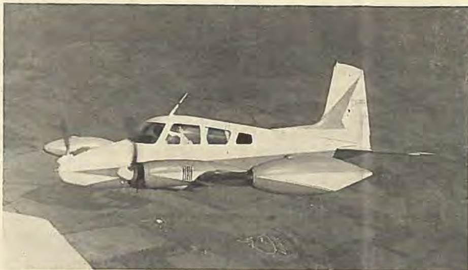
Riley 65, der er en ombygget Cessna 310 med forbedrede præstationer. (Flight foto)
