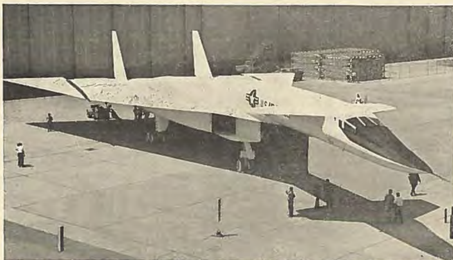
XB-70A er verdens tungeste fly (250 t) og får måske større betydning som forsøgsfly for kommende overlyds-trafikfly end som bombefly.
