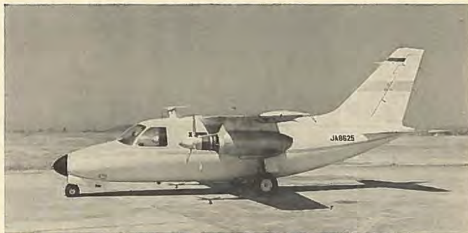
Mitsubishi MU-2, som Mooney bringer på markedet i USA, er forsynet med turbinmotorer, der i serieudgaven vil blive flyttet op i vingeforkanten.
