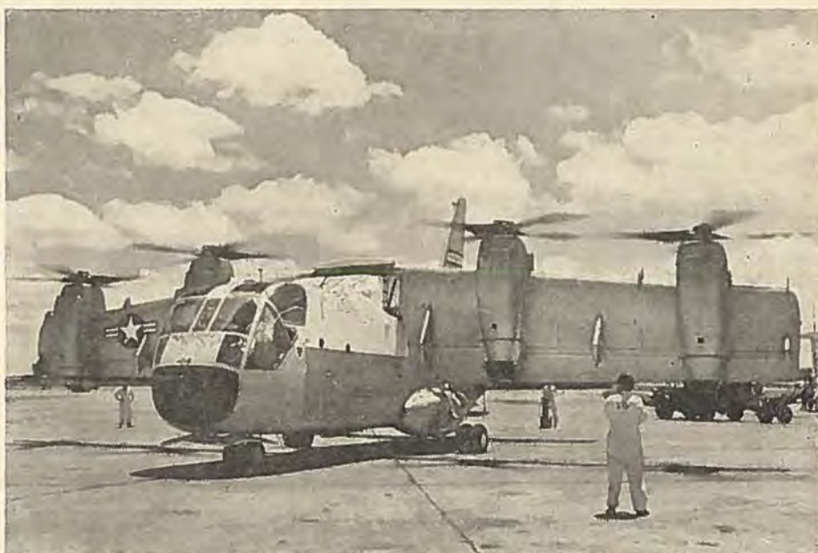
Med en fuldvægt på 17 tons og fire 2850 hk turbinemotorer er XC-142A verdens hidtil største VTOL-fly. Til vandret flyvning drejes vinge og propelaksler til vandret stilling.
