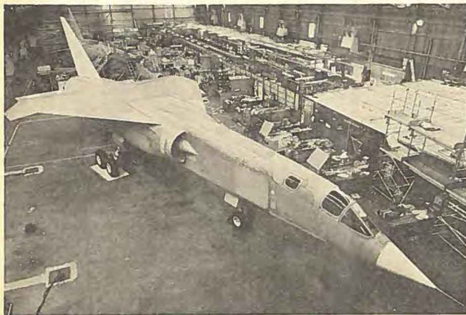
Den første TSR-2 i BAC's fabrik i Weybridge. Den drives af to Bristol Siddeley Olympus 22R motorer, er 10,5 m i spændvidde og 27,5 m lang.
