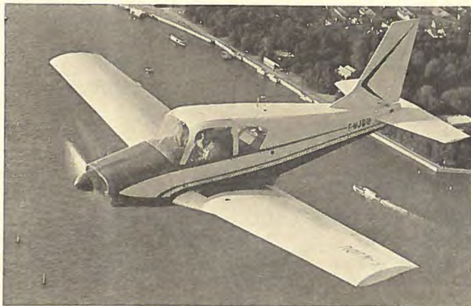
Gardan Horizon er et fransk rejsefly, der med Sud Aviations produktions- og servicemaskineri i baggrunden søger at konkurrere med amerikanske typer. Det er et lille kompakt 4-sædet fly, der rejser med op til 240 km/t.
