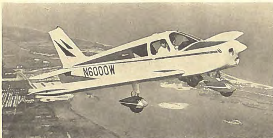
Piper Cherokee 140 er den letteste af de fem typer i Cherokee-serien. Den er to-sædet og velegnet både til træning og til rejsebrug.
