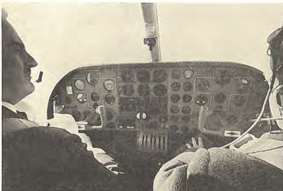
Ranald Porteous (tv.) demonstrerer B.206, som sås på forsiden af sidste nummer. Autopiloten styrer. Vi er i 3.420 feet, stiger med 1200 f/min og flyver 122 knob.
