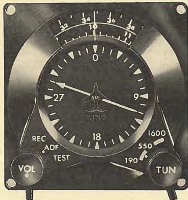
Gengivelse i fuld størrelse af King's nye radiokompas, hvor kompasviser og betjeningspanel er bygget sammen til en kompakt enhed.
