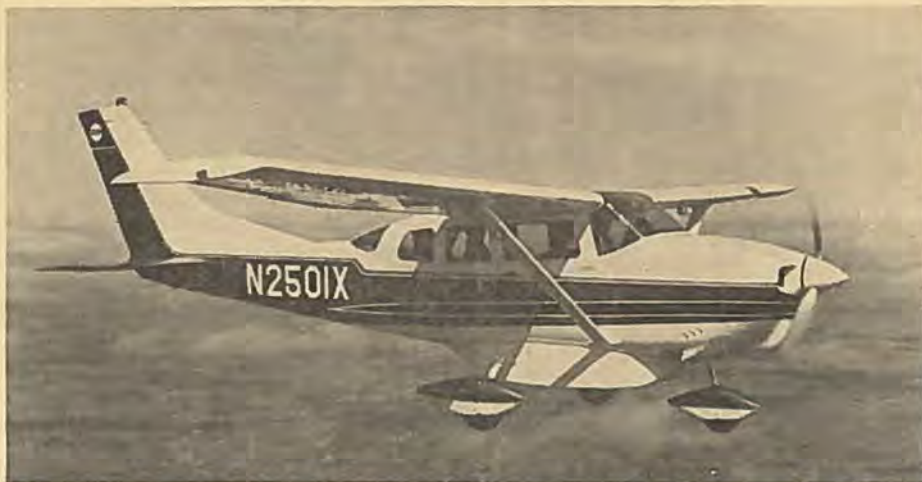
Cessna Super Skylane model 1966 forsynet med udvendig beholder til fragt eller bagage. Foruden 6 personer og fulde tanke kan den medføre 136 kg bagage.
