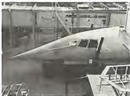
Concorde-mock-up'en med visiret oppe for frontruden som ved overlydsflyvning.
