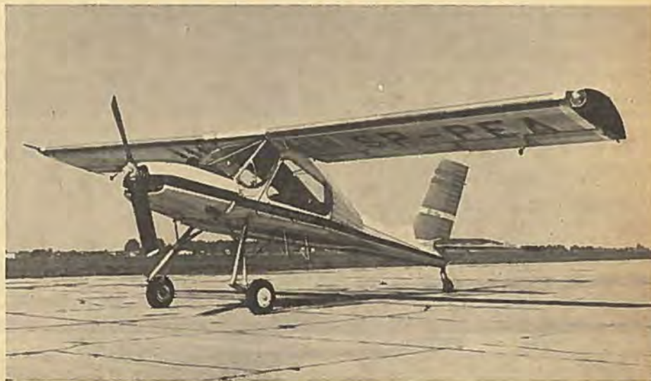
Den højbenede polske PZL-104 Wilga 2 kan bruges til mange forskellige formål. Som slæbefly er den forsynet med et elektrisk spil, der trækker slæbetovet ind efter brugen.
