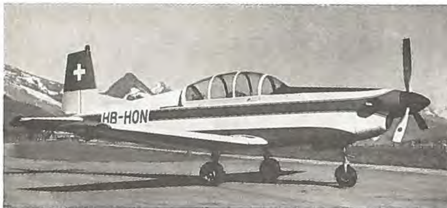
Den svejtsiske Pilatus P-3 er en ny version af en militær træner, der har fået stempelmotoren udskiftet med en turbinemotor og skal være væsentligt billigere i drift end en jettræner.
