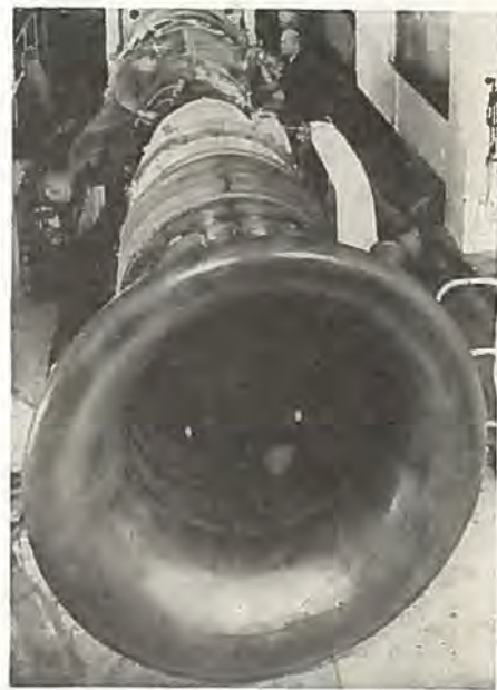
Bristol Siddeley Olympus 593B motoren på prøvestand – den skal snart prøves i luften i en Vulcan. Den yder med efterbrænder næsten 16.000 kg trækraft.
