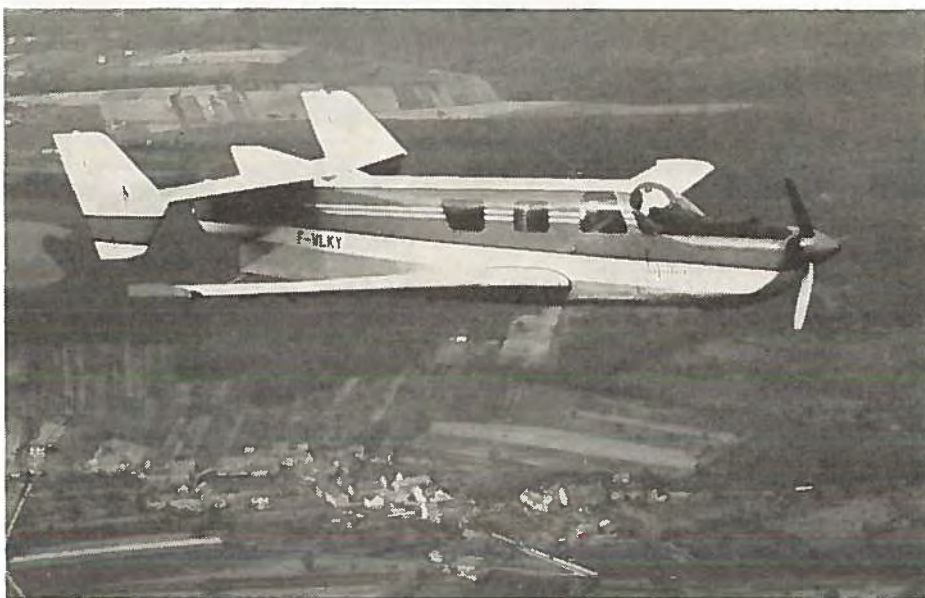
Sud Aviation M-360-6 Jupiter flyvende på agtermotoren alene. Det vil vare 1½ år endnu, inden de første produktionseksemplarer rulles ud.
