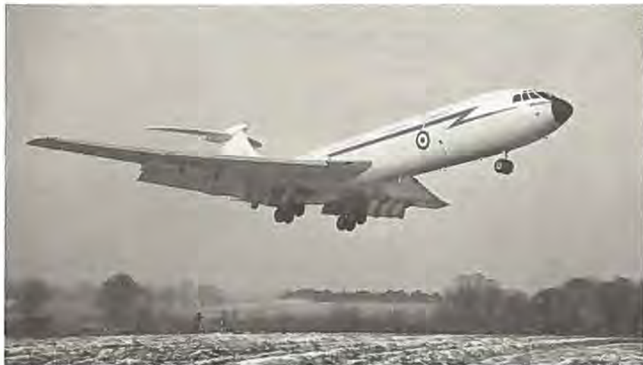
Med sine store flaps nede kommer RAF's første VC10 ind til landing. Den har fire Rolls-Royce Conway R.Co 43 turbofan motorer på bagkroppen og kan bringe tung last til flyvepladser, der hidtil ikke har kunnet modtage store jetfly.
