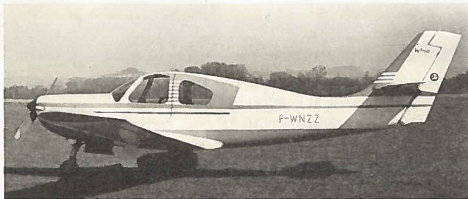
Wassmer WA-50 er et af de første motorfly, der næsten helt er bygget af kunststof. Man vil med interesse følge dets videre skæbne.
