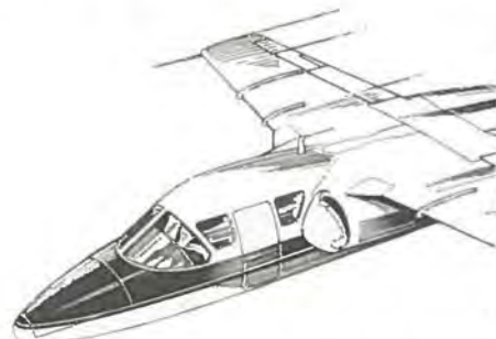
Det ændrede forparti på den påtænkte civile udgave af Saab 105C.
