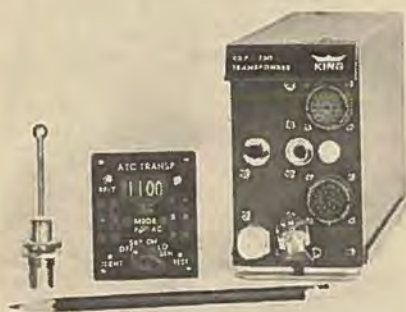
Transponderens størrelse fremgår ved sammenligning med blyanten. Den store del til højre kan anbringes hvor som helst i flyet, mens indstillingsenheden i midten anbringes på instrumentbrættet.
