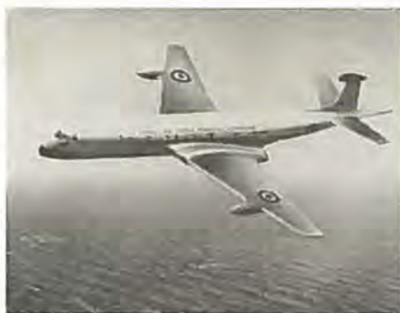
Hawker Siddeley 801 med fire Rolls-Royce Spey motorer er udviklet af Comet og skal afløse Shackleton som havrekognosceringsfly.
