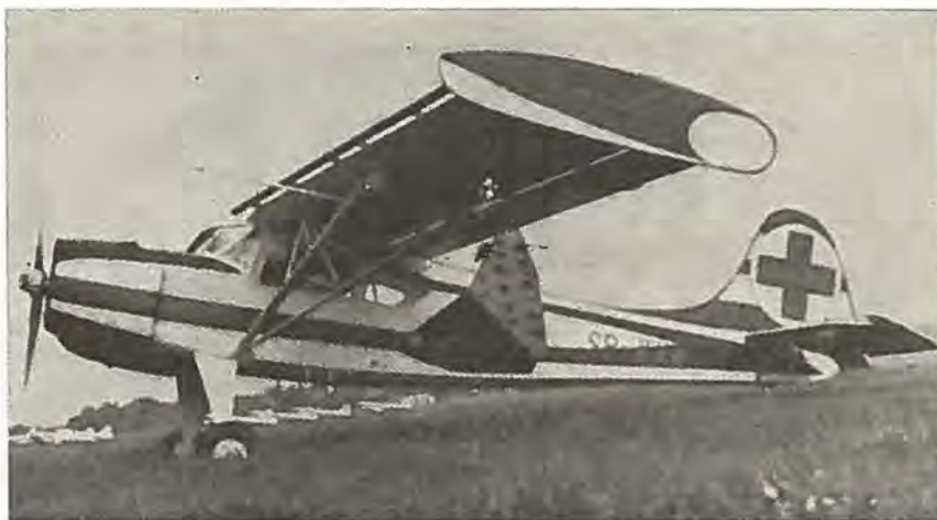
PZL-101A Gawron er ingen skønhedsåbenbaring, men et effektivt arbejdsfly, der findes i versioner til landbrugsflyvning, ambulanceflyvning og persontransport, og som også anvendes til flyslæb.
