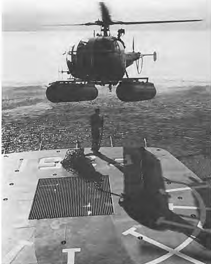
En af marinens Alouette III ved at lande på helikopterdækket af et inspektionsskib. I forgrunden den rist, som harpunen skydes ned i for at fastholde flyet til skibet.
