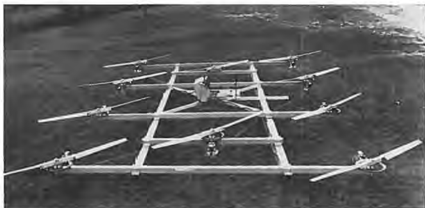
Mon ikke Igor Bensens B-12 Magic Carpet er storfavorit til titlen „verdens mærkeligste fly“. Det har 10 motorer, hver på 10 hk, og er beregnet til landbrugsflyvning.
