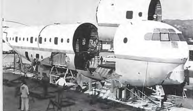
En Stratocruiser på vej til at blive bygget om til Mini Guppy.
