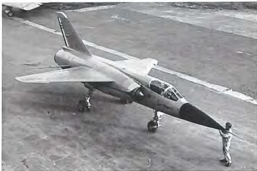
Med Mirage F har Dassault forladt deltaformen og er gået over til moderat pilformede vinger.
