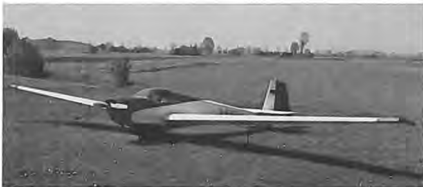
SF-25B Falke hedder videreudviklingen, der stadig har motor, nemlig en 45 hk Stamo 1400C, bygget af VW- og Porsche-dele.
