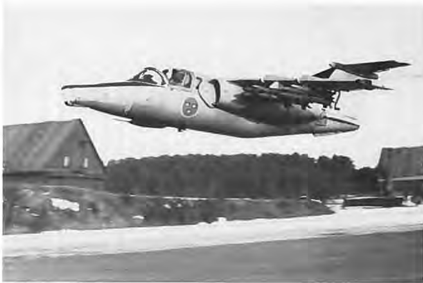
SK 60C, recognosceringsversionen af SAAB-105, har forlænget næse, der minder lidt om den på RF-101C Voodoo.
