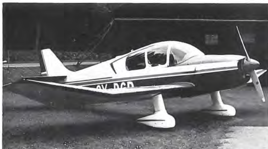
Samme vinge som tidligere Jodel-typer, men ny krop med komfortabel kabine til fire personer og ændret haleparti kendetegner DR-250 fra Centre Est Aéronautique i Dijon.
