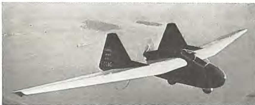
Fauvel AV-45 drives af en Hirth Solo-motor med skubbende propel, mens den to-sædede AV-221 har Rectimo-motor i næsen.
