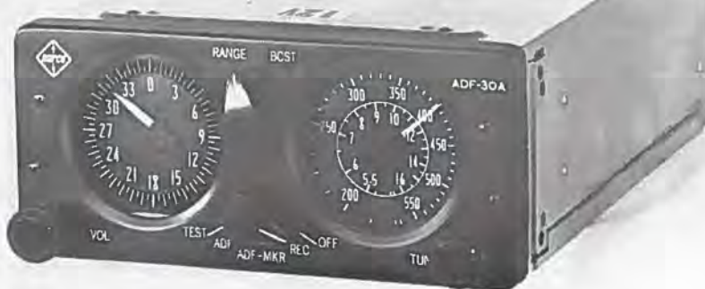
Et eksempel på et moderne radiokompas er Narco's ADF-30A. Det er transistoreret og kan drives med tørbatterier.
