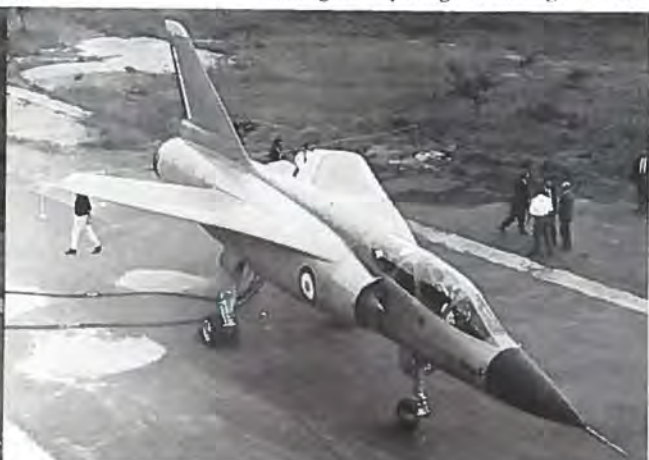
Dassault Mirage G med svingbare vinger blev vist for pressen i Melun-Villaroche samtidig med Parisudstillingen. Den er her fotograferet til FLYV med vingerne i forreste og bageste stilling (20 og 70° pilform). Den vejer flyveklar ca. 15 tons og drives af en 9000 kg SNECMA TF-306.
