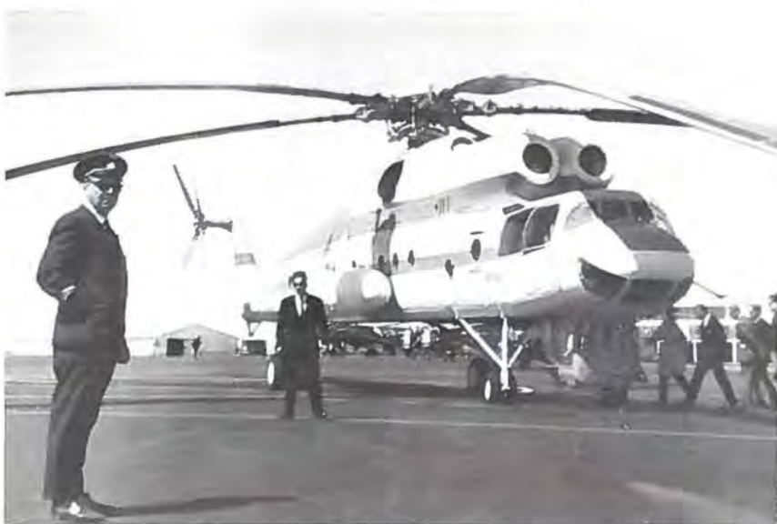
Man ser tydeligt familieskabet med Mi-10K, som er den nyeste udgave af den flyvende kæmpekran med lavere understel end den oprindelige Mi-10. Bemærk det nedhængende førerhus til „kranføreren“.
