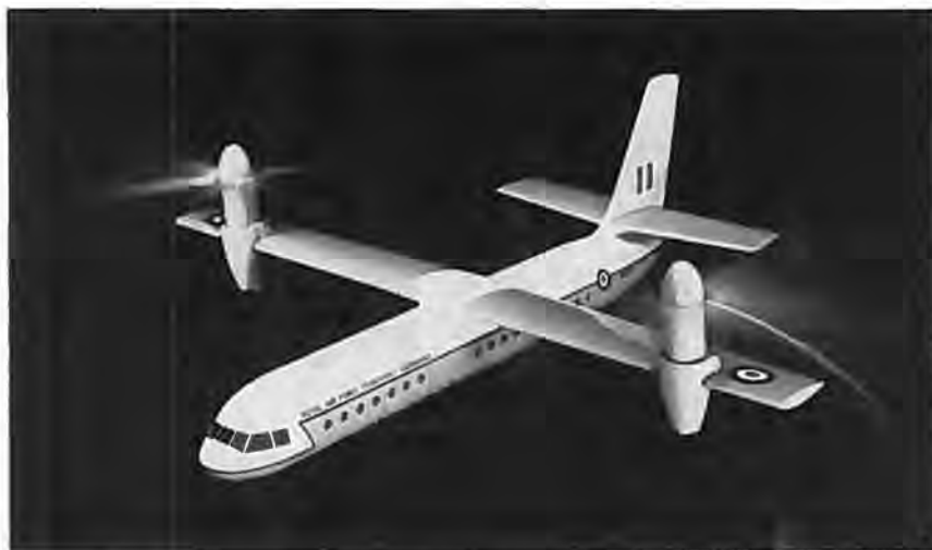
WE02 er et studie til et troppetransportfly, der kan starte og lande lodret. I stedet for at dreje hele vingen med motorerne drejer man kun disse.
