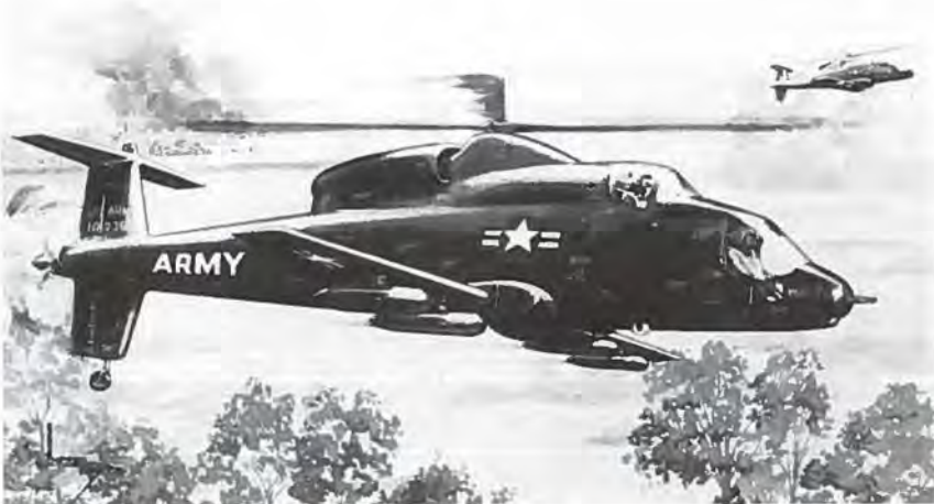
Sikorsky's AAFSS-projekt S-66 havde fast vinge og skulle under hurtig flyvning bruge halerotoren til at grave fremdrift.
