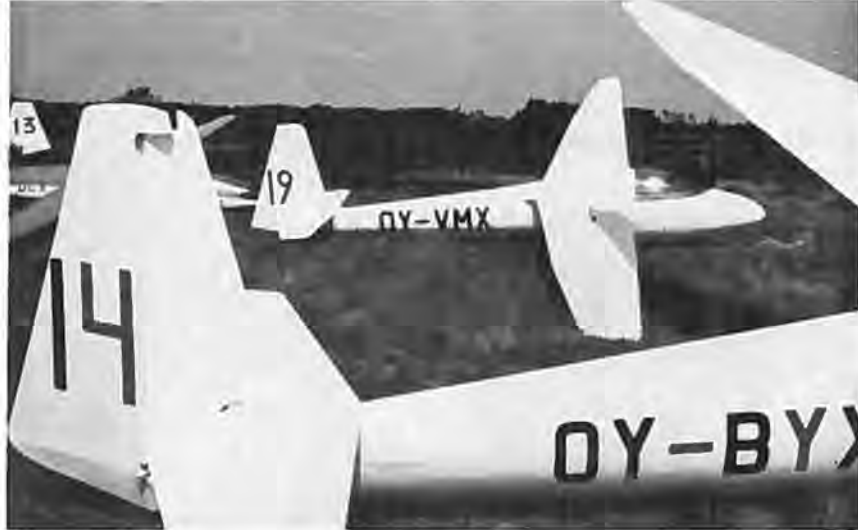
Ka-6E bag en almindelig Ka-6CR, så man kan se den lille forskel i halens udformning. Forkroppen er desuden mærkbart lavere.
