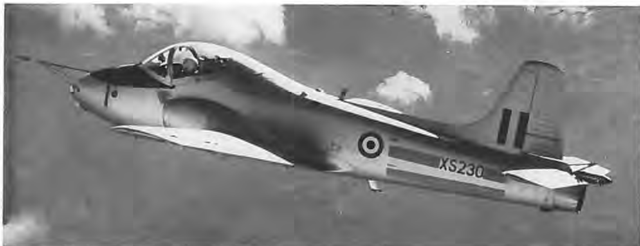
BAC Jet Provost T. Mk 5 er en ny udgave af RAF's velprøvede skolefly, der efter engelsk princip har sæderne ved siden af hinanden, og som nu er blevet forsynet med trykkabine.
