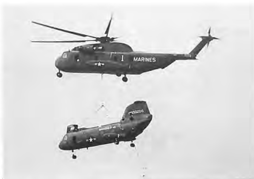
Sikorsky CH-53A er den største amerikanske helikopter, og den anvendes — som vist på film ved KDA-mødet — i udstrakt grad i Vietnam. Her er den ved at redde en havareret helikopter. CH-53A har to 2850 hk General Electric turbinemotorer, har en fuldvægt på 15.875 kg og en største hastighed på 314 km/t.
