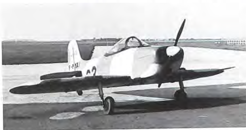
Jura MJ-2 Tempete er et ensædet fly med 6 m spændvidde, som er under bygning i to eksemplarer i Danmark for tiden. Det forsynes med en flyvemotor mellem 65 og 125 HK.
