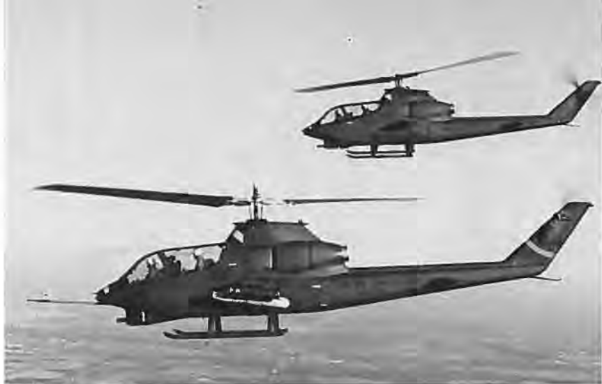
To Bell AH-1G HueyCobra, en hurtig og bevæbnet helikoptertype med to mands besætning. En 1100 hk turbinemotor giver den en største rejsehastighed på 315 km/t, og den er dykket op til 397 km/t.
