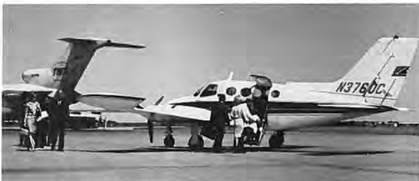
Cessna 402 er forsynet med indbygget trappe og halvtag derover. På højre side af døren kan anbringes en ekstra dør, så man kan læsse særligt fyldigt gods ind og ud af flyet.
