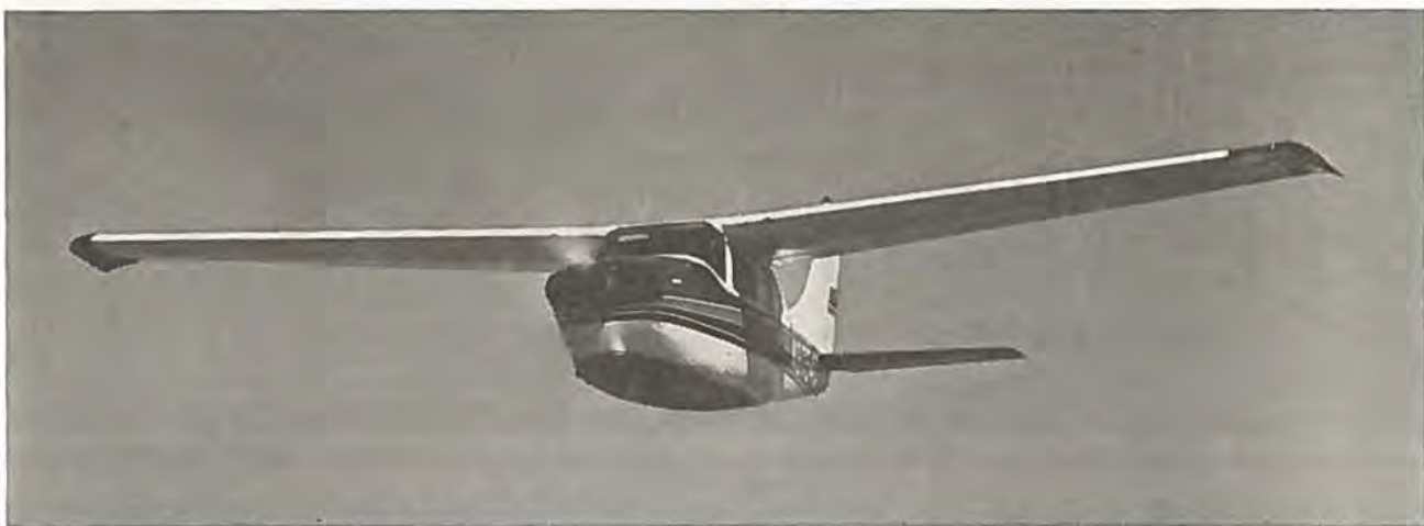
Ren og strømliniet fremtræder Cessna 210 og Turbo-System Centurion i 1967-udgaven med hjulene helt indkapslede og som noget nyt uden vingestræbere.
