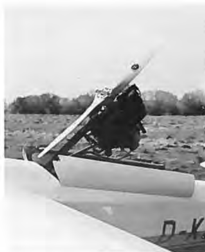
Motoren drejes ind eller ud, mens dækskærmene er åbne.
