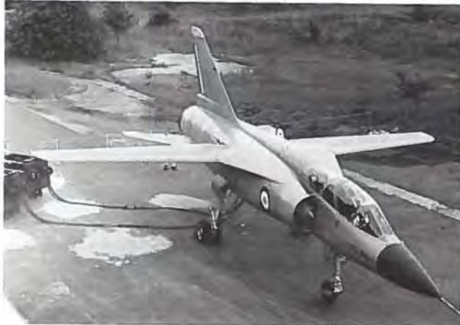
Dassault Mirage G med svingbare vinger blev vist for pressen i Melun-Villaroche samtidig med Parisudstillingen. Den er her fotograferet til FLYV med vingerne i forreste og bageste stilling (20 og 70° pilform). Den vejer flyveklar ca. 15 tons og drives af en 9000 kg SNECMA TF-306.
