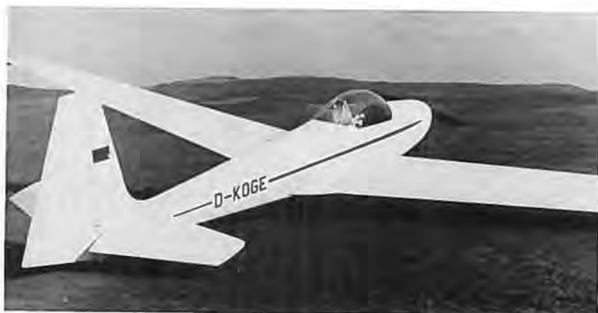
AS-K 14 kan starte uden hjælper, selv om den ene vingetip ligger på jorden før starten. Der er foreløbig bygget to prototyper.
