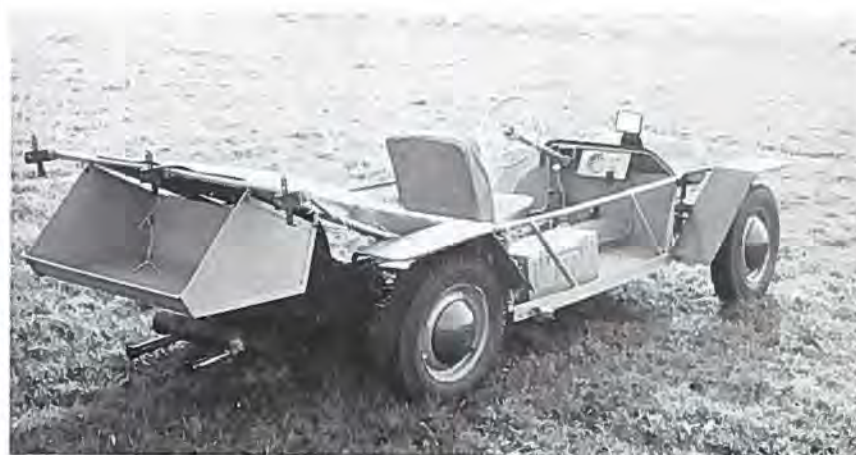
Frederikssund-Frederiksværk Flyveklub har bygget en wirehenter à la Birkerøds, men forbedret den med en wirefaldskærmskasse under de tre wireudløsningsmekanismer.
