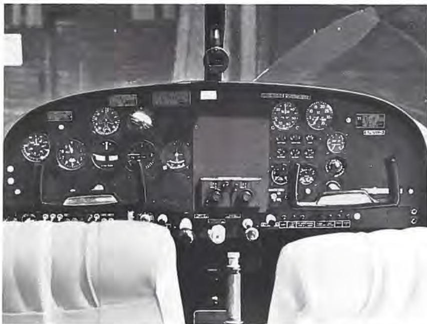
»Instrumentbrættet er sobert uden særlige raffinementer, og Marchetti har endnu ikke fulgt de amerikanere, der endelig er ved at gå over til T-arrangement af flyveinstrumenterne...«
