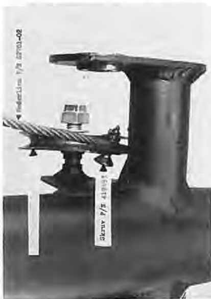
Liden årsag... stor virkning. Skruen, der kom i klemme i styretøjet.
