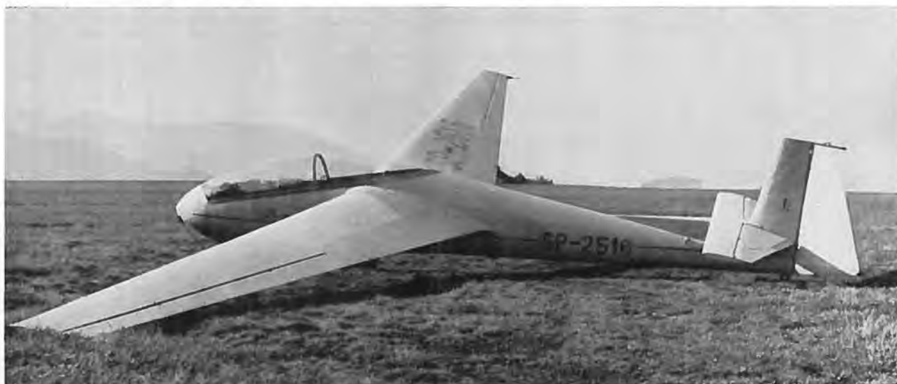
AS-W 15 bliver næste standard-type fra Schleichers stald. Den leveres fra 1969. Fuldvægt 300 kg, synker 2.00 m/sek ved 155 km/t efter beregningerne.
