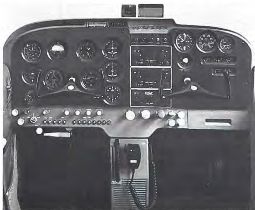
Instrumentbrættet i Reims Rocket har flyveinstrumenterne til venstre i T-arrangement, radio i midten og motorinstrumenterne til højre.
