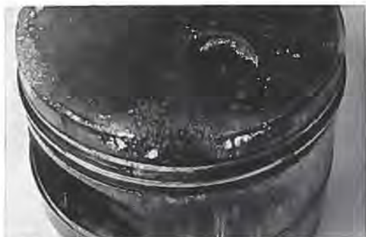
Stempelhavar! grundet tændingsfejl
