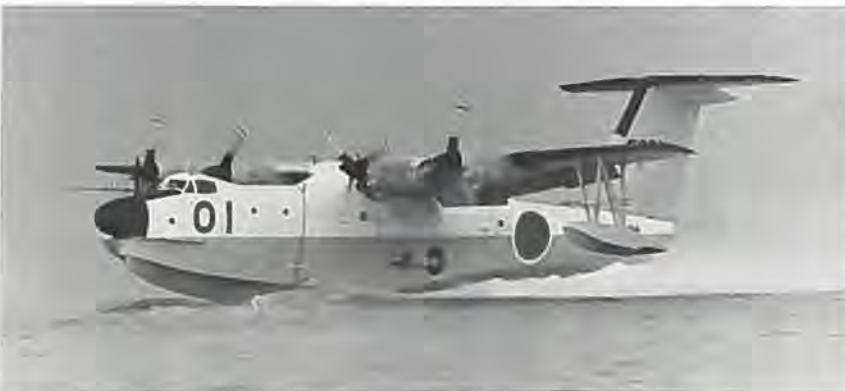
PX-S er en ren flyvebåd, ikke et amfibium. Hjulene i siden er kun til at køre op og ned ad en rampe på, ikke til start og landing, der udelukkende foregår på vand.
