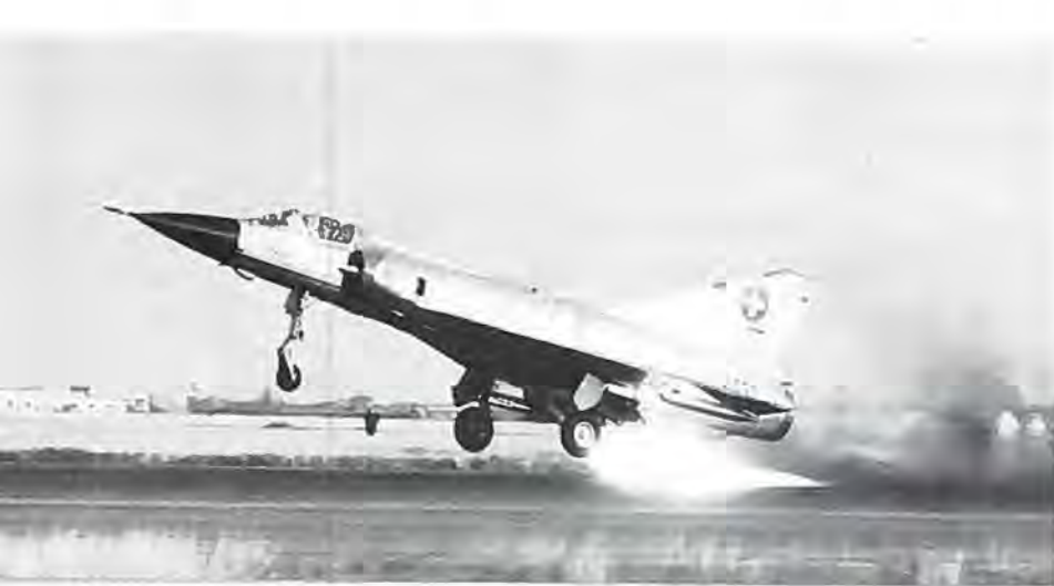
Til venstre starter en schweizisk Mirage III-S med hjælp af IATO-raketter.
