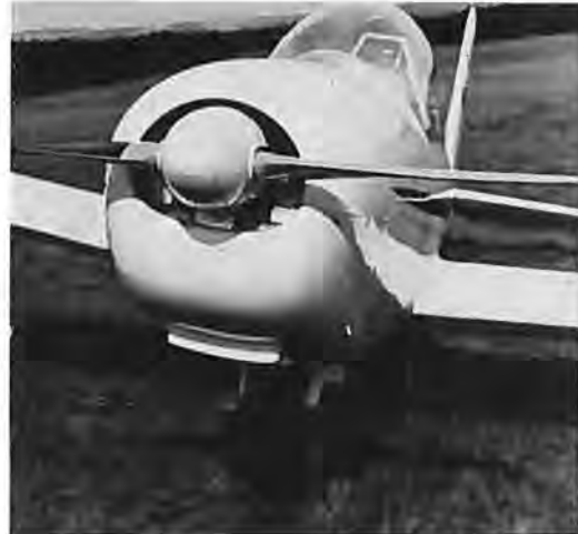
Herover ses Hoffman-propellen kantstillet, en væsentlig forudsætning for de gode glideegenskaber.
