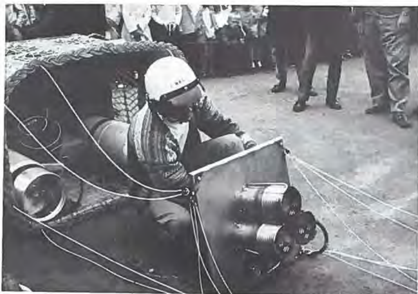
Ballonen »varmes op« ved at man med gasbrænderne sender lange flammer ind i ballonhylstret, som snart løfter sig og kurven og brænder i lodret stilling. Efter en halv snes minutter kan man stige til vejrs.
