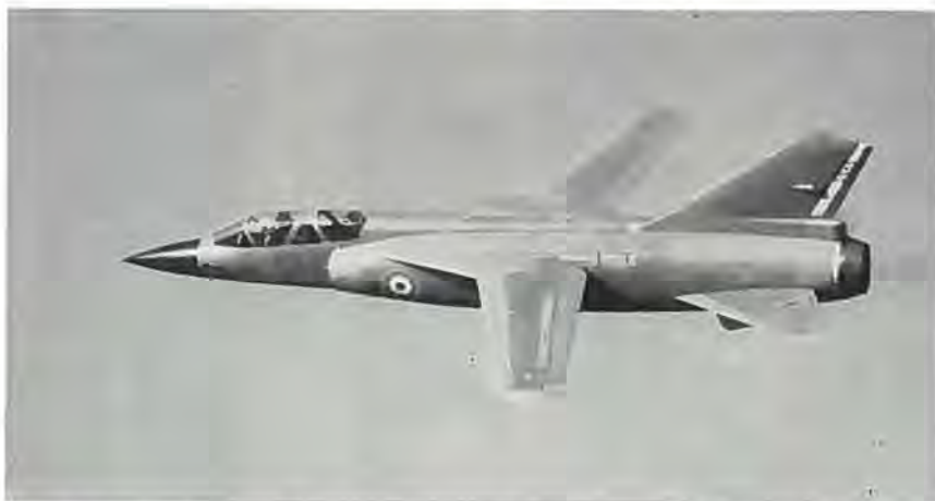
Mirage G med vingerne i forreste stilling til langsomflyvning. Vingerne kan drejes tilbage til 70° pilform.
