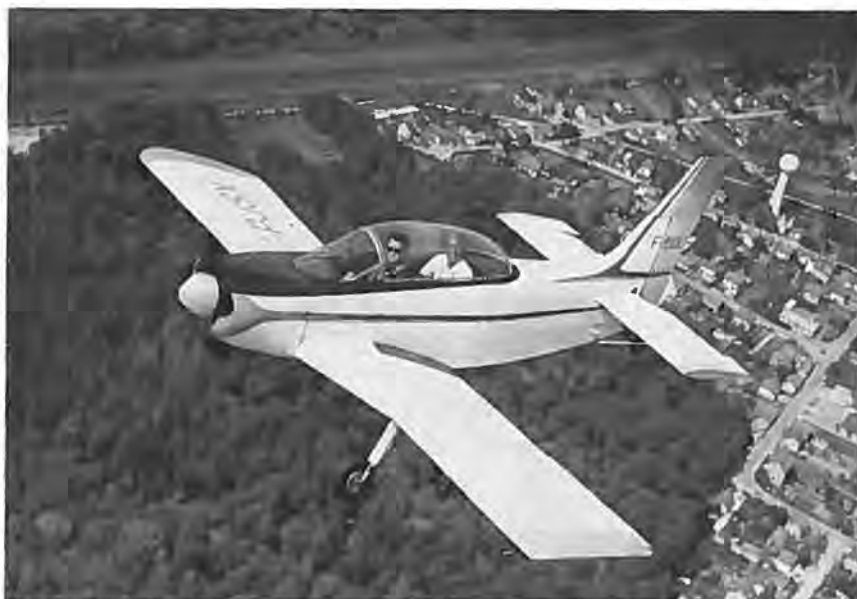
Jurca MJ-5 Sirocco i luften. Denne udgave har fast understel, men flyet kan også bygges med optrækkeligt.
