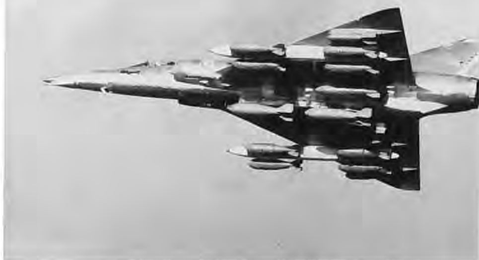
Mirage 5 kan bære en formidabel bombelast, bemærk, at der endog er ophængt bomber på ekstratankenel
