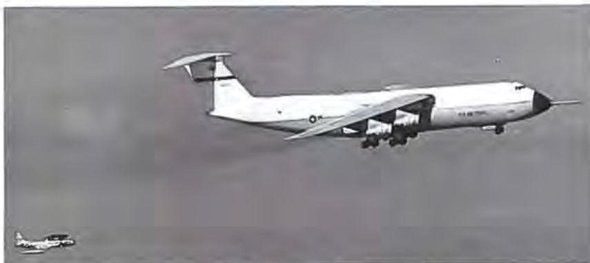
Verdens største fly, Lockheed C-5 Galaxy, fløj første gang den 30. juni og har siden øget startvægten til 252 tons, men kommer senere op på 365 tons. T-33'en nederst til venstre har væsentlig mindre spændvidde end haleplanet på C-5.
