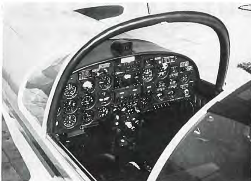
OY-DND er fuldt IFR-udstyret og anvendes som hurtigt rejsefly. Typen kan også leveres med en anden form for motorbetjeningshåndtag, der er bedre egnet til kunstflyvning.
