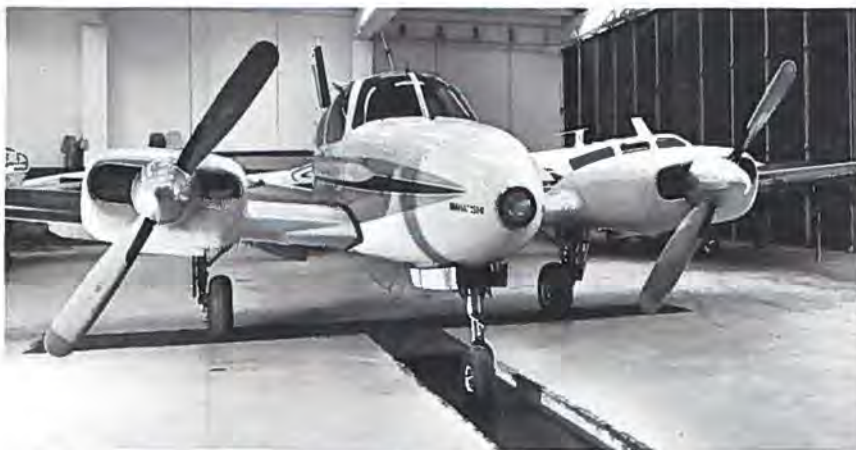
En Beech Baron på den nye brovægt til vejning og tyngdepunktsbestemmelse af fly.
