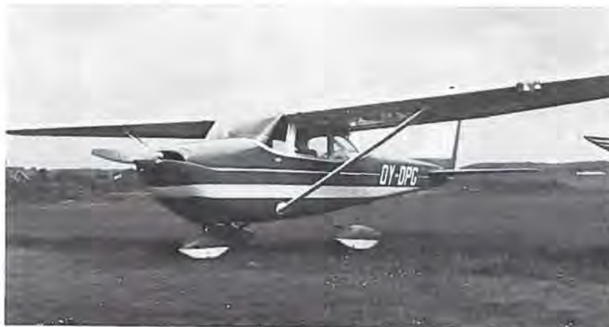
Man skal se nøje efter for at opdage, at der er en anden motor end normalt i denne Cessna 172. En af de ydre forskelle er, at udstødningsrøret går skråt bagud ved næsehjulet.
