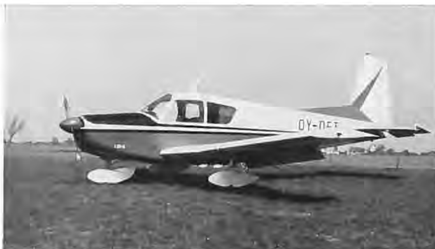
»S.205 er et lavvinget helmetalfly med en rummelig kabine til fire personer. Det er forsynet med næsehjulunderstel, og alle udgaver har constant-speed propel...«
