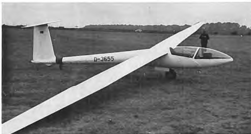
Af D-36 kom AS-12, der nu produceres hos Schleicher som AS-W 12. Spændvidde 18,3 m, længde 7,35 m. T-halens højde 1,68 m.
