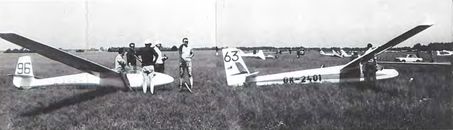
Til venstre Standard Libelle i det eksemplar, som blev fløjet af Sture Rodling. Til højre den tjekkiske M-35, hvis bagkant-luftbremse måske baner vej for brug af flaps i standardklassen.
