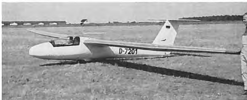
B-4 er et helmetalfly i standardklassen med præstationer et sted mellem K8 og K6.
