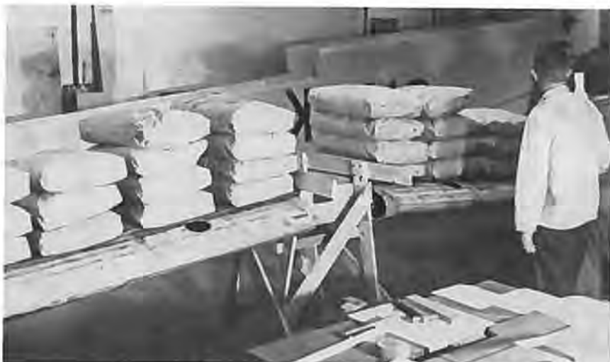
Polyt V vingen er fornylig blevet prøvebelastet med en vægt på 2600 kg, svarende til 3½ Folkevogne — den holdt fint!
