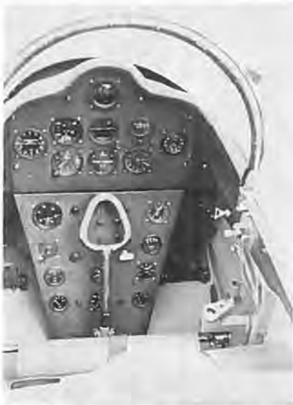
Førersædet i en Sirocco. Håndtaget for nederen til højre er til at trække understellet ind med.
