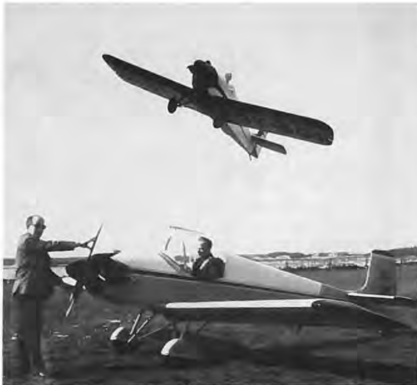
Draine Turbulent er oprindelig med åbent førersæde som på øverste billede, men de fleste bygger den nu lukket som på flyet på jorden.
