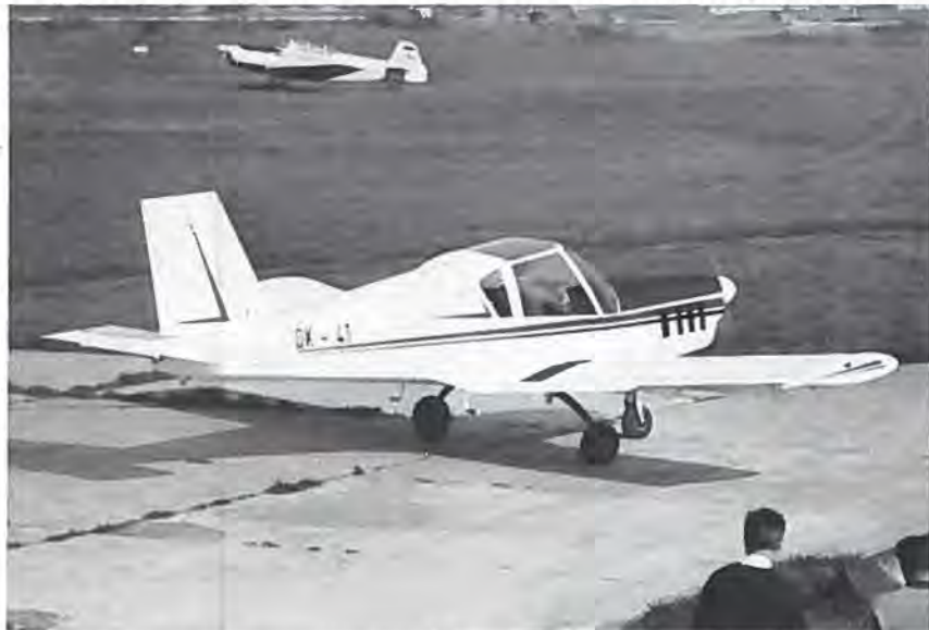
Det fuldt kunstflyvedygtige tjekkiske skolefly Z-42 er af helmetal konstruktion og forsynet med en 180 hk M137 6-cyl. række motor med direkte benzinindsprøjtning. Modsat Zlin Trener sidder elev og instruktør ved siden af hinanden. Prototypen fløj første gang 17. oktober i fjor, og det første seriefly ventes klar i slutningen af 1969.
