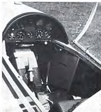
Førersædet med instrumenter, pind, parkeringsbremse, håndtag til motorstart, understel og trim.
