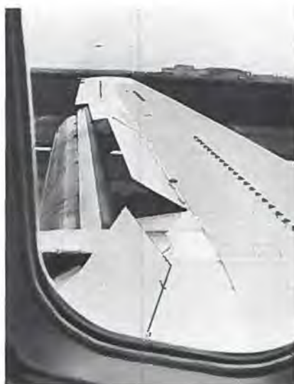
De store klapper på vingens inderste del er spoilers (lift dumpers), der kun anvendes under landing.
