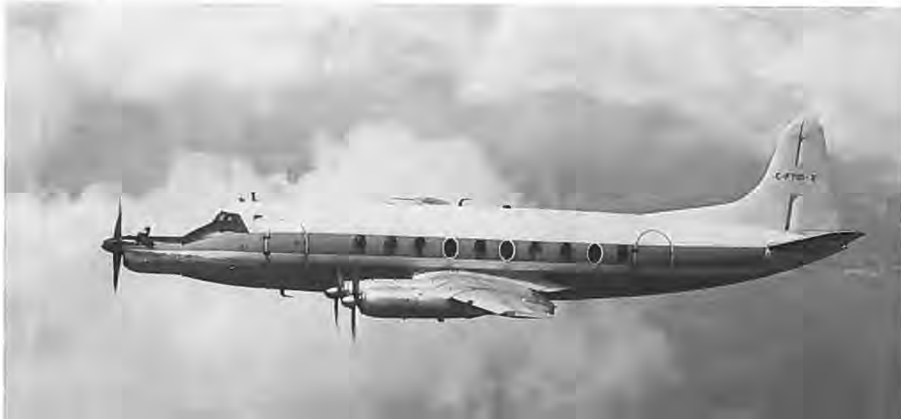
Denne Viscount er ikke blevet forsynet med en femte motor for at kunne klare konkurrencen fra nyere og hurtigere typer, men til afprøvning af en ny motor.
