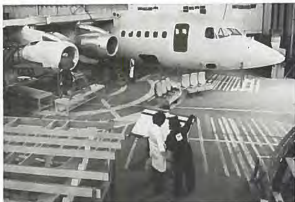
Mock-up af Hawker Siddeley 146 på fabrikken i England. Det vil kunne medføre op til 102 passagerer.
