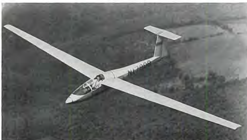
Her er Schweizer 1-35, bygget hel i metal, meget let og med mulighed for at blive meget tung ved at medføre 145 kg vand. Fine landingsegenskaber takket være bremseflaps.
