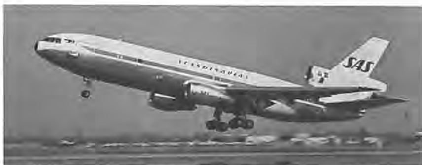
Siden Fokker F.XII og Junkers Ju 52's dage har SAS ikke anvendt tremotors fly, men det gør man nu igen med DC-10-30, blot sidder midtermotoren ikke i næsen, men i halen, hvad man næppe kunne forestille sig i de klassiske typers tid.
