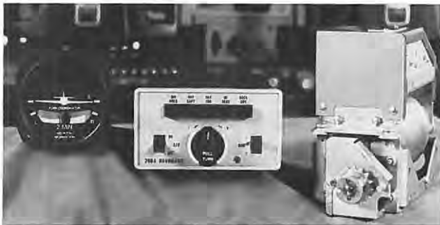
Til venstre turn-coordinator, i midten betjenings-panelet, til højre motoren, der påvirker styregrejerne.
