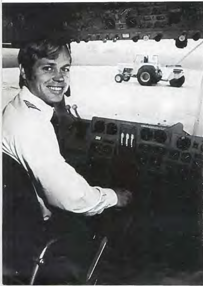
Chefpilot John Moran i forersædet på »Europa«. Håndhjulet styrer højderet, motorhåndtag sidder yderst til venstre, alm. og specielle instrumenter foran ham, ventilhåndtag lige over frontruden. På det øverste panel er der bl. a. radioinstallation.
