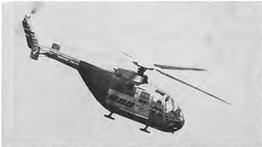
Messerschmitt Bölkow Blohm har ved aerodynamiske forbedringer fået sat hastigheden betydeligt i vejret på denne Bo 105 HGH.
