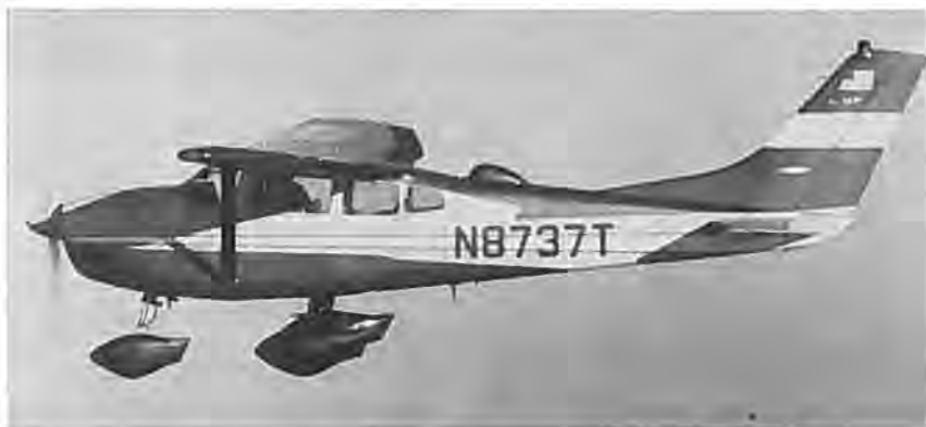
Hjulskærmene på denne Cessna 182C lukker sig helt omkring hjulene efter starten og hæves at øge hastigheden med 16 km/t.
