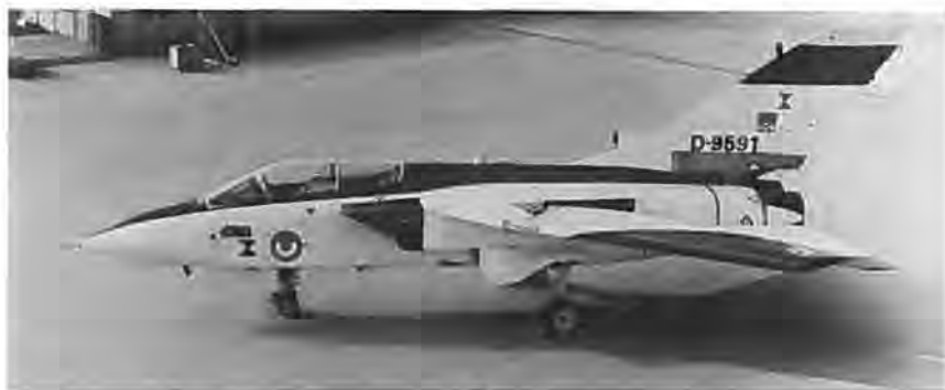
Det alsidige fælles-europæiske kampfly MRCA med svingvinger vil blive anvendt af flyvevåbnene i England, Tyskland og Italien til forskelligartede opgaver.
