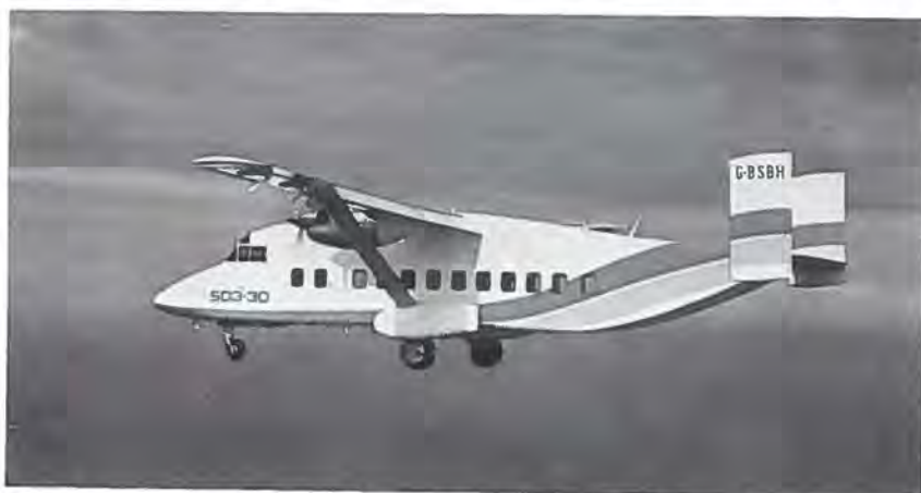
Blandt de nye fly på Farnborough var denne Short SD3-30 - et kortdistancefly til 30 passagerer, forsynet med to turbinemotorer.
