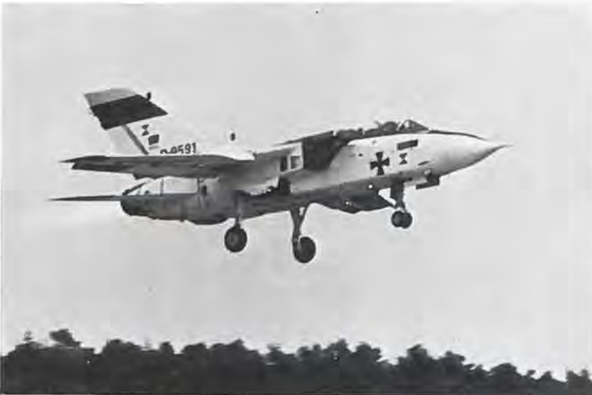
Det første MRCA-fly i luften. Svingvingen er her udstrakt til langsom flyvning, men kan drejes bagud til hurtigt.
