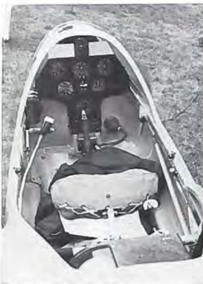
Cockpit'et i PIK-20 med mikrofon og flaphåndtag i venstre side og understelhåndtag i højre
