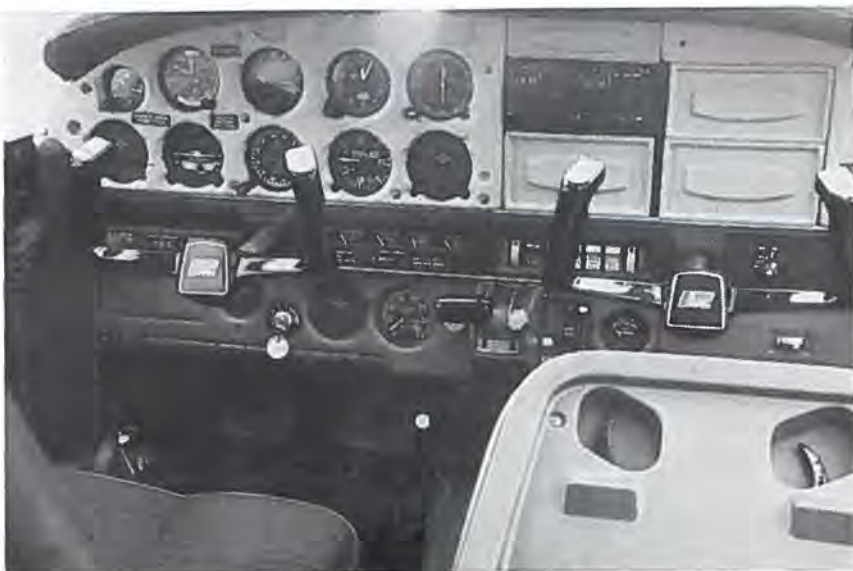
Instrumenter og betjeningshåndtag i Cherokee Warrior.
