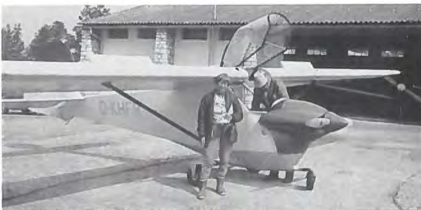
Den pudsige Hankur 1, der er udviklet af en Doppelraab 7 og forsynet med Limbach-motor.
