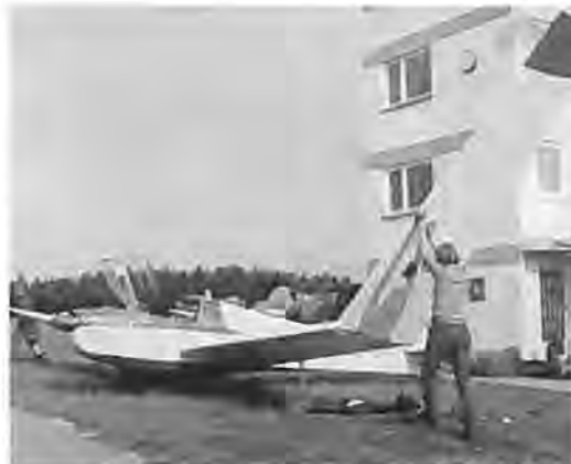
Chr. Gad demonstrerer den sammenklappelige vinge på SF-25E Super Falke, der vandt klassen for to-sædede.
