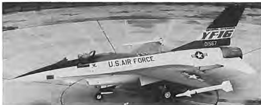
YF-16 eller General Dynamics Model 401 er en »letvægtsjager« med kun én motor - et forsøg på at mindske de enorme omkostninger ved moderne militære fly.
