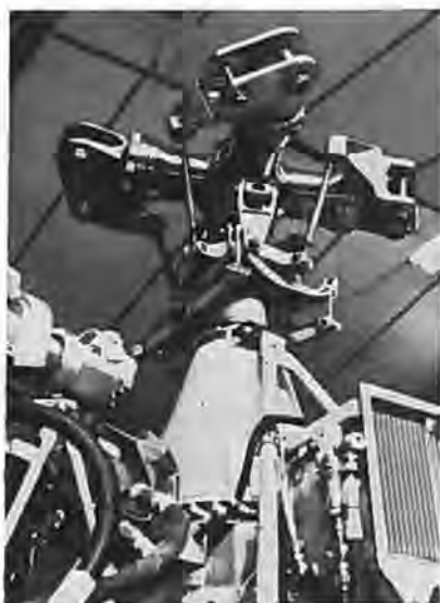
Det smedede rotorhoved på Bo 105 helikopteren er af legeringen TIKRUTAN LT 31 og vejer 30 pct. mindre end i en ståludførelse.
