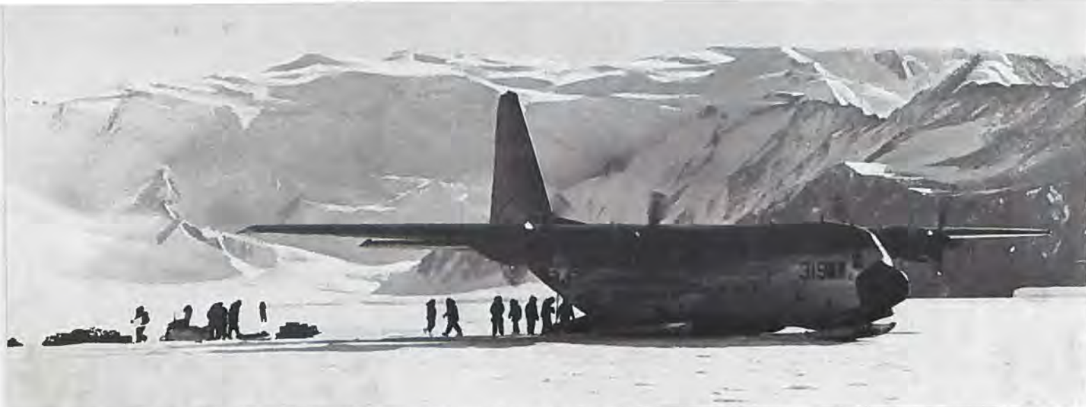
Hercules på ski i Antarktis. De amerikanske forskningsstationer i Little America og på Sydpolen er afhængige af lufttransporter. Hercules starter og lander i næsten 3000 m højde på Sydpolens sneslette.
