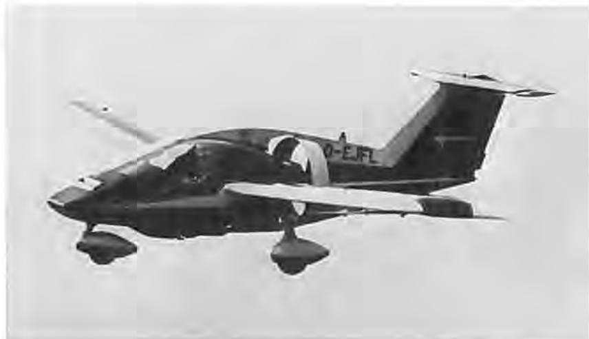
Blandt nyhederne i Hannonver er den Wankel-drevne Fanliner, udviklet af Grumman American og Rhein-Flugzeugbau under VFW-Fokker. Forpartiet er fra den hjemmebyggede VoWi-8, en del andre komponenter fra Trainer og Traveler.
