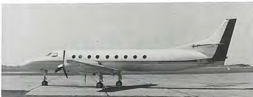
En sjælden fugl i de typerige danske nationalregister er OY-DSJ, en Swearingen Model SA-226TC Merlin til 20 passagerer. Den er forsynet med to 840 hk AIResearch TPE turbinemotorer.
