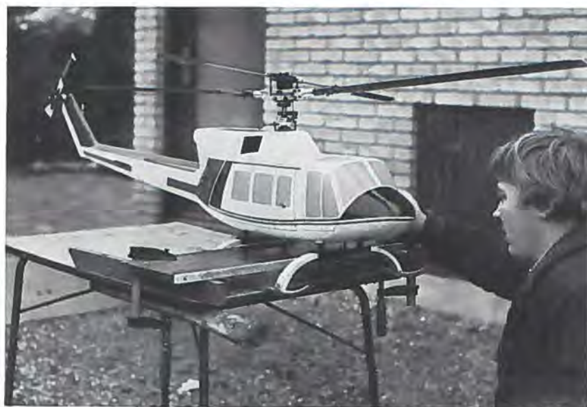
Her er helikoptermodellen anbragt, så den har en minimal bevægelsesfrihed. Den kan her trimmes uden risiko for at lave skader på den.
