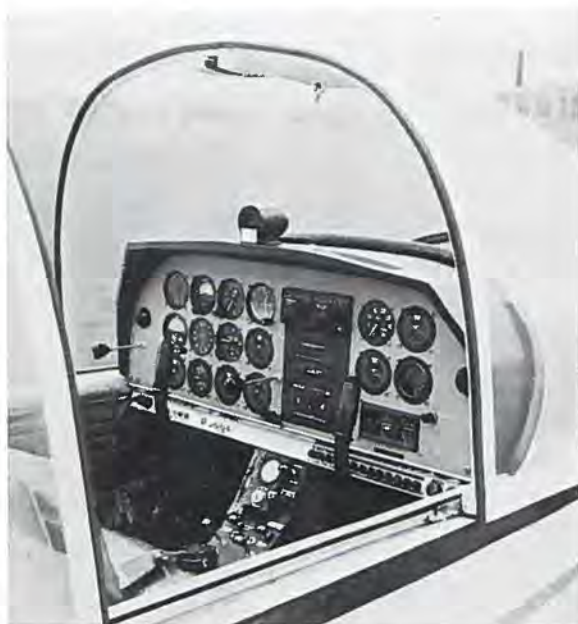
Club'en har et klart overskueligt instrumentbræt, pindstyring og har en del betjeningsgrej anbragt på midterkonsollen.
