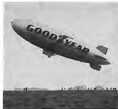
Luftskibet starter og stiger i en vinkel på ca. 23 grader.
