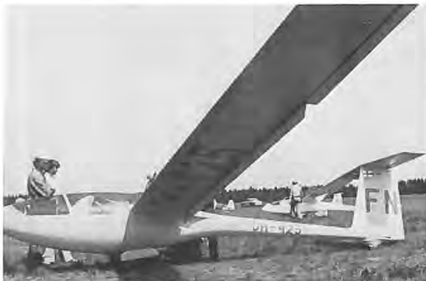
På dette foto af PIK-20 prototypen ser man tydeligt bremseflap'en slået 90^\circ ned.
