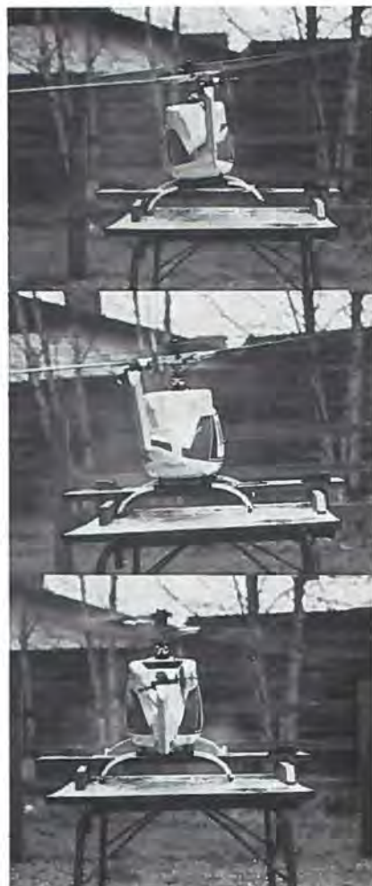
Fra oven: Hovedrotoren trækker for meget til venstre - trim til højre.
