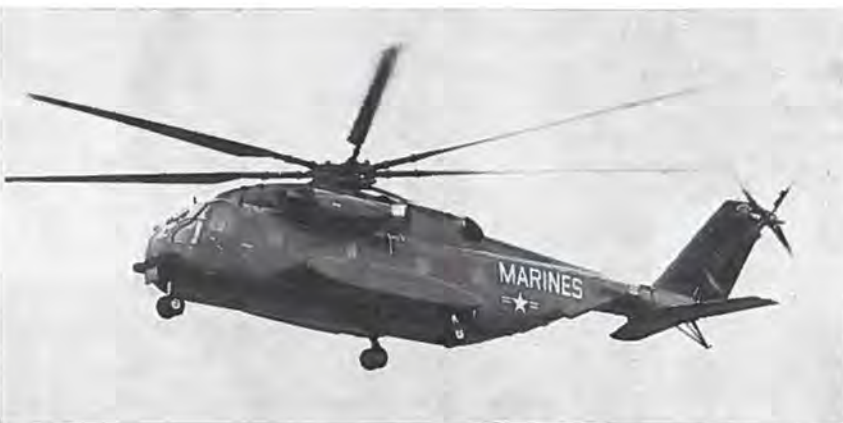
Sikorsky YCH-53E kan løfte op til 18 tons udvendig eller medføre 56 soldater og flyve 315 km/t.
