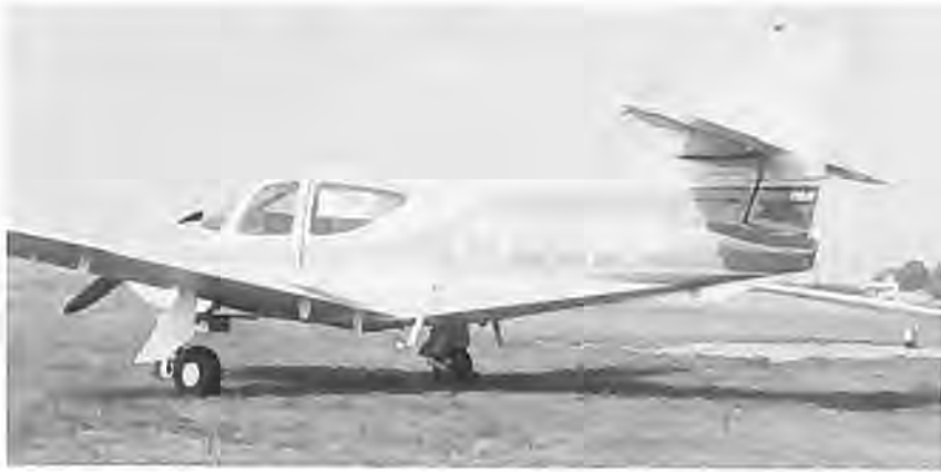
Haleplanet sidder ret højt på halefinnen af 112A, så man får meget små trimændringer, når flaps'ene og understel tages ud.
