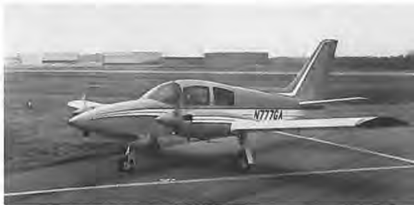
Grumman American Cougar, der fløj første gang 20. december, er et let firsædet fly med to 180 hk motorer. Man ser tydeligt slægtskabet med fabrikkens enmotorede typer.
