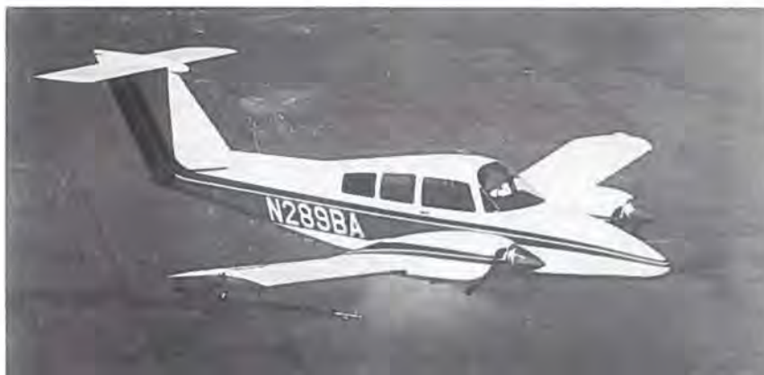
Beechcraft PD 289 er en ny prototype med to 160 hk motorer og T-hale, men om den bliver sat i produktion, er endnu ikke afgjort.
