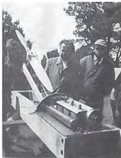
En anden indklapbar propelmekanisme, drevet af en 27 hk motor og beregnet for motorsvævefly (W. Knechtel).
