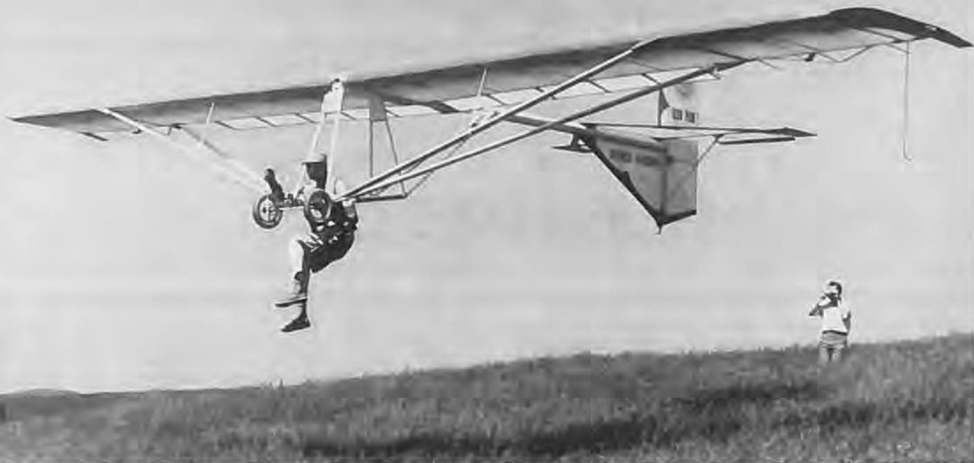
Efter et par hurtige skridt frem mod vinden glider Volmer Jensen ind i sædet for derpå at foretage en fornuftig landing på 20 minutter. Hjulene tjener dels til transport, dels til at beskytte piloten, hvis denne i stedet for at bruge benene foretager en »mavelanding«.
