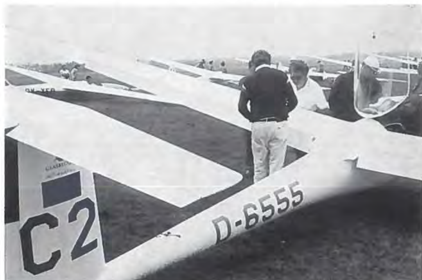
Glasflügels lækre Club-Libelle med T-hale, nedfældede bremseflaps og forerskærm hængslet i bagkanten.
