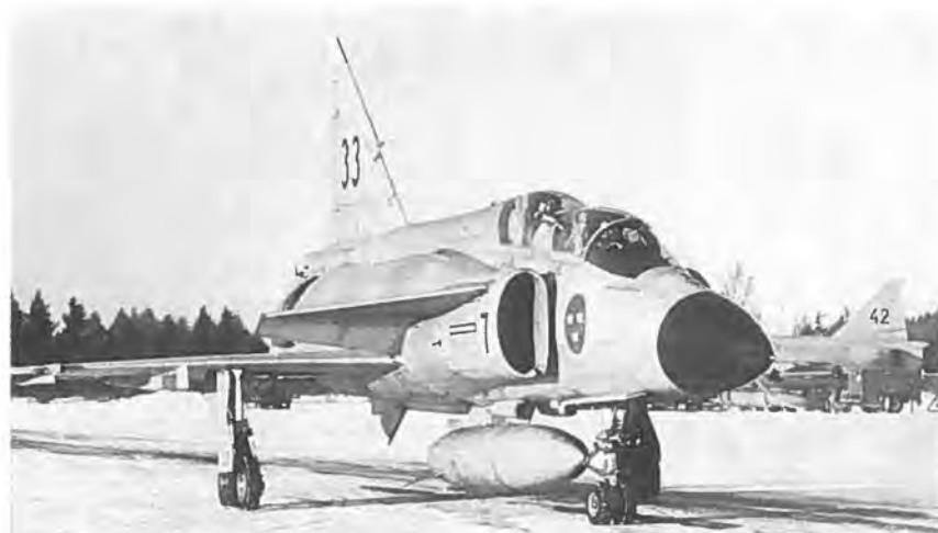
Ved kørsel og almindelig flyvning er udsynet fra bagsædet godt, men ved store indfaldsvinkler bruges periskoper, der lige kan skimtes. Bemærk det store flapudslag på næsevingen.
