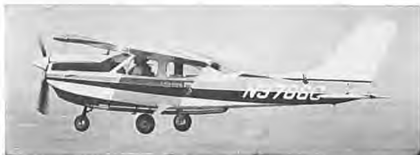
Den Wankel-motor-udstyrede Cardinal havde ulemper ved brændstofforbrug, vædskeskoling og gearsystem, der overvejede fordelene ved kompaktthed og mindre vægt - men også dette arbejder Cessna videre med.
