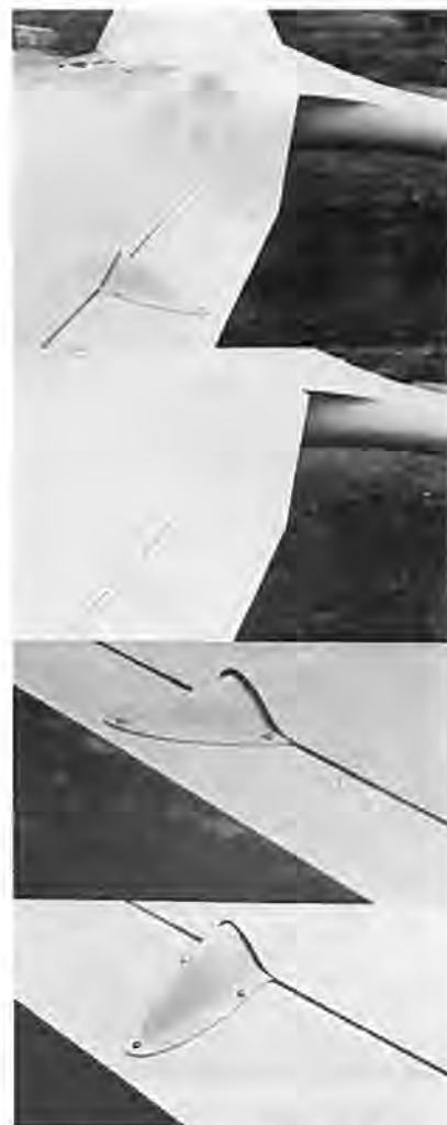
Øverst flaps og krængeror i 0-stilling, derunder begge 8 grader nede. På tredje billede er krængeroret 8 grader oppe, derunder 24 grader nede.
