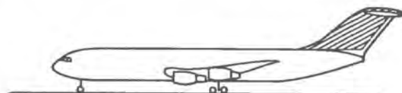
Øversigtstegning af et projekt med grænseflagsborttagning, hvorved man kan opnå en betydelig brændstofbesparelse. Afsugningen sker på de skraverede flader.
