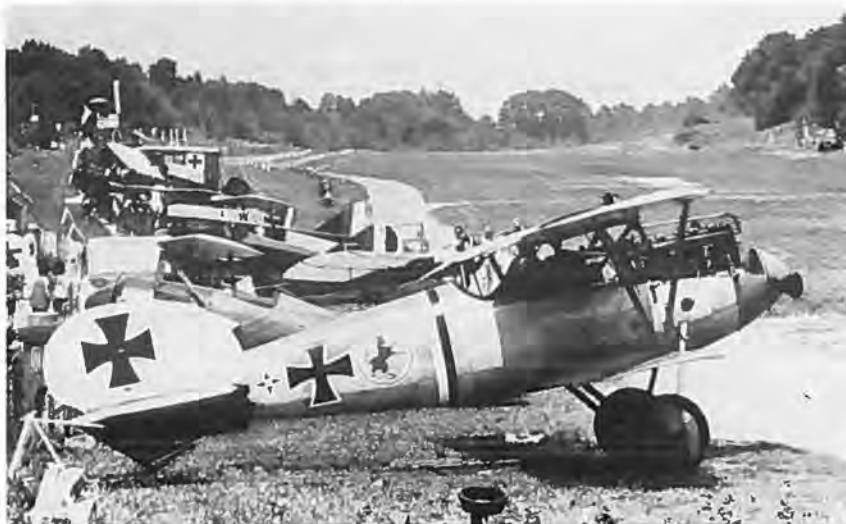
Forrest blandt de maleriske fly ses en Albatros, bygget i lamineret skalkonstruktion af træ og nu næsten flyveklar.
