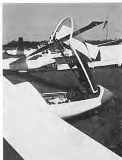
LS-1 deltog i flere nyere versioner, nemlig en LS-1d og to LS-1f, hvoraf den fra Øst-Sjællands Flyveklub ses herover. Som det ses, er forrskærmen hængslet fortil, ligesom der er indført andre forbedringer.
