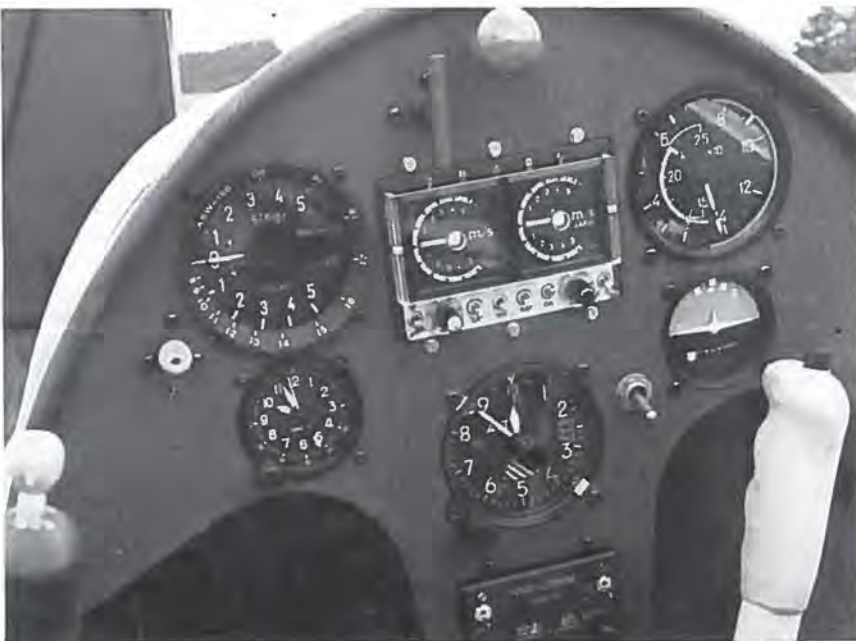
Instrumentbræt i moderne svævefly. Variometret til venstre er forsynet med McCreey-ring, mens instrumentet i midten er en Piro-computer, der kan fortælle piloten endnu mere om, hvordan han i hvert øjeblik skal flyve for at udnytte mulighederne optimalt. Foruden skimtes en batteridrevet Dittel-VHF-radio med 12 kanaler.
