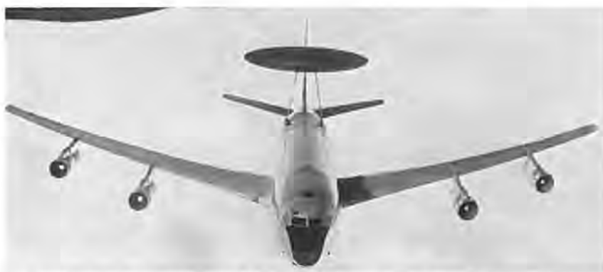
Den flyvende tallerken på ryggen af denne 720-320 er en radar med over 9 meters diameter
