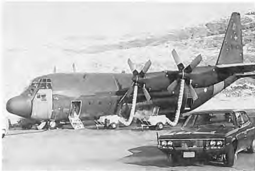
På vej til Værløse mellemlandede Hercules'erne i Søndre Strømfjord, hvor B-678 er fotograferet under opvarmning den 25. april, efter at den havde indtaget 4936 gallons JP-4 brændstof. Opvarmningen foretages med Herman Nelson H-1 varmere. I bilen den danske forbindelsesofficer major Hans C. Halten.
