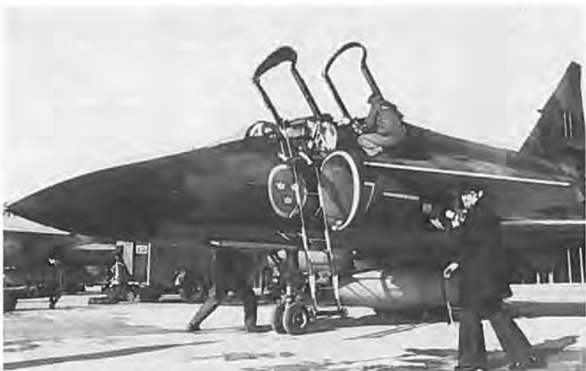
Der er adskillige trin op til førersæderne og der lægges iøvrigt normalt en gangbro hen over næsehjulet for adgang til bagsædet.
