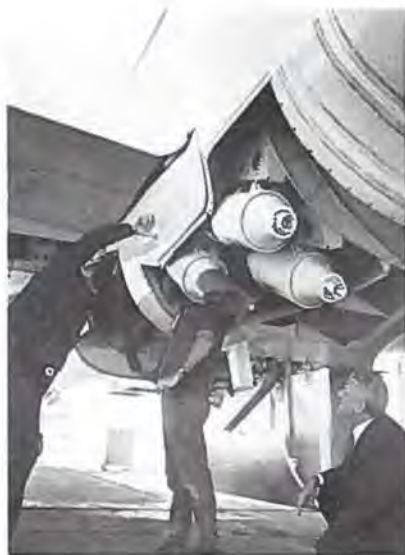
Raketaggregater på jettrafikfly: 3 raketmotorer som reserve, hvis en motor svigter under starten fra Mexico City.
