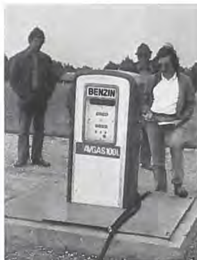
Den nye standardbenzin Avgas 100L er kommet i søgelyset i forbindelse med en del motorhavarier i den senere tid. De motorer, der var beregnet til benzin med lavere oktantal skal dels modificeres, dels behandles meget nøje efter forskrifterne, hvis man vil undgå uheld.
