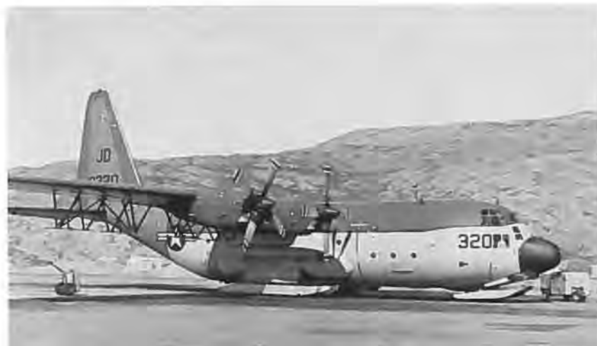
En LC-130 i Sønder Strømfjord, udstyret med antenner til radarmåling af indlandsisens tykkelse, fotograferet af Edw. Miller.
