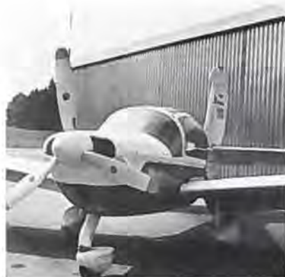
Den nye trebladede propel på MS 894 Minerva har nedsat støjen fra 84 til 77 dBA.
