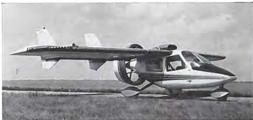
Cessna XMC-forsøgsflyet med ringformet skærm om propellen har vist en række ulemper foruden de ventede fordele ved dette arrangement; men et lignende tomotors fly med ringskærmet Wankel-motor skal efter vindkanalforsøg nu afprøves i luften, så ideen er stadig under arbejde.
