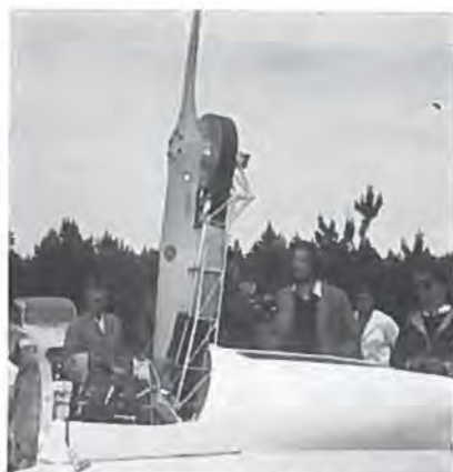
Bergfalke IV SM med indfældbar propel, konstrueret af Bernd Scheffel, der fik 1. præmie ved årets tyske amatørbyggerstævne herfor.
