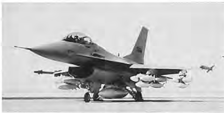
F-16 spækket med våben til angreb på jordmål. Den kan med fulde indvendige tanke medføre 5215 kg, og med mindre brændstof op til 6.800 kg.
