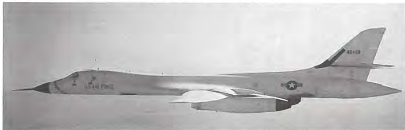
Rockwell International B-1A foretog sin første flyvning den 23. december. Det er et bombefly til afløsning af B-52. Fuldvægten er knap 177 tons, motorerne fire General Electric F-107-GE-100 på hver 13.610 kg trykkraft. Spændvidden varierer fra 23,83 m med vingerne bagud til 41,66 m i stilling til start og landing.
