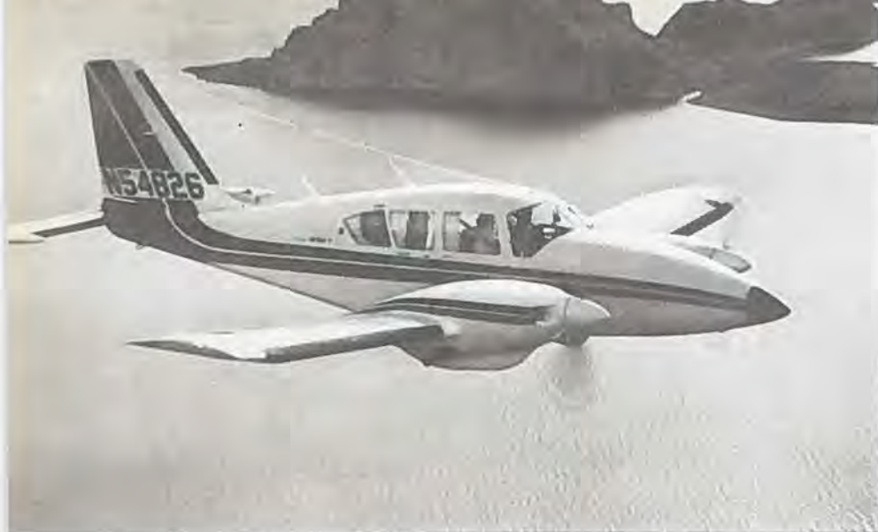
Piper Aztec F med 250 hk Lycoming motorer og indre tanke i vingetipperne er et rejsefly, der kan række over 2000 km med 45 min. reserve..
