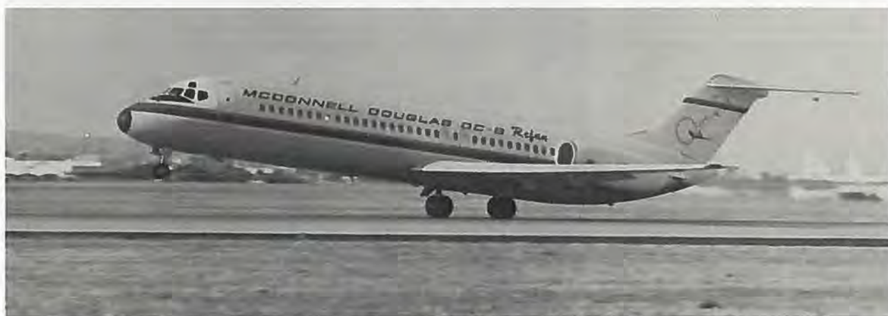
DC-9-Refan-modellen med JT8D-109-motor med større front-fan og omstrømningsforhold, hvilket nedsætter støjniveauet.
