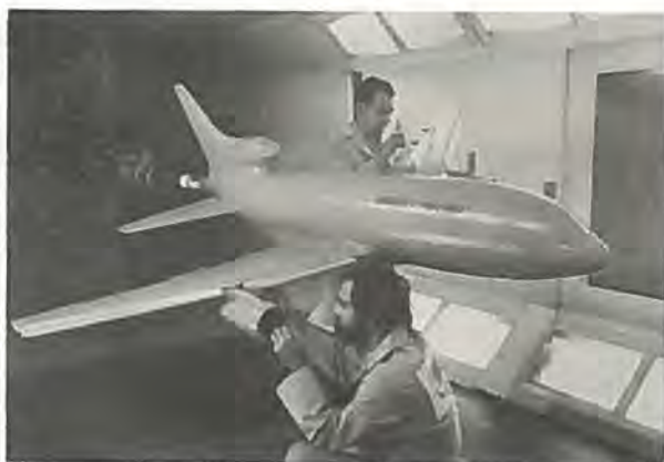
Vindtunnelmodel af L-1011-500 med kortere krop men stærkere motorer.
