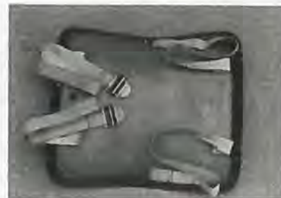
Fig. 2. Samme RAF-støtte af glasfiber set fra bagsiden med fastgørelsesanordninger til sædet. Kan også anbringes under flyverdragten, idet støtten aflaster ryggen betydeligt under evt. udskydning.
