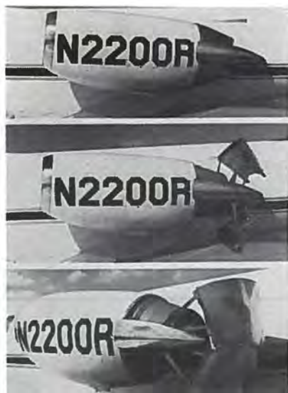
Citations nye bremseanordning øverst lukket, derunder halvt åben og nederst fuldt åben.
