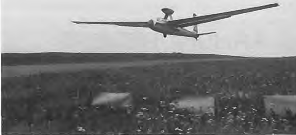
Ny version af en Blanik med motor, denne gang en nydelig indbygget folkevognsmotor med skubbende propel.
