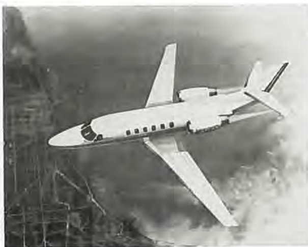
Cessna Citation III får en pilformet vinge med superkritisk profil. Der bliver plads til 10-13 passagerer.
