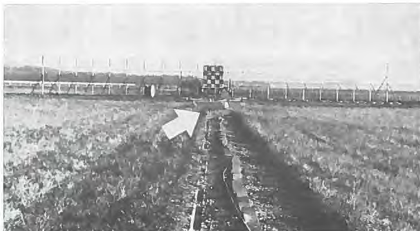
Blandt de mange MLS-forsøgssystemer er denne Philips-azimuth-vinkelmåler, der ses ved pilen foran en ILS-localizer, en del af systemet, som desuden består af en glidevinkelmåler, der også fylder langt mindre end et tilsvarende ILS-system.
