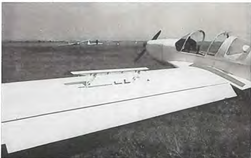
Der er både Schempp-Hirth-bremser og flaps på det nye motorsvævefly.
