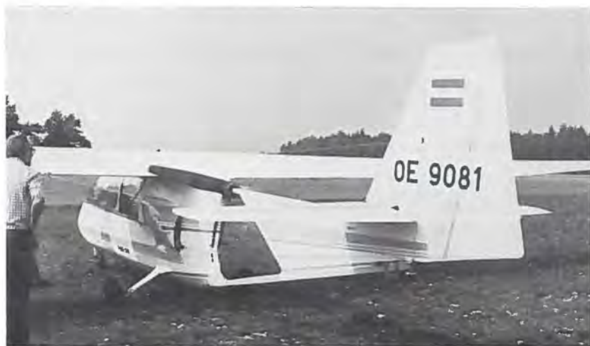
Bardunerne, der afstiver halepartiet, spærrer også for alt for nem adgang til en snurrende propel, men de yder desuden luftmodstand.
