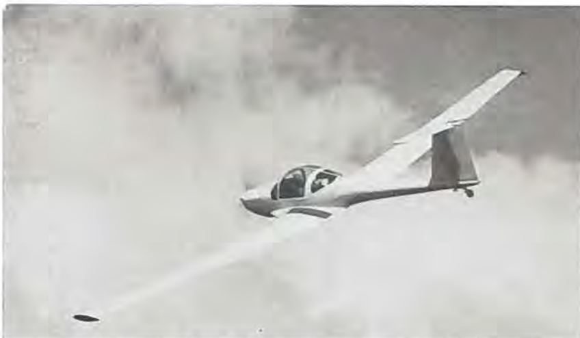
IS-28BM2 i luften. Det er et helmetalfly med sæderne side ved side.
