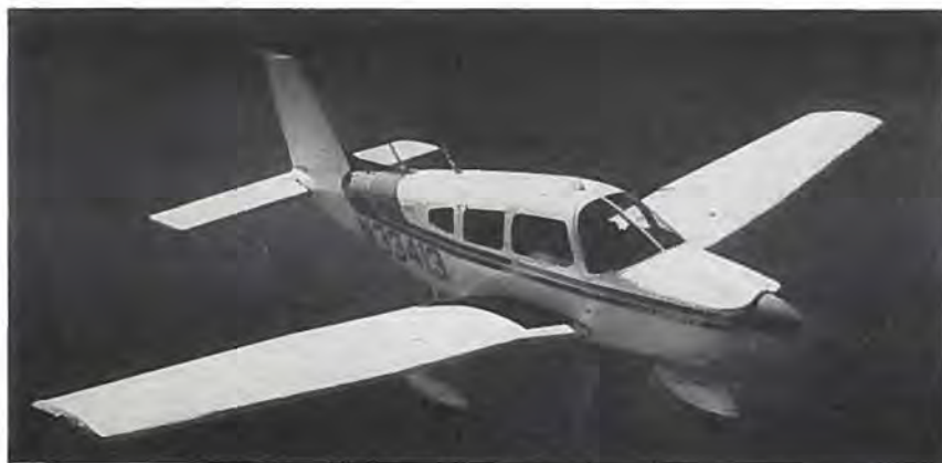
Piper Archer II har fået en vinge af samme form som Warrior med bedre præstationer og økonomi som resultat.
