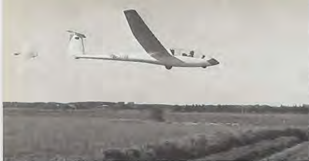
Med flaps, luftbremser og bremseskærm kan den store Janus med korrekt fart landes også på små marker.
