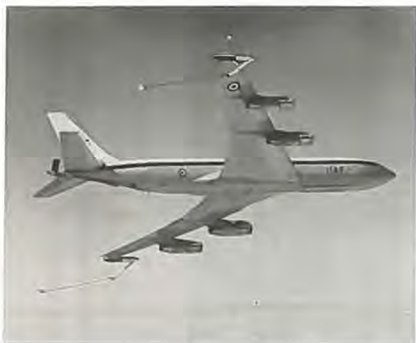
Den i sidste nummer omtalte Boeing 707-3J9C tanker, som leveret til det iranske flyvevåben. Den kan levere brændstof både med bom fra bagkroppen og med slanger fra vingetipperne.
