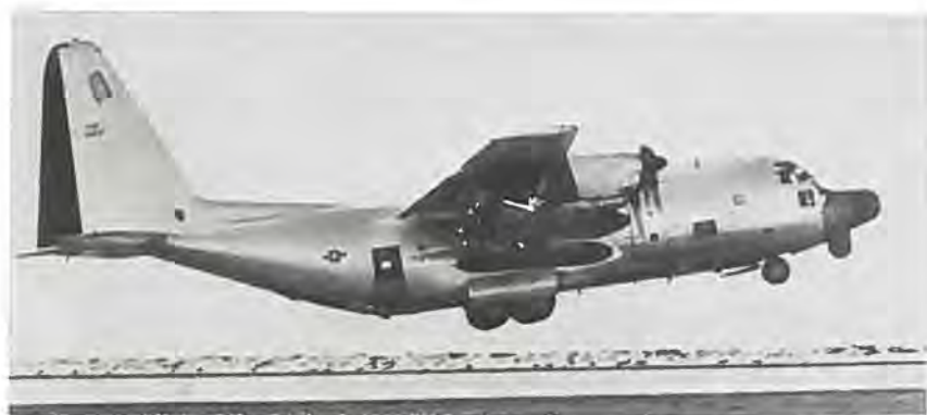
DC-130H Hercules starter med fire fjernstyrede forsøgsfartøjer med samlet vægt godt 20 tons. Det menes at være største udvendige last loftet af et fly med turbinemotorer.
