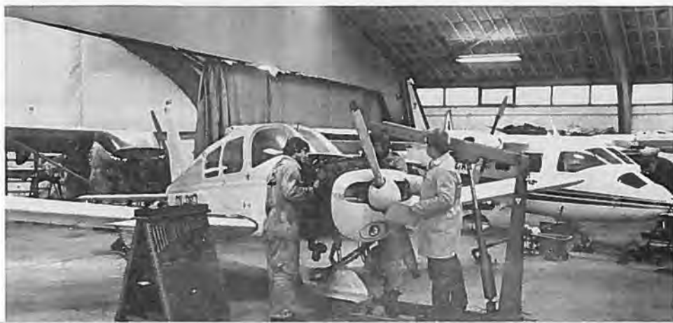
Jens Erik Lindhardt fra Lindhardt Electronics ved at installere fuld IFR i en Partenavia.
