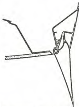
Mini-Nimbus'ens kombinerede flap/bremse. Øverst: flap'en kan slå 7° op og 10° ned. I midten: Så meget kan bremsen åbnes med flap i 10°. Nederst: Landingsstilling med fuld flap og bremseudslog.
