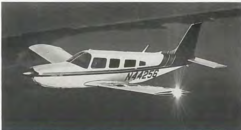
Pipers nye 300 hk forretningsfly med plads til op til seks personer, rejsefart op til 292 km/t og rækkevidde op til over 1600 km hedder Cherokee Lance.
