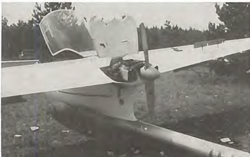
Limbach-motoren er tilgængelig under en hængslet motorskærm.
