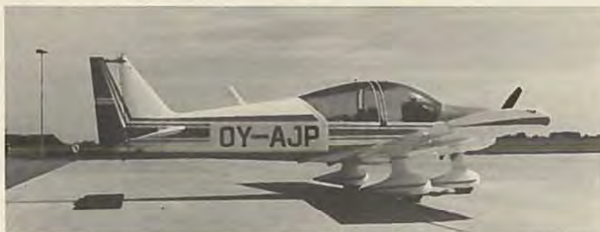
Dette er ikke Robin R 2160, men forgængeren HR 200/160 Acrobin, der ikke har finne under bagkroppen.
