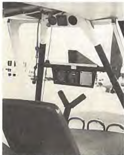
Der er dobbeltstyring i det enkelt indrettede cockpit i VoWi 10.
