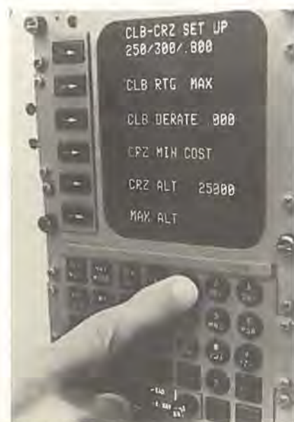
Et af de største fremskridt siden autopiloten kaldes Lockheed det automatiske system til brændstoføkonomisk flyvning.
