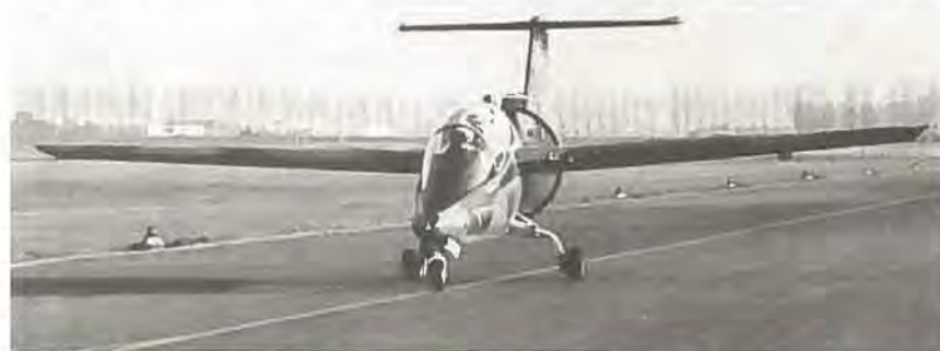
Et andet fly med skærmet propel er den nye Fantrainer fra Rhein-Flugzeugbau, hvis flyvninger begyndte sidst i 1977. Den betegnes også AB-2 og har to Wankelmotorer med ialt 300 hk.
