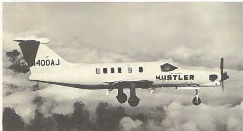
Så kom American Jet's Hustler i luften. Det skete den 11. januar ved hjælp af turbinemotoren i næsen, mens jelmotoren bagl først indbygges senere.
