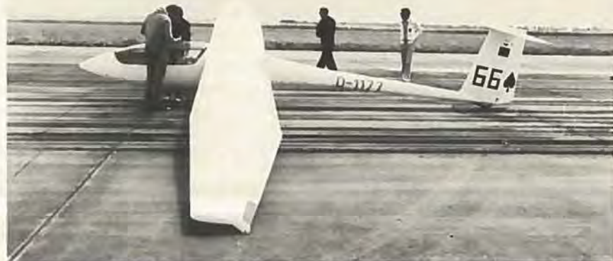
SB-11, hvormed Reichmann sejrede i 15 m klassen. Med de på billedet udfældede Wortmann-flaps øges planarealet med 25%.
