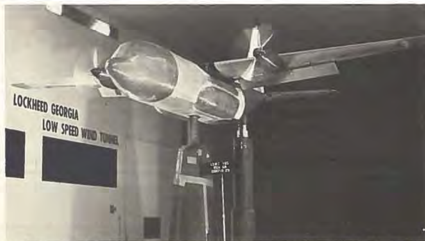
En 1:10 model af Lockheed Twin Hercules afprøves i vindtunnel. Ialt udførte man 265 timers forsøg.
