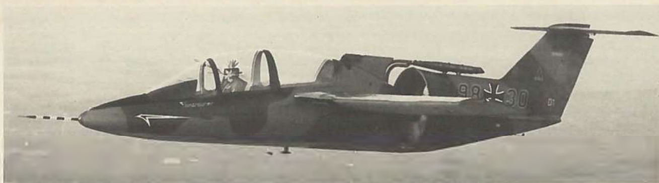
De to Wankel-motorer i Fantrainer bliver i næste prototype erstattet med en Allison C 20 turbine.
