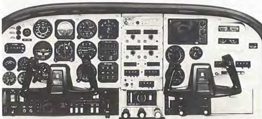
P210's veludstyrede instrumentbræt med vejrradar over højre rat og betjening af trykkabinen under det venstre (kabineinstrumenter tv for rattet).
