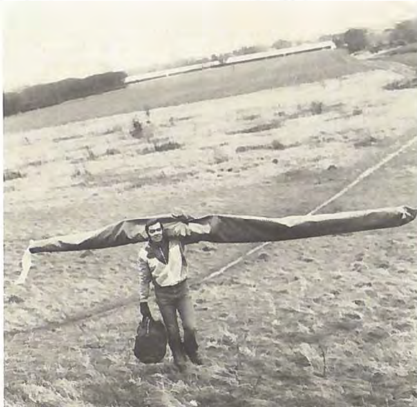
Til venstre et selvportræt af Fl. E. Rasmussen hængende i sin Falcon Mr. 4 over Sejs. Bemærk dragens spejlbillede i pilotens hjelm. - Billedet herover viser, at en sammenfoldet drage nemt kan bæres på skulderen af én mand.
