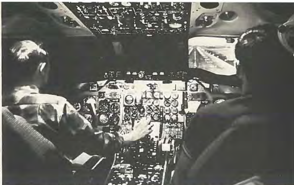
Dette billede er taget i en DC-9 simulator på Bromma. Uden for cockpitvinduet til højre kan man se en filmet indflyvning til en lufthavn, hvor piloten skal lande med sin DC-9.
