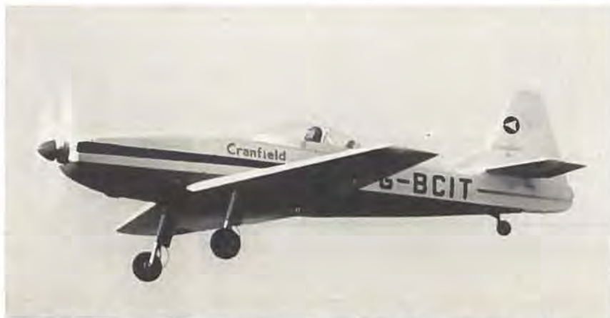
Cranfield A 1 er et britisk kunstflyvningsfly med 260 hk motor. Dets produktionsmæssige fremtid er foreløbig uafklaret.
