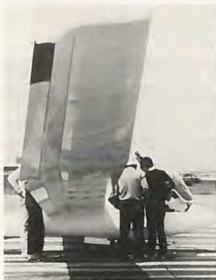
Undersiden af SB-11 vingen med Wortmannflap'en ude. Den alm. flap kan bruges både med det lille og store vingear-al.
