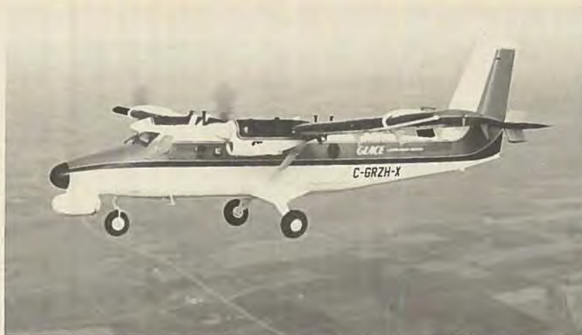
En stadig større dansk erhvervsflyvevirksomhed sker på Grønland. Her Greenlandair Charters nye Twin Otter med radar under næsen til isrekognoscering. Kroptanke giver flyet en flyvetid på 10 timer. Det er nu dansk registreret.
