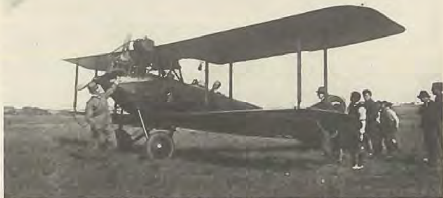
Skolefly for 50 år siden: det tyske LVG-B III biplan med 120 hk rækkemotor med opadrettet udstødning.
