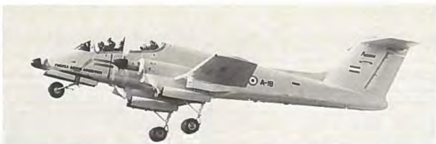
Den argentinske IA 58 Pucara (oprindelig Delfin) har to 1022 hk Turbomeca Astazou motorer og kan bevæbnes med maskingeværer, kanoner og op til 1500 kg udvendige våben.
