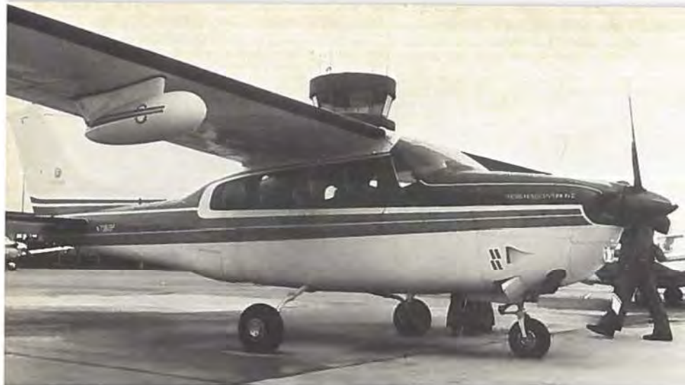
Pressurized Centurion II med radarantenne under vingen – og EKRK's tårn over denne. Såvel vinduer som registreringsbogstaver er små!
