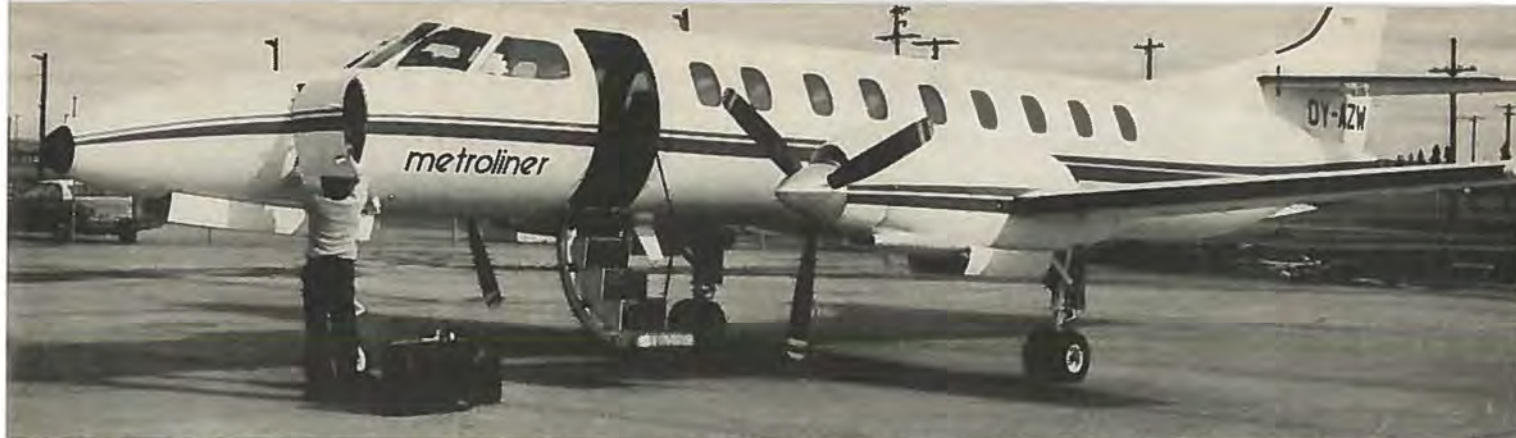
Den langkroppede Metro II er for tiden det største fly stationeret i Roskilde. Man ser »hovedindgangen« og lem til forreste bagagerum.
