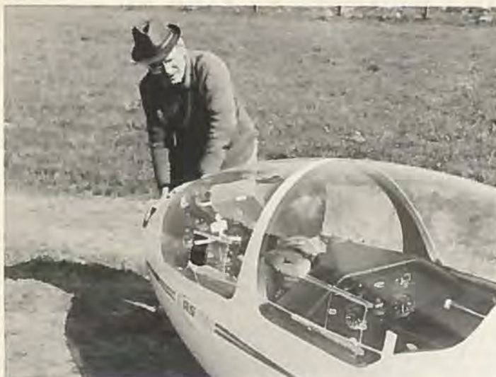
Rudolf Kaiser giver instruktioner til Edgar Kremer inden spindforsøgene. Snoren på siden er til nødkast af blyballasten i halen.
