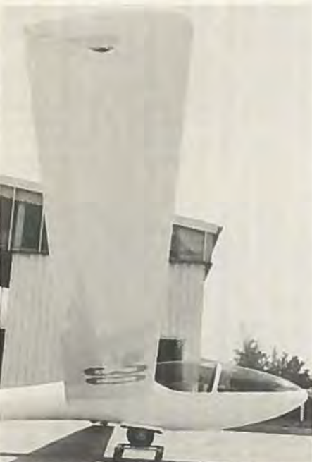
Man ser hvor lidt spalte der er på undersiden af den blankpolerede glasfibervinge.
