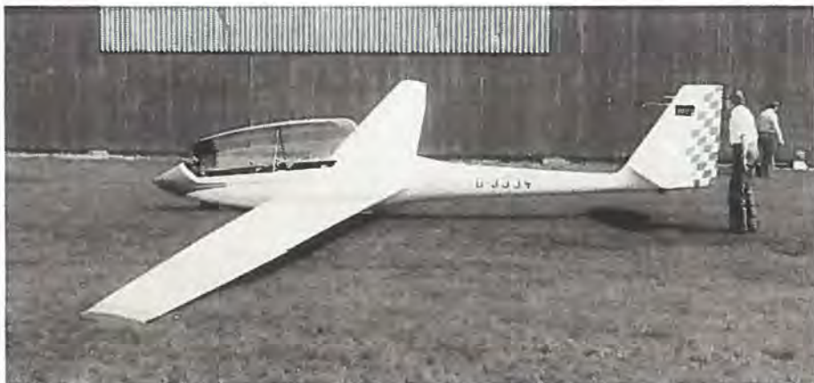
SF-H34 er et relativt lille og kompakt tosædet glasfiberfly med nem adgang til sæderne, men ringe frigang under forkroppen.
