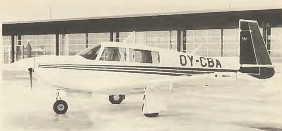
Den strømliniede Mooney 201 i Roskilde. Den præsterer 201 mph på 200 hk og enten høj rejsefart eller lavt brændstofforbrug.
