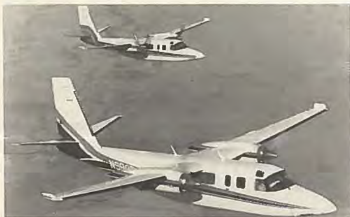
To nye Rockwell typer, Jetprop Commander 840 (øverst) og Jetprop Commander 980 (nederst). Små winglets og super-kritiske Dowty-Rotol-propeller gør dem meget brændstof-effektive.
