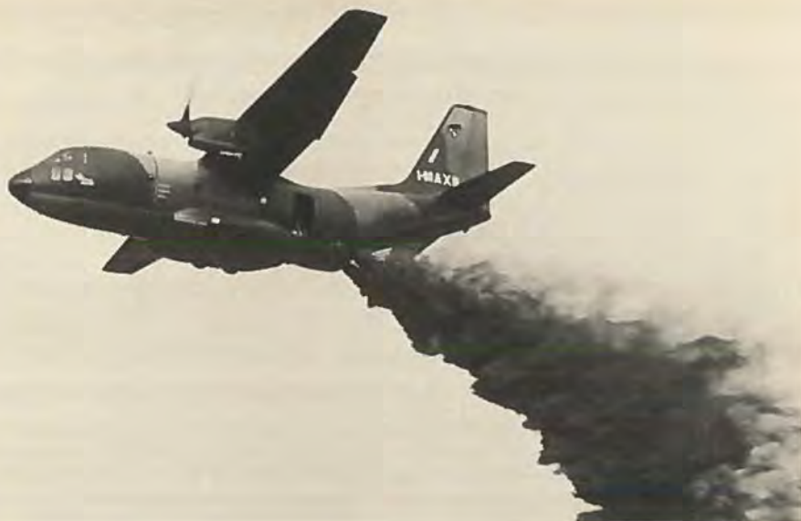
G 222 indrettet til brandslukningsformål.
