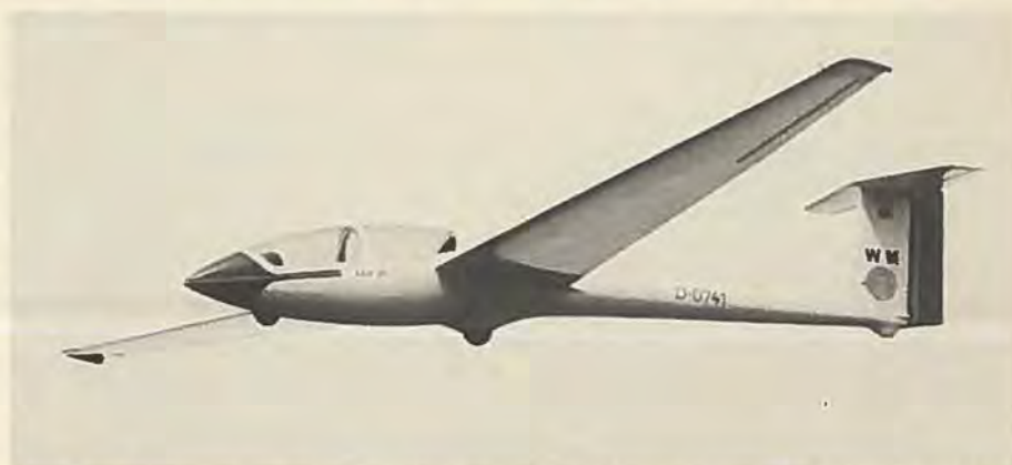
Netop som dette nummer skulle i trykken, kom vedlagte modelbillede fra Schleicher af ASK-21, der med 17 m spændvidde ventes at få ca. 350 kg tomvægt og glidetalt 34 ved 90 km/t.
