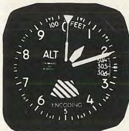
Højdekoder - højdemåler, der via transponderen kan fortælle flyveledelsen flyets højde.
