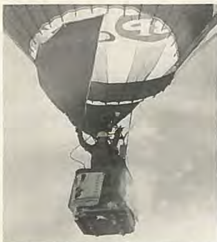
Det danske hold under konkurrencen. Sejlet under hylsteråbningen er beregnet til før og under start at lede vindstrøm og varme ind i hylstret.
