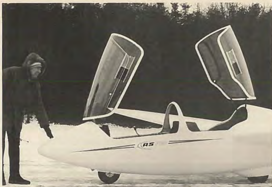
På ASK-21 er førerskræmen delt i to, der klappes op som vist på billedet.
