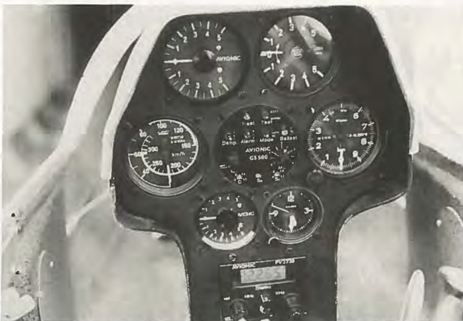
Avionic GS 500 indbygget i instrumentbræt. Det primære instrument øverst tv viser under alle forhold total og polarkompenseret bevægelse. Nederst tv det sekundære instrument, der viser enten middelstig eller speedcommand.
