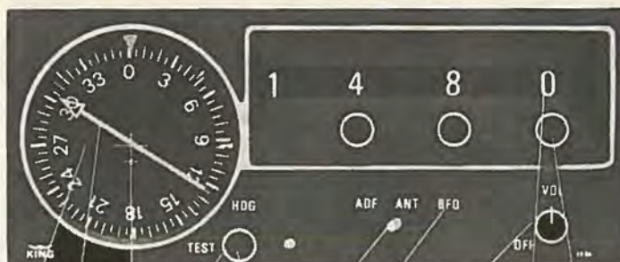
Denne ADF er kun VFR-godkendt, da modtagerkvaliteten er under ICAO's IFR-krav og indikatoren ikke er adskilt fra modtageren.
