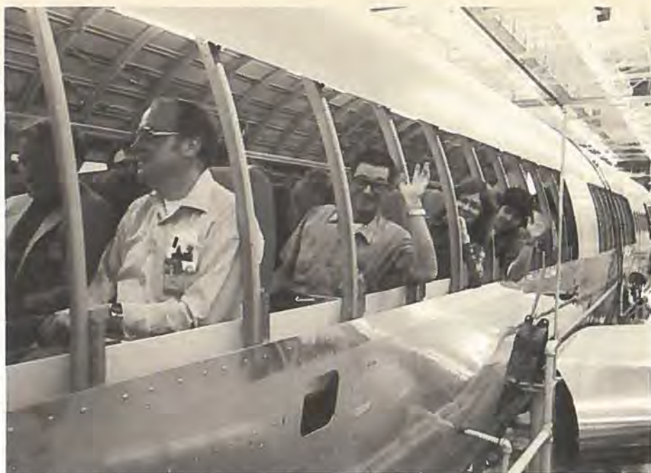
Flyvende skovturs-sporvogn? Nej, en Boeing 757 attrap til tids- og bevægelsesstudier under en simuleret flyvning på 1 t 25 m.
