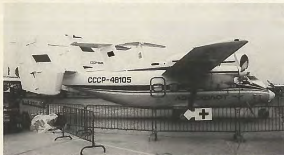
Antonov AN-28 er et STOL-fly med to 960 hk turbinemotorer. Den produceres i Polen.
