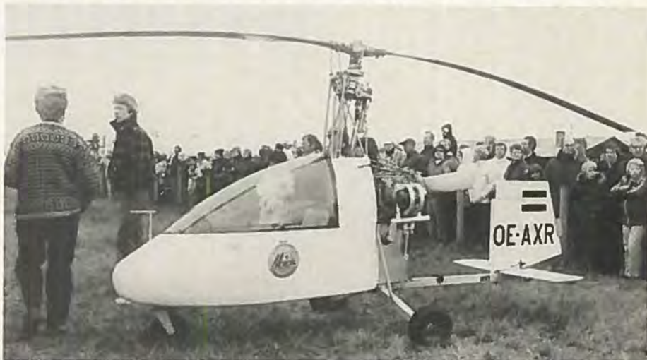
Østrigeren Oskar Westmayer byggede i 1969 et gyroplan WE-01 efter Bensen-principper, men har siden udviklet typen til WE-04 med nyt rotorhoved. Motoren er en VW-type. Flyet rejser med 120 km/t, stiger over 5 m/sek. og rækker 250 km.
