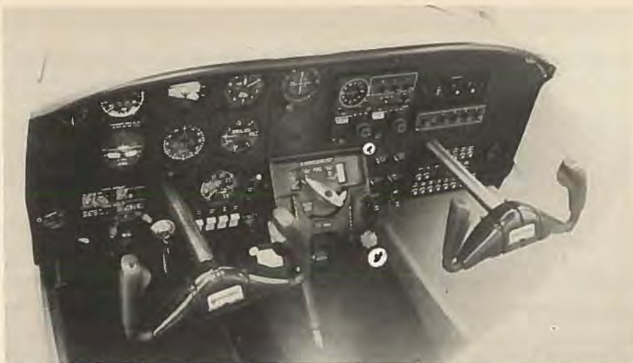
Prøveeksemplarets rigt udstyrede instrumentbræt. Bemærk brændstoftag midt på gaspulten og forvarmehåndtag lige til venstre herfor.
