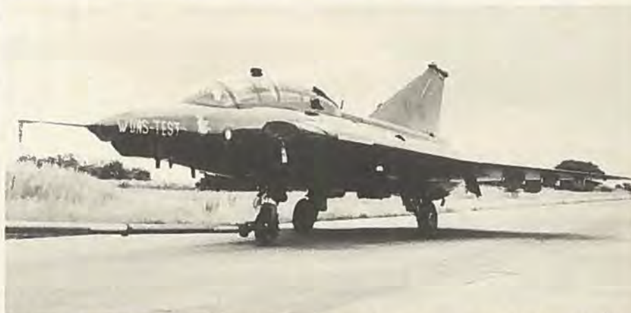
AT-158 er en Draken TF-35, der forsøgsvis er udstyret med den næse, WDNS-udstyret skal rummes i.
