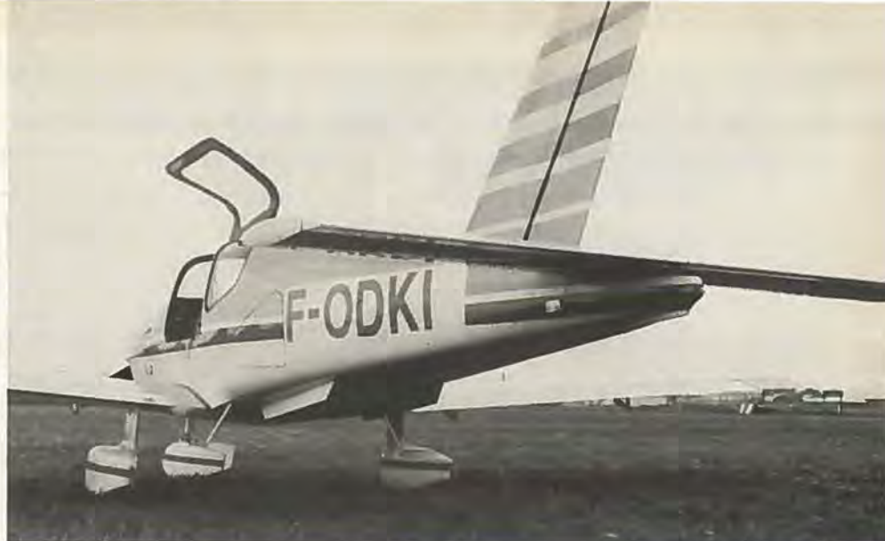
Den ene kabinedør åben, bagagelem lukket. Bemærk de to ekstra finner under kroppen. Haleplan og højderor sidder helt bag sideroret.
