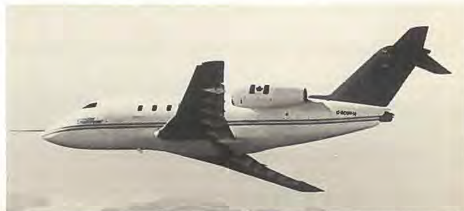
På to uger udførte Challenger-prototypen 11 flyvninger på ialt 14½ time. Herunder nåede man 30.000 feet, Mach 0,65 samt prøvede at stoppe og genstarte en motor i 25.000 feet. Herefter skulle den midt i december være fløjet til Mojave.
