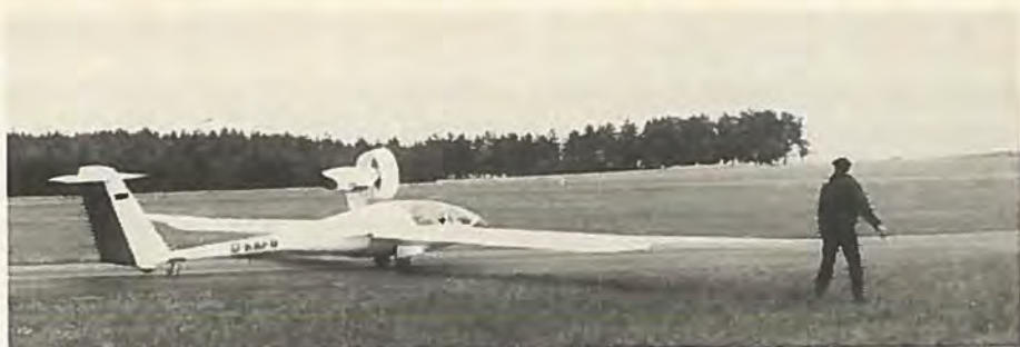
Oprindelig en Calif, så Sirius II, nu forsøgsfly for Gomolzig's og Limbachs nye motorinstallation.
