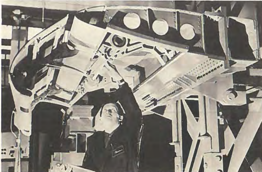
Prøvestand for træthedstest af forkantflap til Boeing 767.
