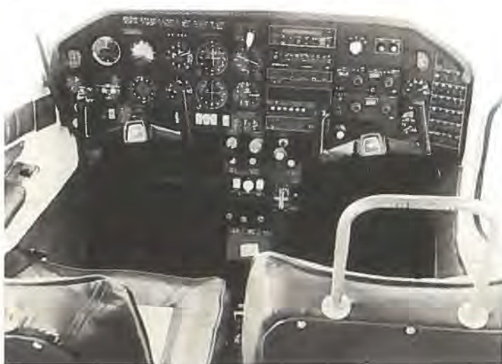
Cockpit'et i OY-CBA med et omfattende radio- og navigationsudstyr (King) samt motorinstrumenter og sikringer på det skråtstillede panel yderst til højre.
