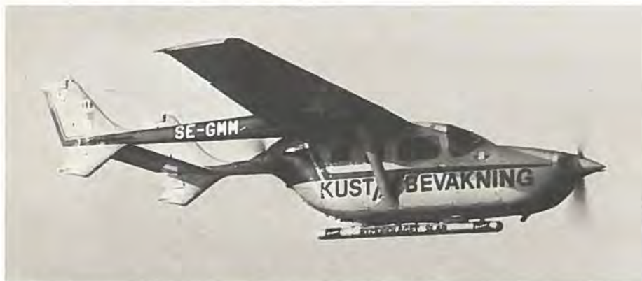
Den 3 m lange antennebeholder anbragt under Cessna 337.
