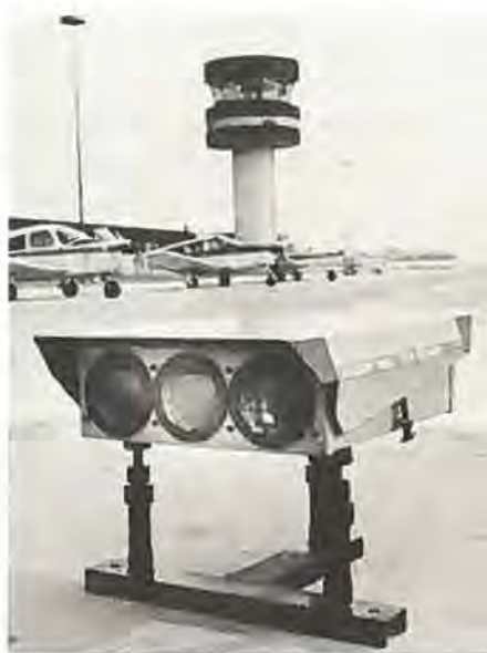
Typisk PAPI-armatur af optisk type, baseret på projektorprincippet.
