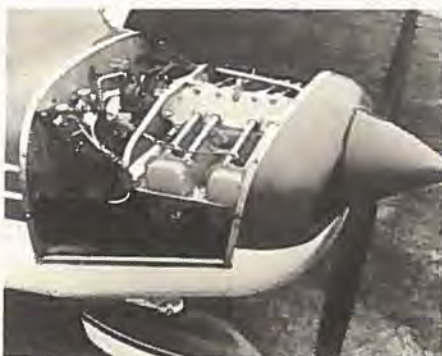
Øverste motorskærm fjernes i ét stykke og giver fin adgang til den nye motor.
