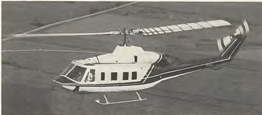
Bell 214St Super Transport er udviklet af 214 og især beregnet til brug ved olieboringsplatforme.
