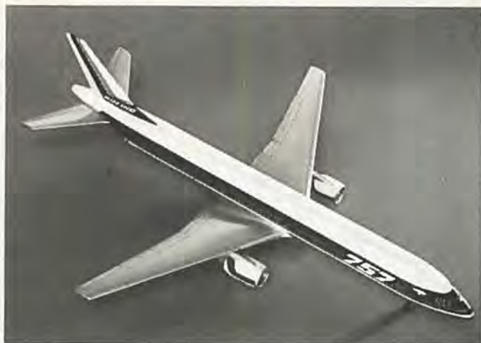
Boeing 757 skal ikke som tidligere vist (FLYV nr 11/1978 side 347) have T-hale, men får haleplanet flyttet ned på kroppen.
