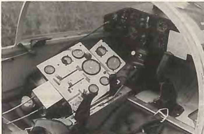
Til venstre det løse motorpanel i den ombyggede Sirius II. Til højre drøfter W. Binder og H. Gomolzig systemet til at køre motoren op og ned i kroppen.
