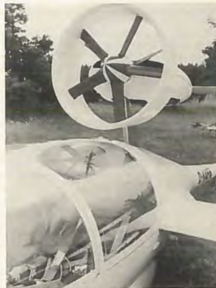
Den skærmede rotor drives af en Limbach med direkte indsprøjtning og turbolader.
