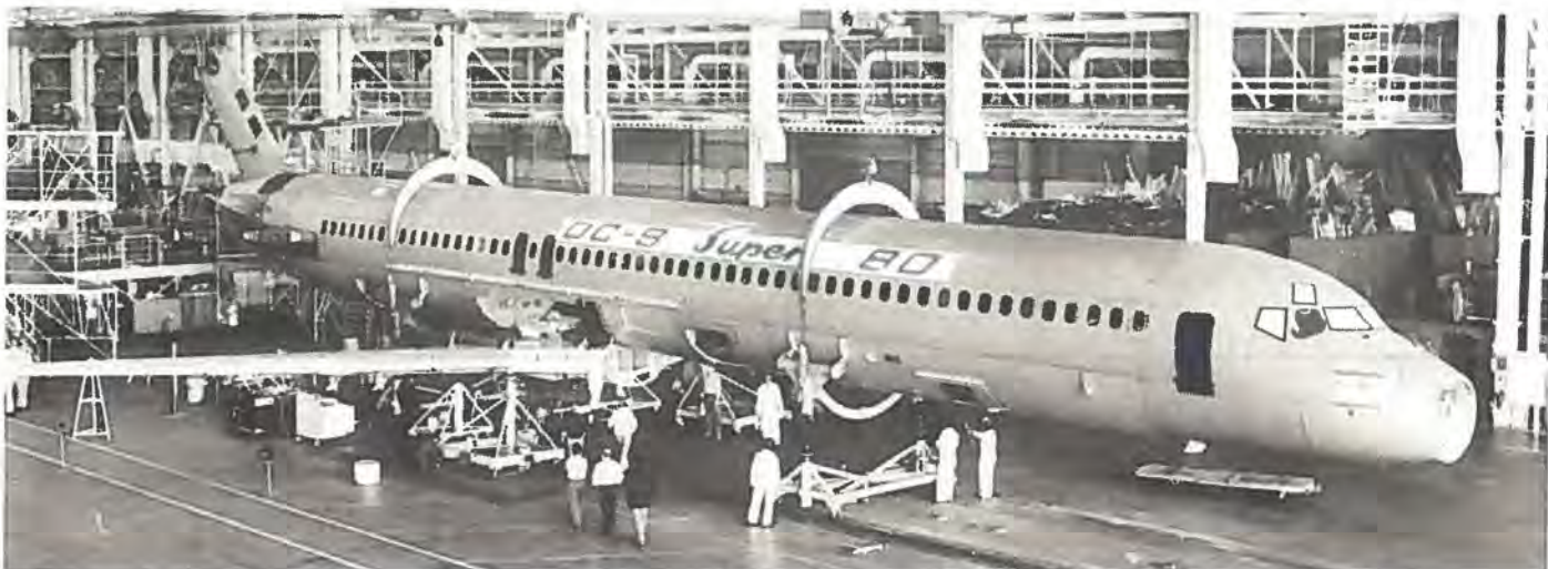
Længere og længere bliver kroppen på DC-9 - her sættes vingen på den første Super 80, der med nye motorer skal blive den hidtil støjsvageste jetliner. Der er bestilt og reserveret 78. Den første går til Swissair.
