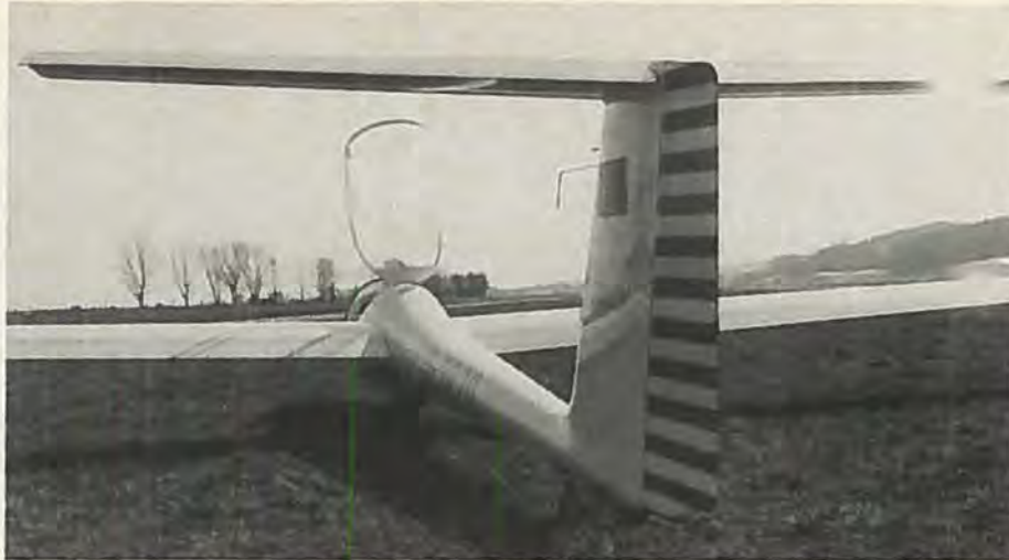
Speed Astir bagfra med T-halen, fabrikkens praktiske løse halehjul, der falder af hvis man glemmer det, samt førerskærmen i åben stilling, sikret med en gasfjeder.
