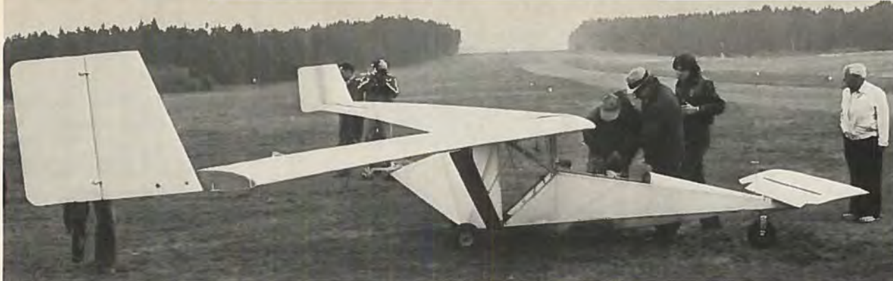
Herover Neukom AN 21 og til højre AN 20. Begge ultralette fly med ror-styring. AN 21 har pilformet vinge, forplan med højderor samt finner og sideror på vingetipperne.
