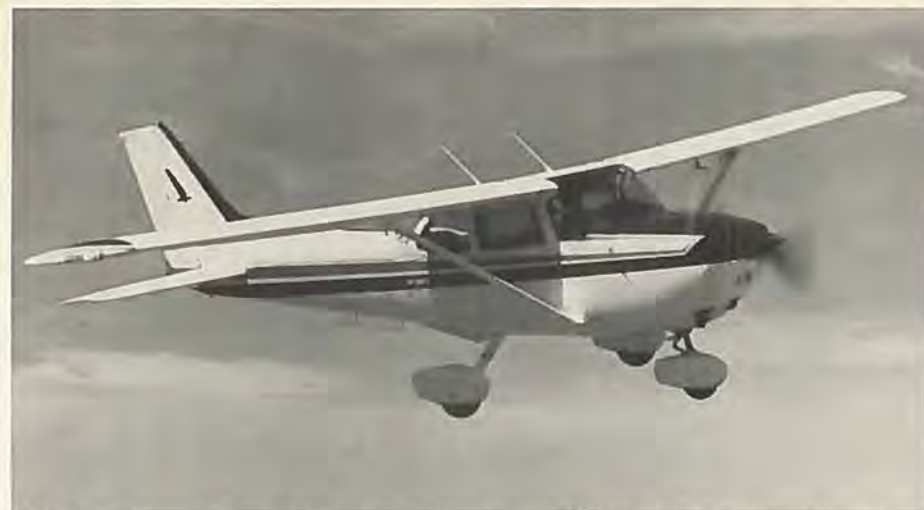
Sådan ser Cessna Skyhawk II ud i 1981-udgave. Den har fået en anden motorversion og højere fuldvægt på 1089 kg.
