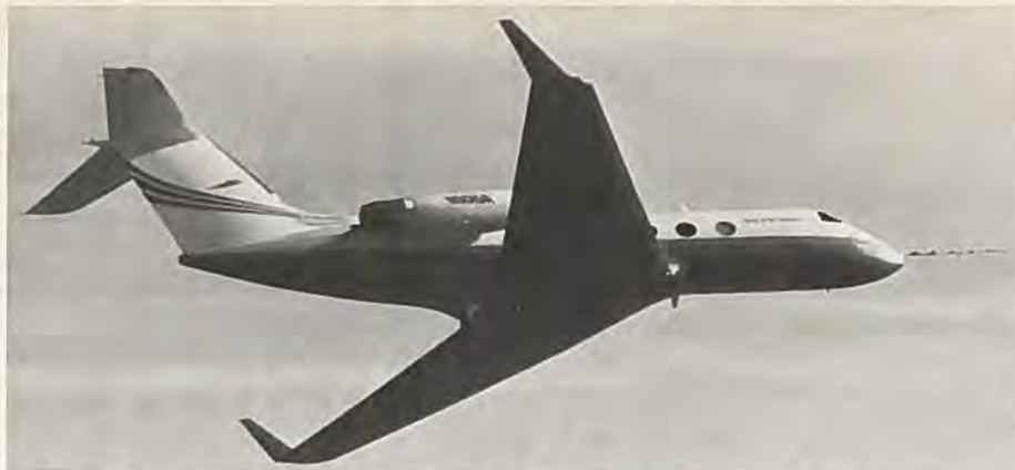
Gulfstream III, flyvevåbnets kommende type til havovervågning, foretager sin første prøveflyvning, der varede 1 time 50 minutter. Den har en avanceret vinge med winglets m.m.
