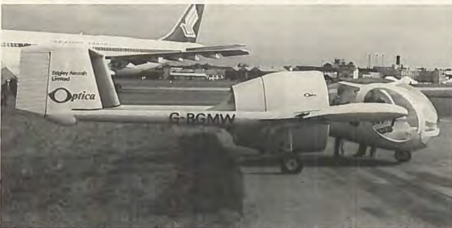
Den mærkelige Edgeley Optica med helikopternæse og indkapslet motor med fembladet propel.
