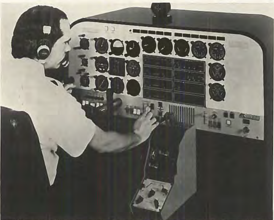
Det sparer benzin og er mere sikkert at øve nødprocedurer, når det foregår i en simulator som denne ATC-810, der svarer til typer som Beech Baron eller Piper Navajo.
