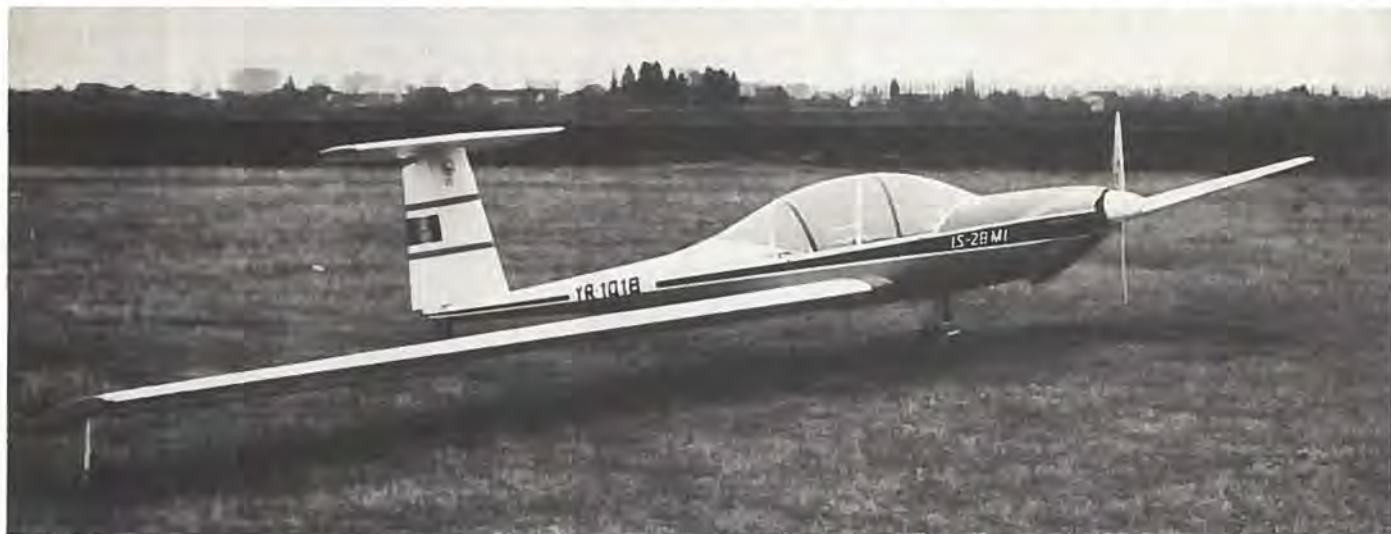
Mens den leverede IS-28M2 har sæderne side ved side, har IS-28M1 dem i tandem. Forfatteren fløj en time i termik med den sammen med testpiloten, og skønt ingen er over middellængde, følte pladsen trang, så flyet skal modificeres, før det sendes på markedet.
