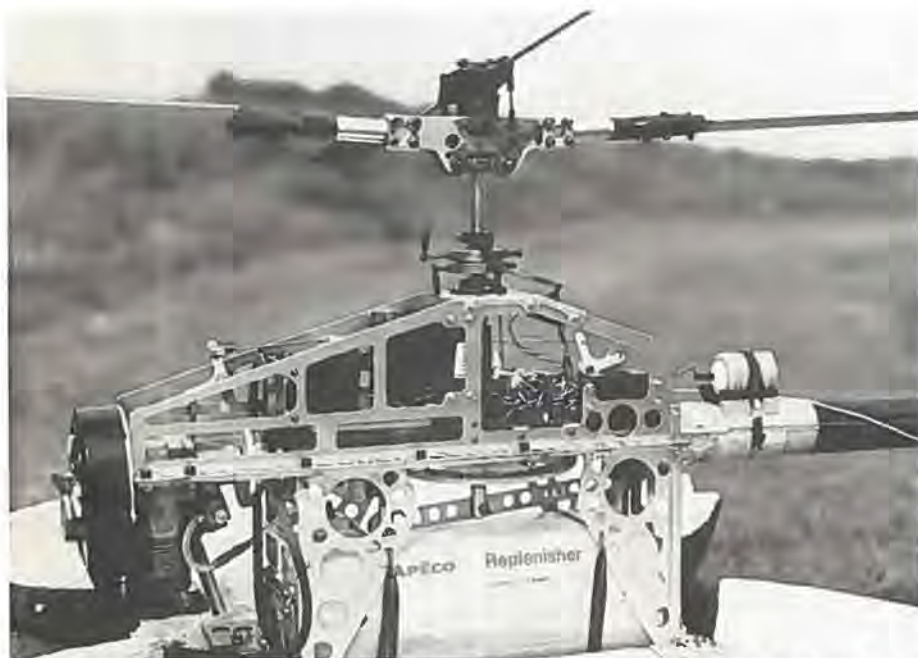
Med de formgivende skaller slået ned præsenterer rekord-helikopteren sine ædle dele. Som man ser er strukturen lettet til det yderste for at give vægt til brændstof i tanken. Motoren er en 9,97 ccm HB 61 Stamo, radioen en Robbe Mars FMM Rex.
