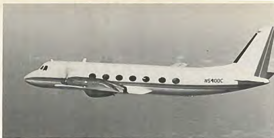
3,25 m længere krop sætter Gulfstream I-C i stand til at medføre op til 38 passagerer.
