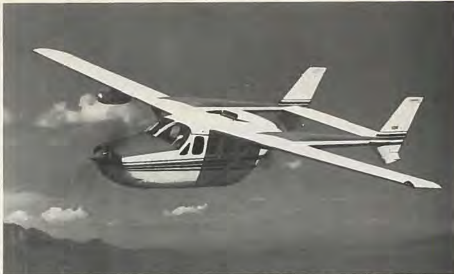
Tomcats fly med begge motorers trækraft nær flyets centerlinier eliminerer de havarier, der opstår ved usymmetrisk træk på andre fly.
