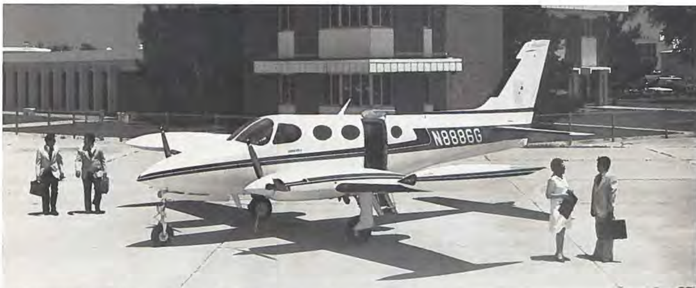
Cessna 335 har trods de ovale vinduer ikke trykkabine, men den har indbygget trappe til at komme direkte ind i kabinen.
