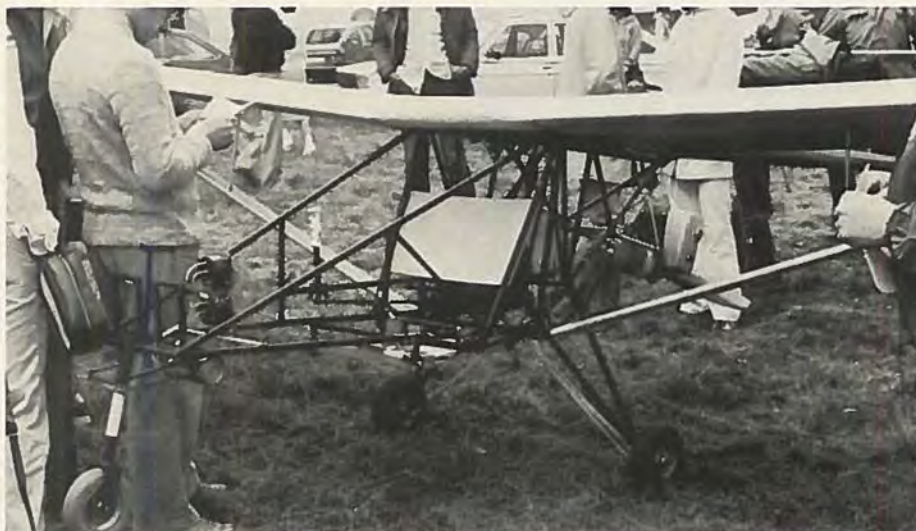
AN 20 har åben rørkrop og en 13 hk Solomotor.
