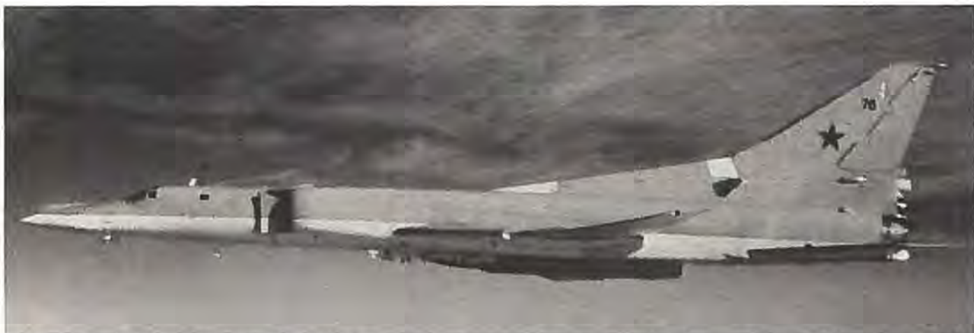
Det svenske flyvevåben har taget dette foto af en sovjetisk TU-26 Backfire, forsynet med AS-4 Kitchen missil under kroppen. Flyet er blågråt foroven og ellers lyseblåt.
