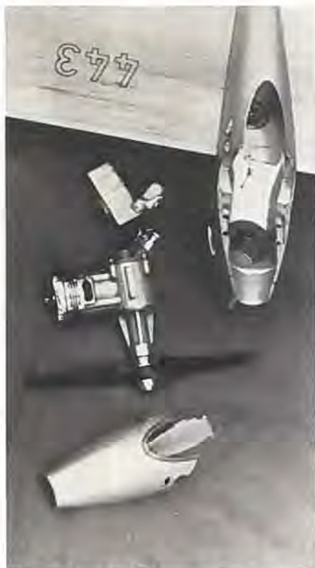
Forpartiet adskilt. I kroppen ses den forbindelse, der stopper motoren. Pilotohovedet er fastgjort på balsa-tanken. Propellen er af kulfiber.
