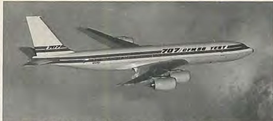
Registreringen N707QT indikerer, at Boeing 707 med CFM-56-motorer ikke alene gør flyet mere brændstøfekononomisk, men samtidig mindre støjende.
