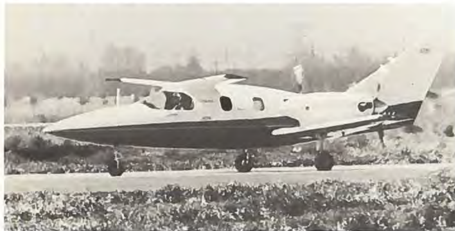
Som man ser på dette billede, sidder forvingen faktisk højere end hovedvingen.
