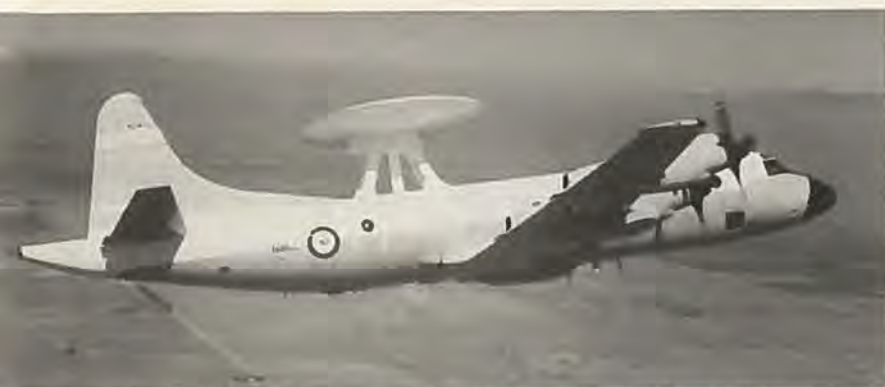
Lockheed P-3 Orion forsøgsvis udstyret med rotodome med radar, så flyet kan tilbydes som et billigere varslingsfly end hidtidige typer.
