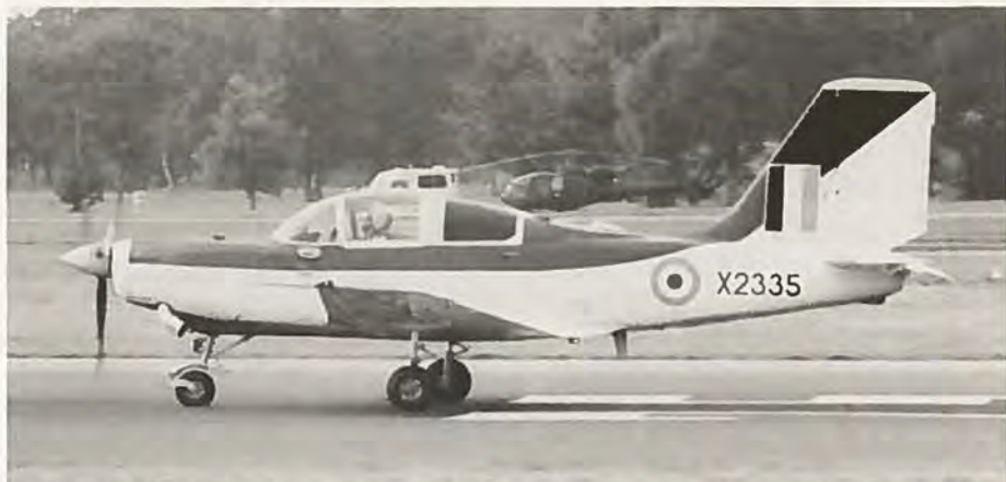
Hindustan HTT-34 er et militært skolefly med turbinemotor, baseret på stempelmotorflyet HPT-32.
