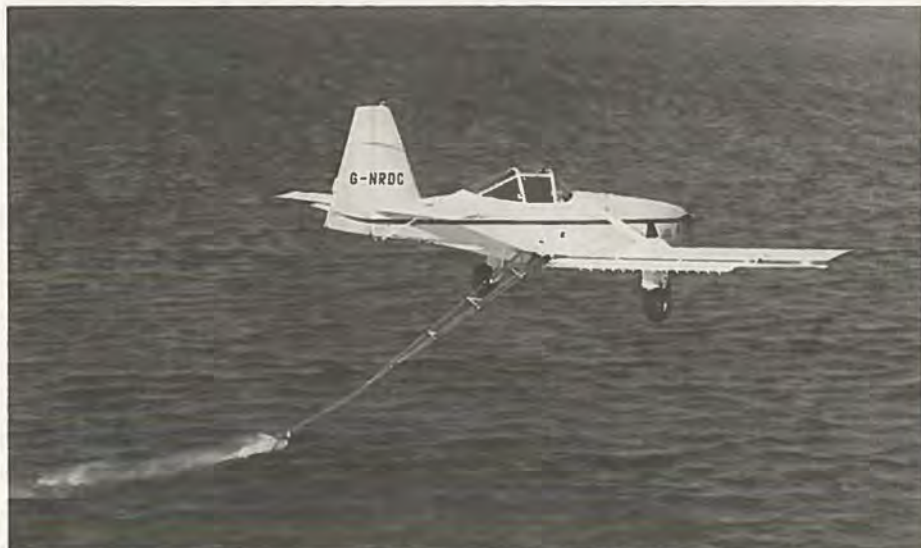
Sådan fisker man to tons vand på på under et minut med en NDN 6 Fieldmaster. Det kastes igen på få sekunder over en brand.
