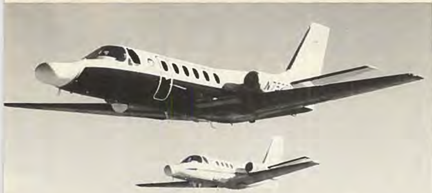
mærkelige snude på disse Citation II skyldes radar og infrarødt-udstyr, hvormed man i jager narkotika-smuglere på land, til vands og i luften.
