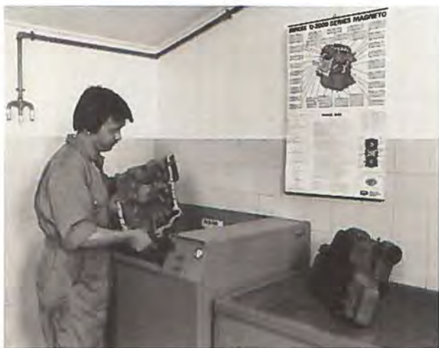
Før dye-check og magnaflux foretages en grundig rensning og affedtning af samtlige motordele.
