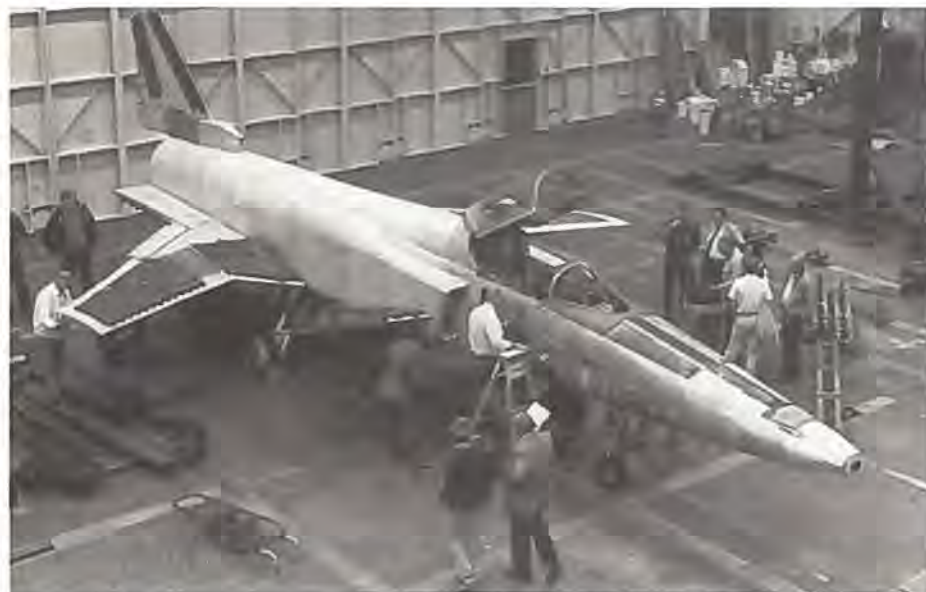
Grumman Aerospace's forsøgsfly 712 med negativ pilform på hovedvingen.
