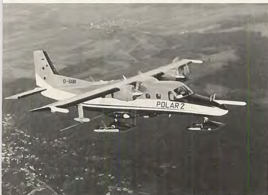
Dornier Do-228-100 har efter afprøvningen af sit skiunderstel i Grønland fungeret udmærket i Antarktis.
