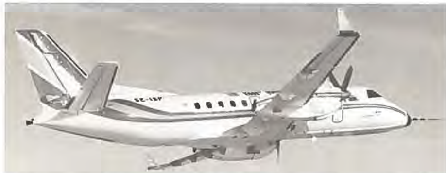
Saab-Fairchild 340 har forsøgsvis været udstyret med winglets. – Om resultatet foreligger ikke oplysninger. – Der flyver nu fire eksemplarer af SF-340, og produktionen er i fuld gang.
