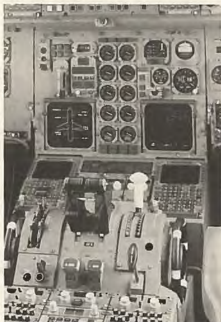
Udsnit af forsidebilledet med ECAM-billedskærmene og motorinstrumenterne mellem dem.
