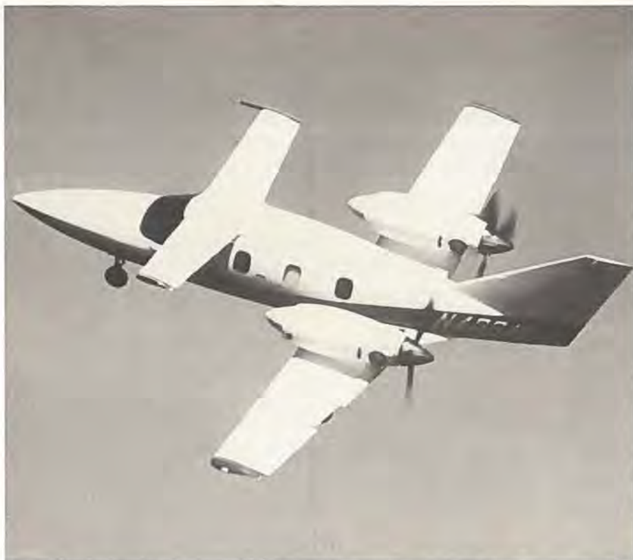
Avtek 400 er et andefly i kompositbygning. Forvingen sidder så langt tilbage, at man ikke kan kalde den næsevinge, hvorfor fabrikken betegner den som den øverste vinge – kært barn har mange navne.
