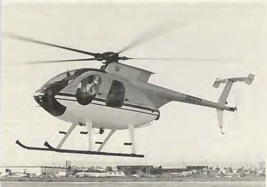
Den første Hughes 530F kendes fra sine forgængere på den ændrede næseform, men har også den nye motor og større halerotor.
