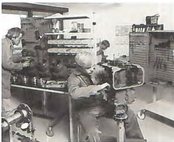
En dygtig stab af erfarne flyteknikere er ansvarlige for opsamling og montering af motoren og dens komponenter.
