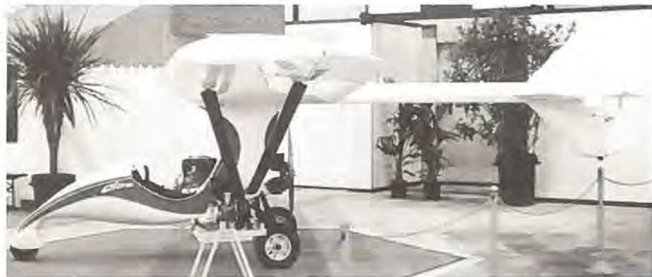
Hoffmann H 39 Diana er som ultralet i en helt anden udformning end »fugleburene« med masser af wirer til afstivning.
