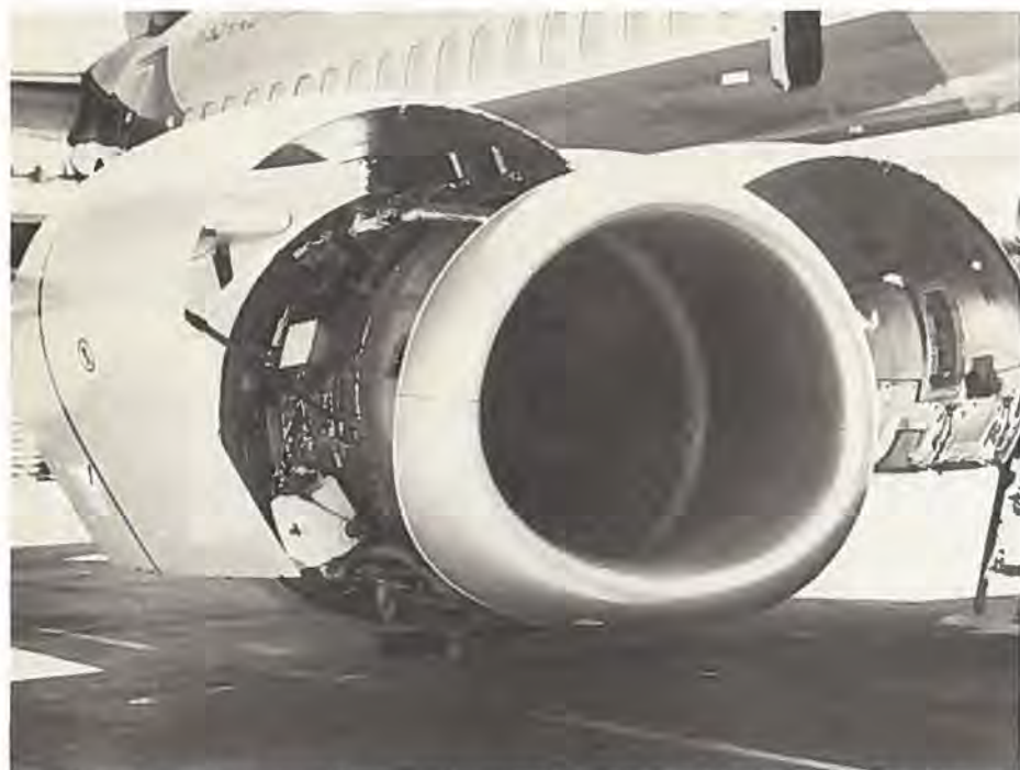
En karakteristisk form kendetegner indsgubningen til CFM56-3 motoren på Boeing 737-300, som Maersk Air har bestilt to af.
