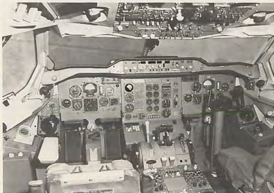
Airbus-cockpittet, hvor venstre styresøjle er erstattet af mini-pinden, som kaptajnen betjener med håndledsbevægelser med venstre hånd.
