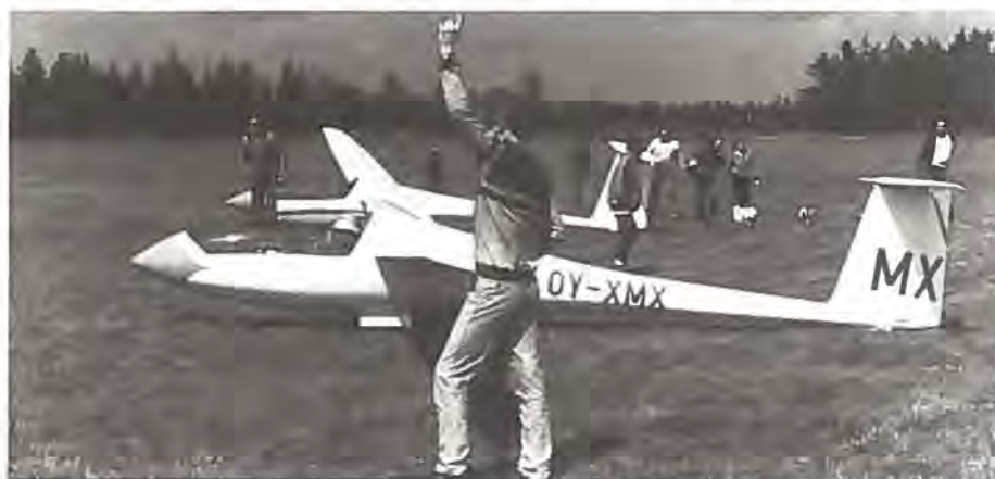
Flaps er hovedforskellen på flyene i 15 m klassen som denne Ventus og så standardklasseflyene.
