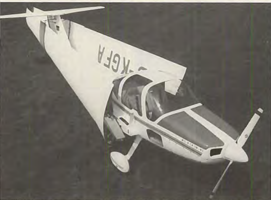
Grob 109B og flere andre typer er indrettet til at kunne sættes i hangar med vingerne opbetalt. Det koster vægt, men kan spare hangarleje.
