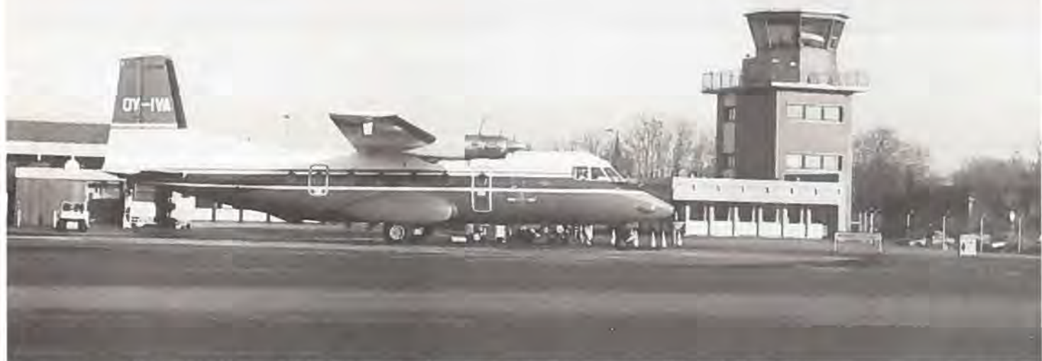
Luftfartsdirektoratets Nord 262A, der bruges til kalibrering af navigationshjælpemidler, foran Beldringes nuværende terminalbygning med tårn.
