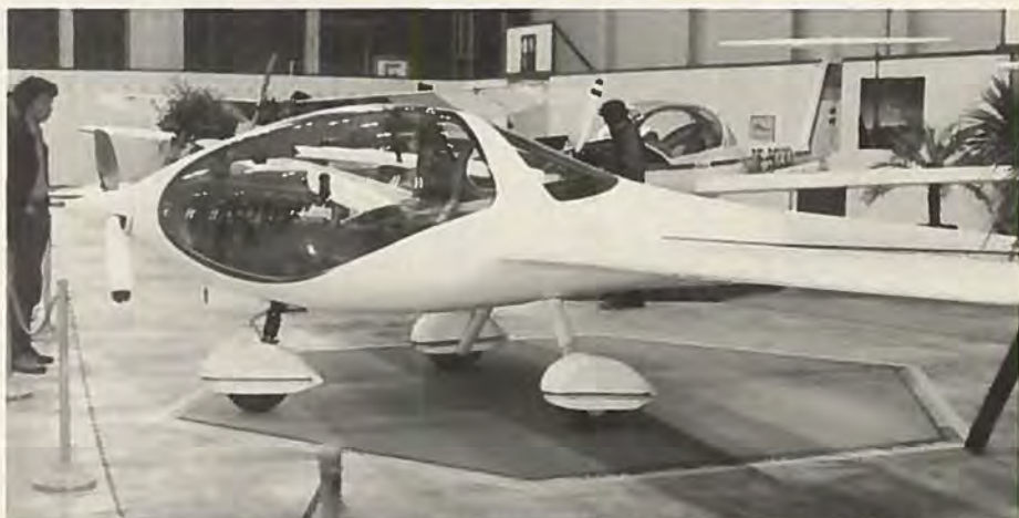
Attrap af Hoffmann H 38 Observer med motor bag kabinen og propellen drevet af en lang aksel gennem denne.
