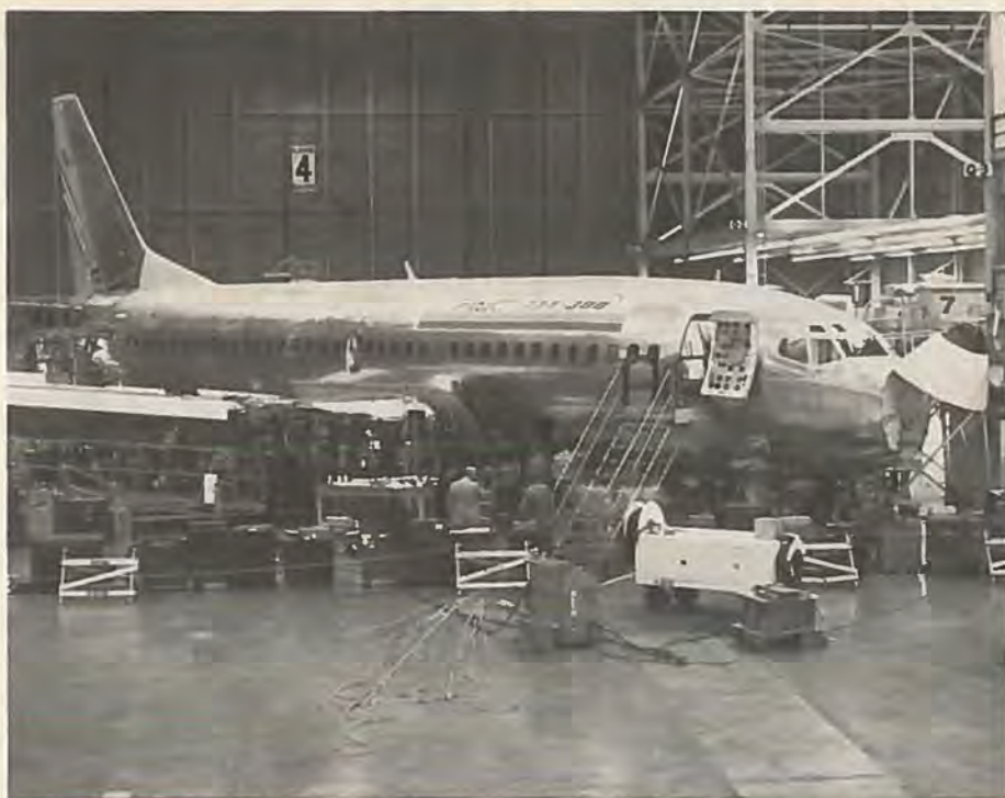
Den første Boeing 737-300 med ny motorer og længere krop til op til 149 passagerer.
