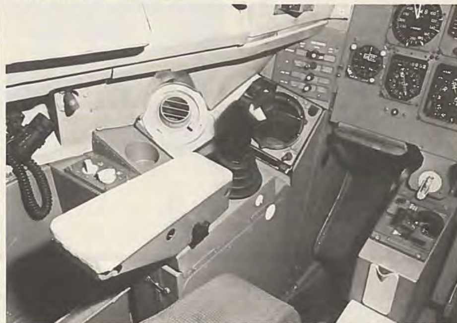
Nærbillede af pinden og armlænet. Ændringen vil kunne spare 20 kg, give bedre overblik over instrumenterne og forenklet vedligeholdelse.
