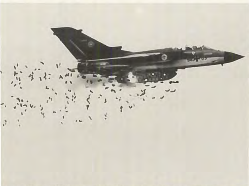
Tornado affyrer sit MW-1 system, der er beregnet mod tanks og flyvepladser.
