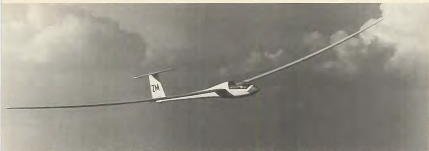
Schempp-Hirth's »flagskib« er Nimbus IIIB, der vandt VM i fjor, som dens forgængere har gjort i lang tid. Med op til 24½ m spændvidde medførende 290 kg vandballast (= 4 personers vægt!) har den formidable præstationer. (Foto: L. Sengbush)
