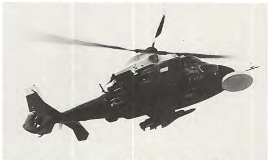
En SA 365F Dauphin 2 bevæbnet med fire AS 15TT missiler og Agrion 15 radar.
