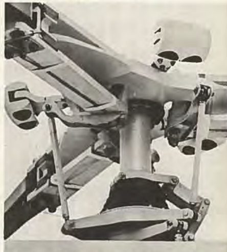
Starflex-rotorhovedet er lettere og enklere end tidligere systemer.
