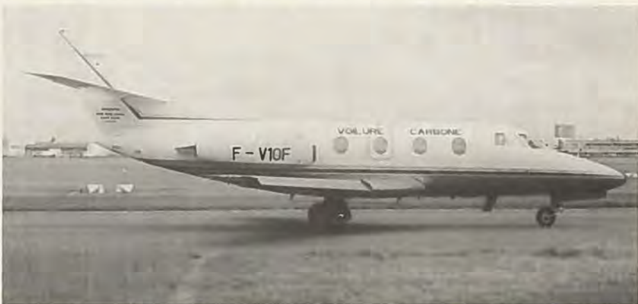
Dassault Falcon V 10F med kulfibervinge (voilure carbone). – Alle fotos: J. M. G. Gradidge.
