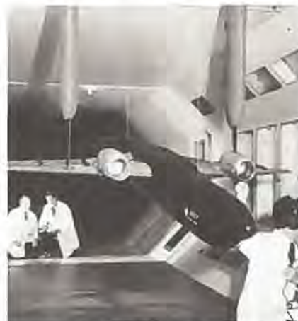
Airbus 320 i skala 1:13 i vindtunnel.
