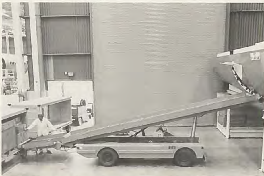
Automatiseret læsning af fragt i smalkroppede fly med énmands betjening.
