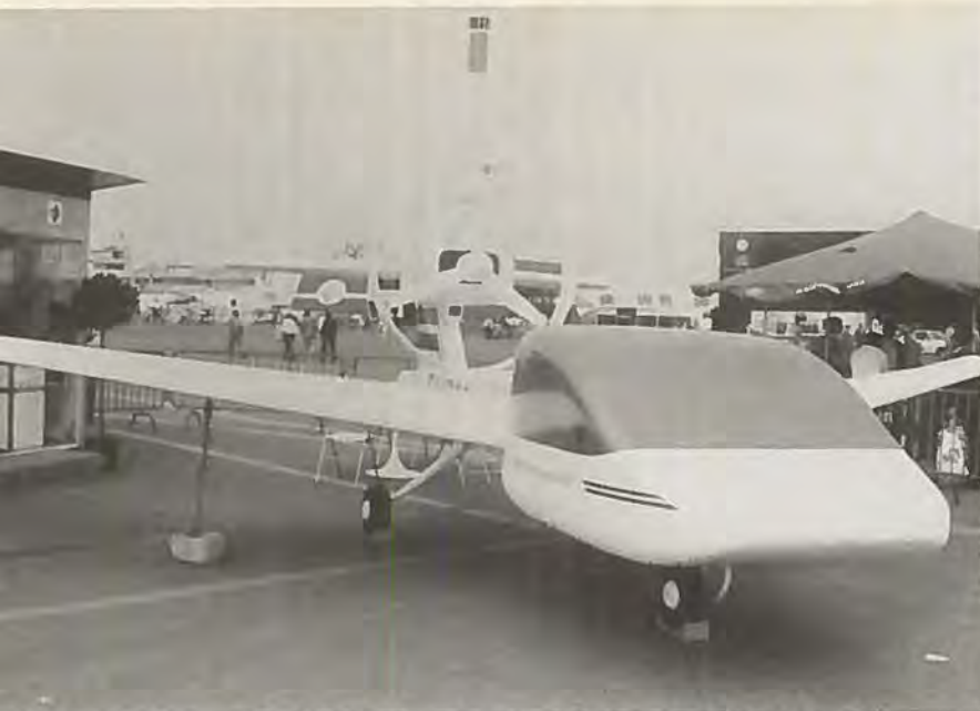
En tresædede Performance 2000 med motor og afskærmet propel på halefinnen.
