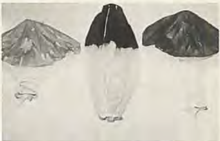
Ordinær pilotskærm i midten, flankeret af ny type »Magnum«, beregnet til lave faldhastigheder.
