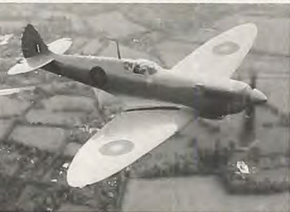
Spitfiren Cross of Lorraine, der blev gjort luftdygtig igen med dele fremstillet på 40 år gamle værktøjer.
