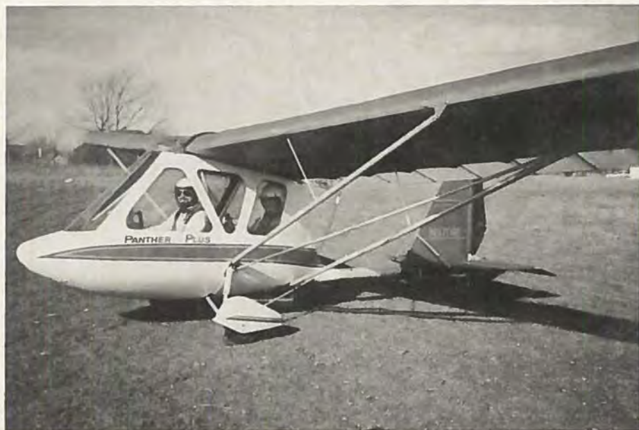
Den to-sædede Panther Plus 2 har fået en ekstra vingestræber.
