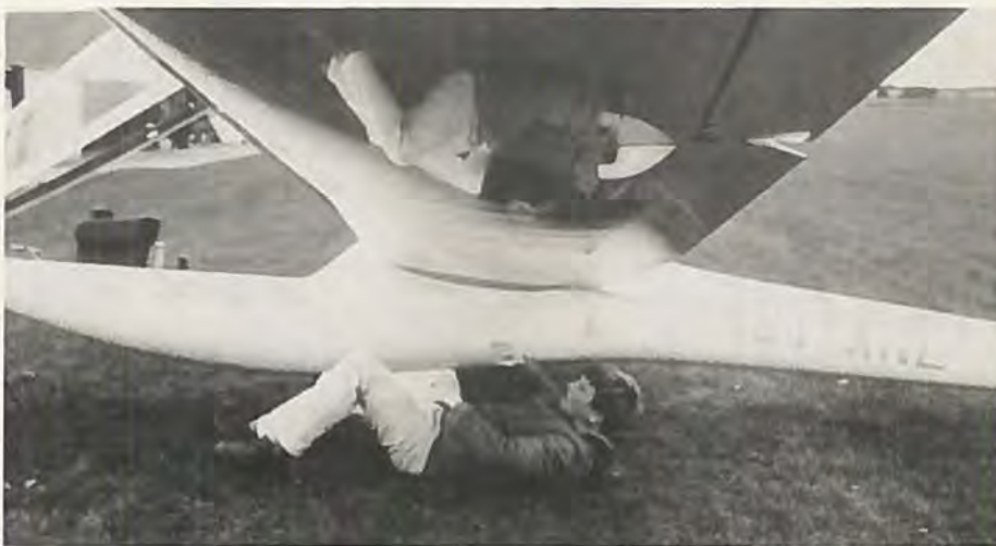
Vi ville egentlig have et billede af pitotindtagene og turbulatorhullerne. I stedet blev det en demonstration af, hvor glat og blank overfalden på en moderne svæveflyvinge er. Pitotindtaget ses dog også.
