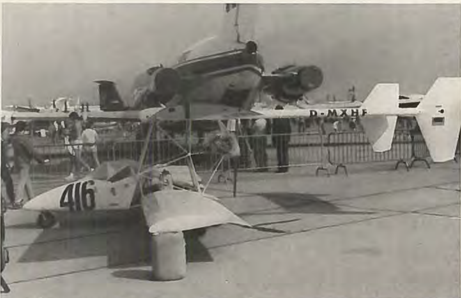
For den vægelsindede: Den vestberlinske Höhenflug Stratos ses her som biplan – men kan også monteres som højvinget monoplan. (Fotos: J. M. G. Gradidge).
