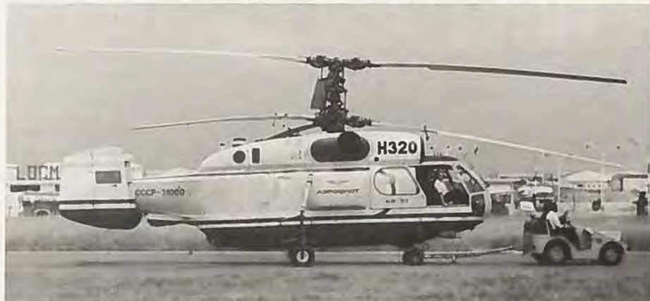
Kamov KA-32 med modsatrotterende rotor er en udvikling af Kamov Ka-27.
