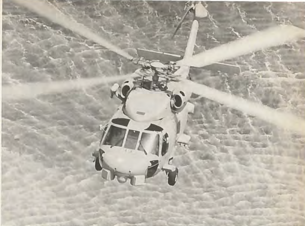
Sikorsky CV-HELO eller SH-60F er en særlig udgave af SH-60B Seahawk, beregnet til beskyttelse af flådens slaggrupper imod fjendtlige ubåde.
