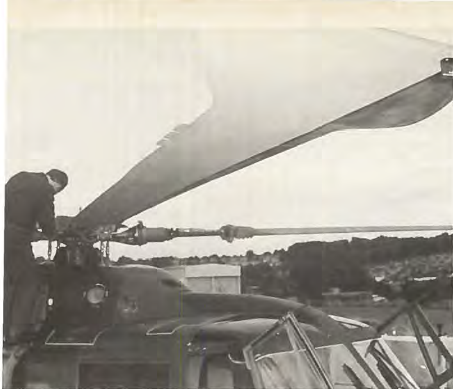
De besynderlige padleformede tipper på en Lynx. Mon de også nedsætter typens karakteristiske klaprende støj?
