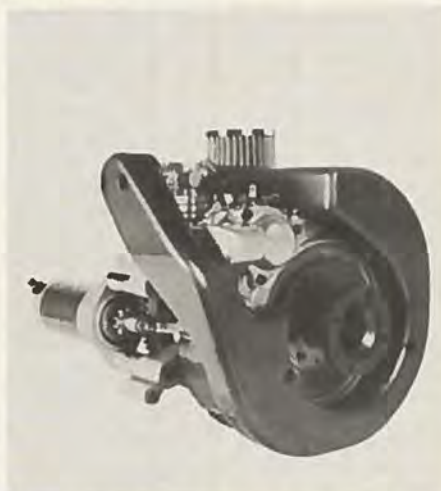
Dette og underste billede er modtaget, efter at artiklen er sat. Teledyne Continental Model R-18 herover er en enkeltrotor-motor på 30-40 hk ved max. 7500 omdr./min, beregnet til fjernstyrede småfly. Der er færre bevægelige dele end i en stempelmotor og dermed mindre vibration.
