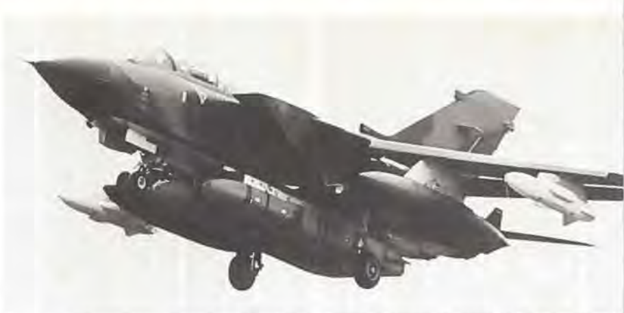
Tornado i IDS-versionen læsset med to anti-flyvepladssystemer, to ekstra tanke og yderst to beholdere med elektroniske modforholdsudstyr.
