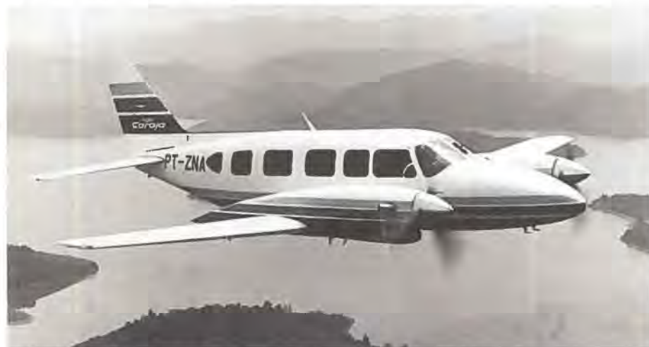
N-821 Carajá er en Piper Navajo Chieftain forsynet med turbinemotorer.
