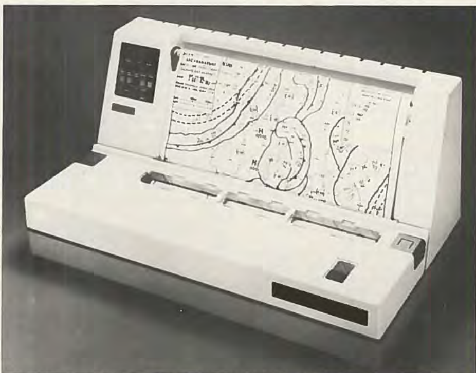
Mufax 949 er en ny facsimile-modtager af vejrkort fra Muirhead Data Communications Ltd. Det kan modtage enten pr. radio eller pr. ledning og kan også indrettes til at modtage satellitfotos.
