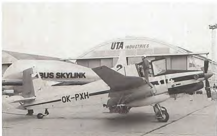
Humblebi med turbinemotor. Det tjekkiske landbrugsfly Z-37 er blevet moderniseret med ny motor og mange andre forbedringer.
