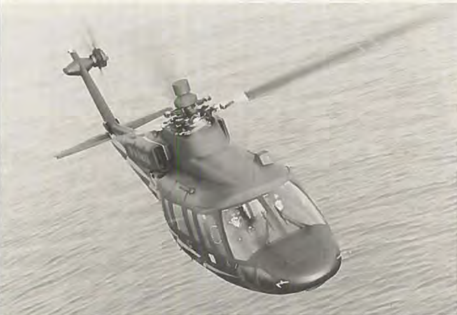
Sikorsky H-76Eagle med to Pratt & Whitney Canada PT6B-36 turbinemotorer.
