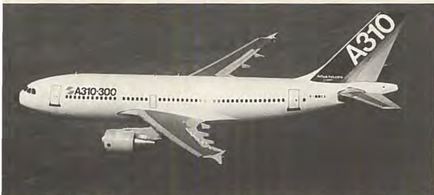
Bus A310-300 fløj 47 timer på sine 12 første prøvflyvninger. Bemærk de små vinglets.
