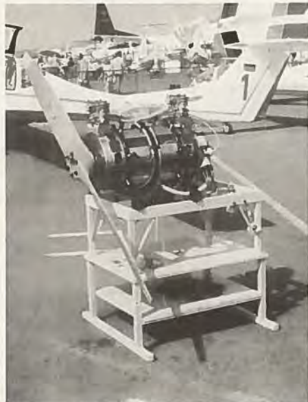
Endnu en ny flyvemotor blev vist i Paris: Mayer-Huf-motoren. Den vejer 85 kg og skal kunne yde 360 hk ved 5000 omdr./min.! Det er en firtaktsmotor med et minimum af bevægelige dele i 14 cylindre og derfor meget vibrationsfri. Brændstofforbruget med normalbenzin er 180-190 g/hk/t, og i dieseludførelse kun 150-160.
