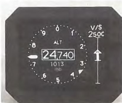
— og her er 2187 med visning som højdemåler og variometer.
