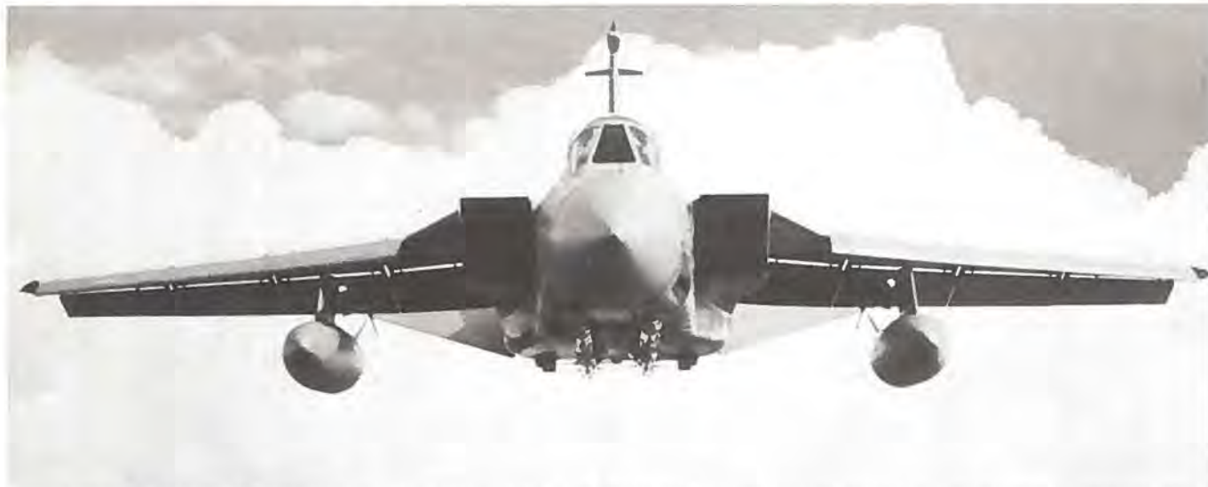
Tornado ADV (F.2) med 4 Sky Flash missiler, 2 Sidewinders og to faldtanke - hængende i langsomflyvning bag fotografens Hercules.
