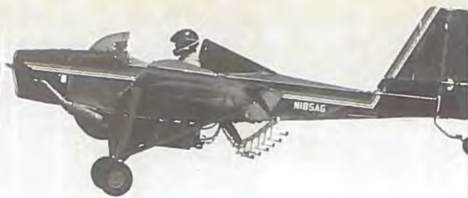
Til venstre Earthstar Ultra Gull, til højre Hutchinson AG Master, et landbrugsfly med 52 hk og 75 liter væske.
