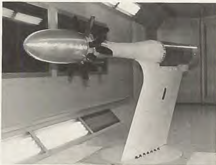
General Electric unducted fan som 2 fods vindkanalmodel.
