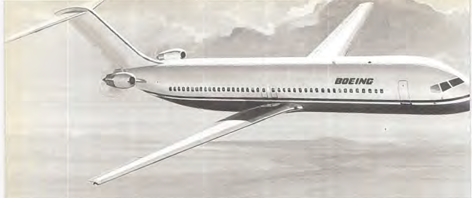
Et Boeing-projekt med turbinemotorer, der drive modsatrettede propeller. Et andet projekt viser udformning som andefly.
