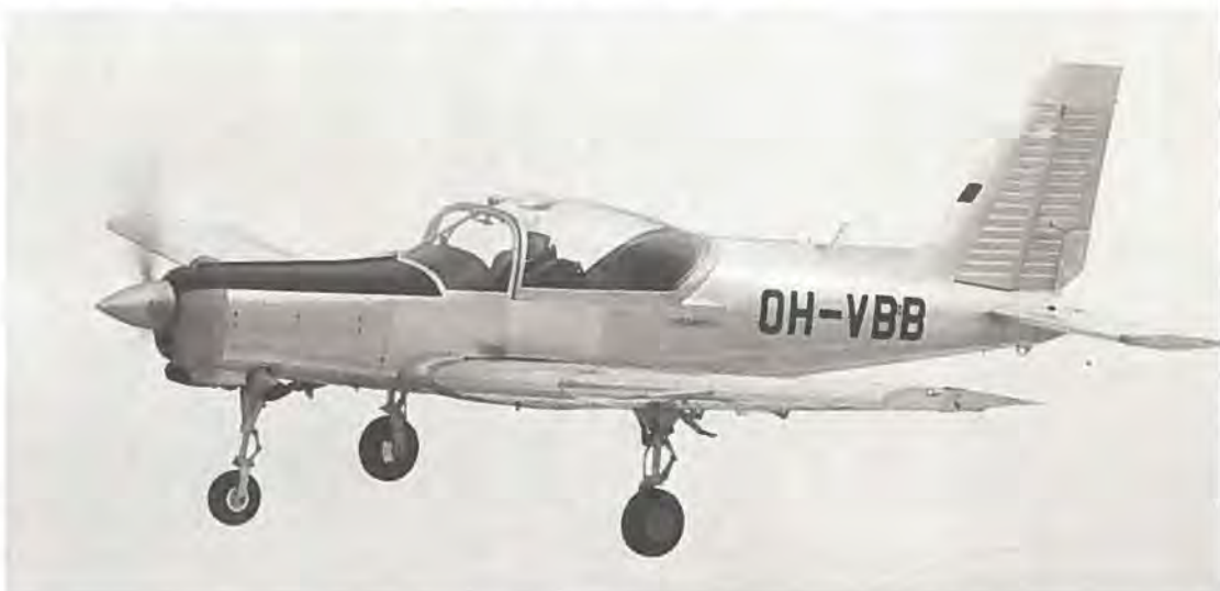
Valmet L80TP, udviklet fra L70 Vinka, men med turbinemotor, større vingebredde og optrækkeligt understel
