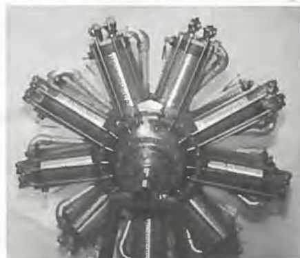
150 hk Bentley (engelsk fremstillet og forbedret kopi af Clerget).
