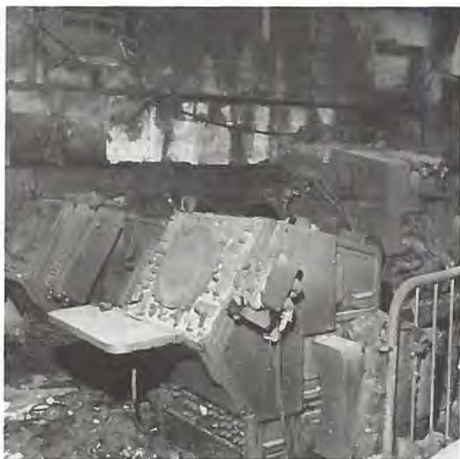
Til venstre ses de sørgelige rester af IC radarkonsollerne efter branden i januar 1965.
