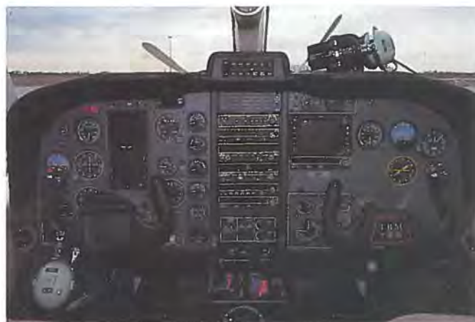
TBM 700 instrumentbrættet. De to mørke felter i venstre side er EFIS-instrumenteringen. Skærmene lyser op, når systemet tændes. I højre side er det mørke felt farvevejrradaren.
