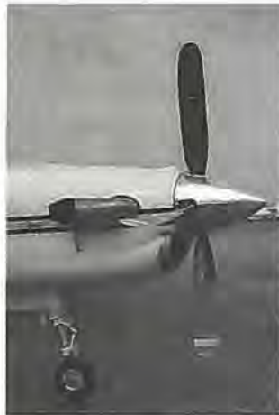
TBM 700's motor er en Pratt & Whitney Canada PT6A-64 turboprop motor, og det er i væsentlig grad den, der gør forskellen.
