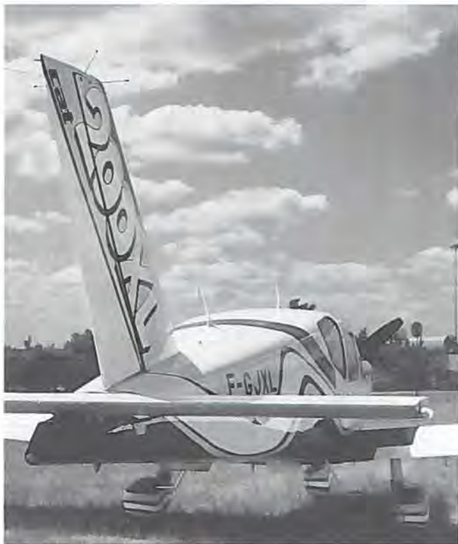
Placeringen af halefinne og haleplan er karakteristisk for TB-serien. Haleplanet fungerer i sin helhed som højderor, og hele bagkanten udgør højderorstrimmet.
