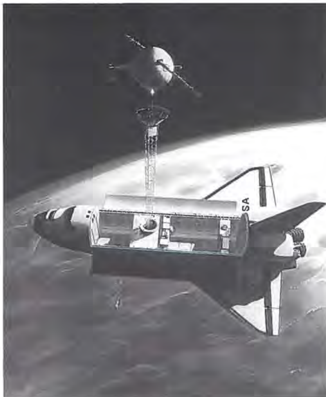
Det italienske yo-yo forsøg skal lave elektricitet til de kommende rumstationer
