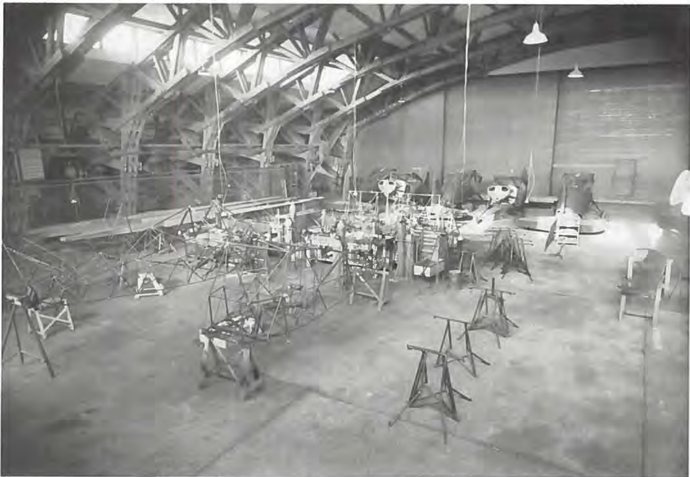
Færdigsvejsning af fuselagelag. Bemærk motorfundamentene i forgrunden. Til højre et højderør og bagtil de første fly under montage. Helt til venstre et sæt nye vinger til FLS vindmølle i Gedser.
