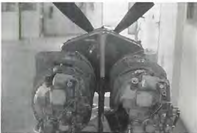
Mockup af PT6 Twin Pack systemet til C208 Caravan.
