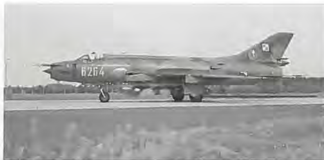
Su-20E Fitter-C fra 7 PLM-B med stor foto-recce pod under kroppen.
