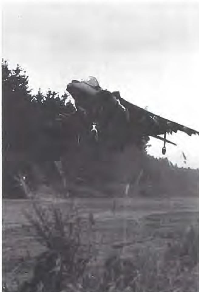
Med et brøl passerer denne Harrier GR Mk 7 forbi fotografen. Starten fandt sted fra det man kalder Minimum Operating Strip (en meget kort startbane). Den uklare del af billedet under flyet skyldes dels udstødningen, dels skidt og møg, der presses ud til alle side.
