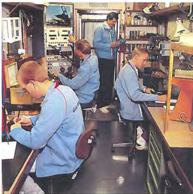
Kalibrering af mekanisk måleudstyr i et af Danish Aerotech's seks mobile kalibreringsværksteder.
