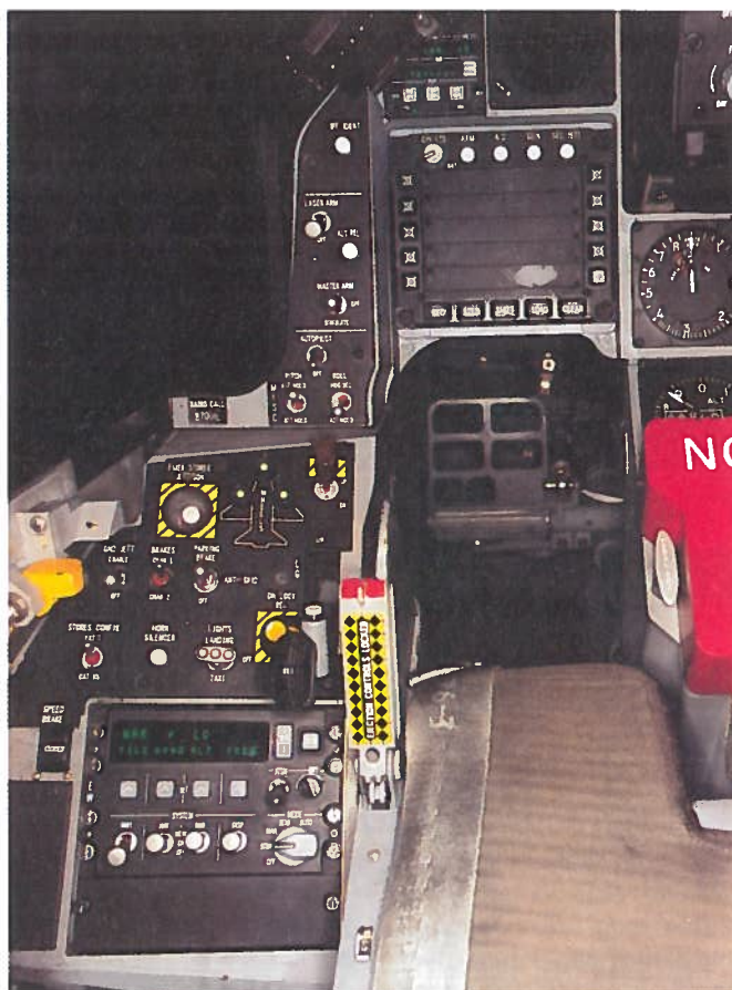
TERMA's EW Management System samler informationerne til piloten i to paneler: EW Prime Indicator (trekanten i midten øverst) og EW management unit (for neden til venstre).
