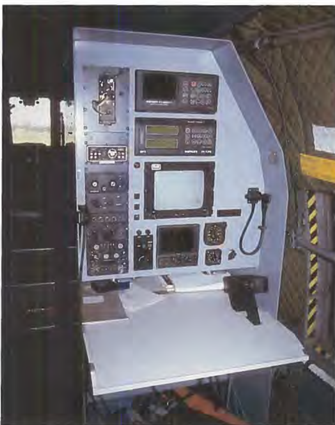
Radiooperatørens nye position i S-61 med FLIR-displayet i midten.
