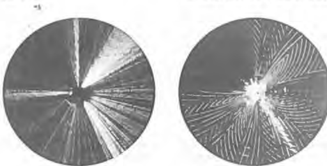
De to billeder viser, hvordan anvendelse af jammerpods kan påvirke en søgeradar. I begge tilfælde er der tale om en let jamming, hvor man godt kan skelne ekkoer fra fly igennem.
