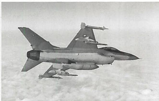
Prøveflyvning med Pylon/ Launcher Adapter. Adapteren prøveflyves både med og uden missiler ophængt.
