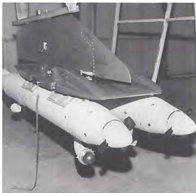
En ALQ-72 og en -71 ophængt sammen på en F-104 dobbeltbombebærer. Forrest i begge pods sidder en generator, som drives af fartvinden. De er derfor ikke afhængige af strømforsyning fra det bærende fly.
