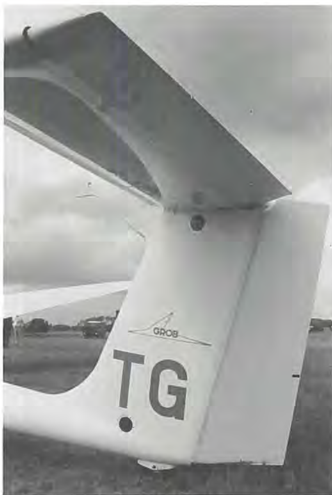
Twin III halen, hvor der i halefinnen findes to inspektionshuller. Zig-zag tapen på haleplanen kan også anes.
