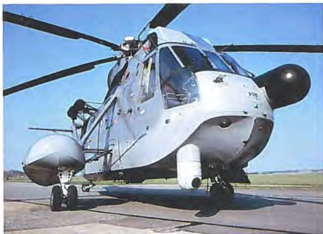
U-278 på Værløse. Bemærk, at FLIR'ens sensor er synlig. Den kan også køres ind i pod'en for beskyttelse.
