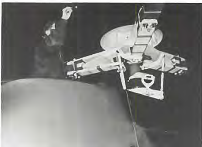
JOR i færd med at gennemføre sit Walk Around Check. Her er det hovedrotoren, der inspiceres.
